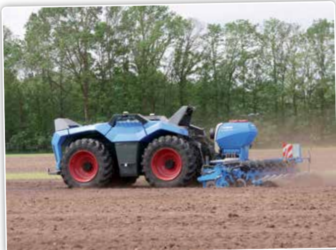
De VTE van Lemken trekt hier een achtrijige Azurit 10-zaaimachine.
