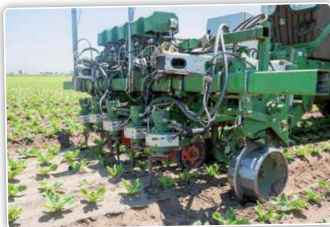
Semi-autonome machines voor onkruidbestrijding zijn al zo ontwikkeld dat ze het tussenliggende plantgebied onkruidvrij houden.
