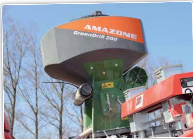
Boven op de Miedema CP 42 staat prominent een Amazone GreenDrill 200 waarmee granulaat gegeven wordt.
