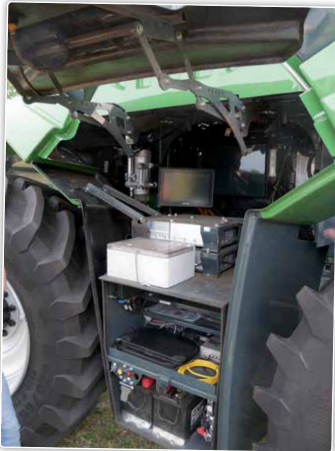
Het voertuig is met 20 elektronische stuureenheden uitgerust.
