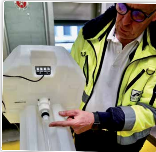
De aparte tank voor water en pesticiden. De kleine dronebus van 18 liter wordt pas op de plaats van gebruik gevuld met behulp van dit systeem en aangesloten op de drone.
