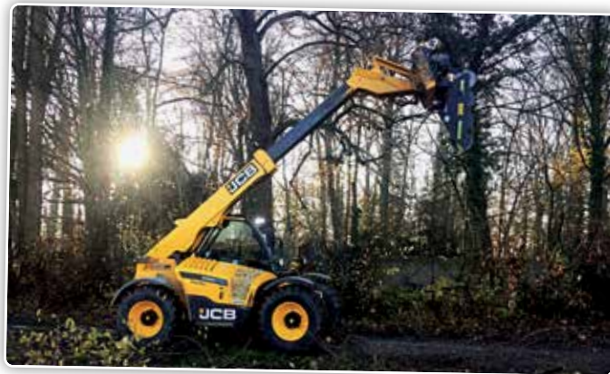
De verreiker is uitgerust met een snoeiblad dat het mogelijk maakt om de randen van paden en percelen te onderhouden.
