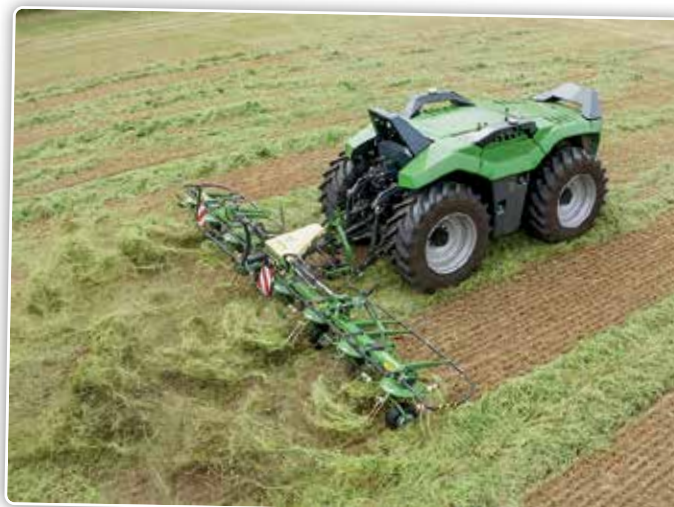
Uitgerust met een 8,2 meter brede schudder heeft deze VTE autonoom het gras van een versgemaaid perceel geschud.
