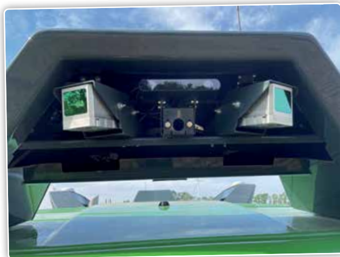
Op de voor- en achterkant staan telkens een stereocamera, twee LiDARs en een gewone camera.
