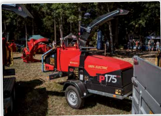
'We hebben een grote nieuwigheid bij Linddana met de tweede generatie van de 100% elektrische versnipperaars, de TP 175 Mobile Zero Emission.
