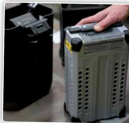
De batterij opladen duurt maar 11 minuten omdat ze in een waterbad (links) staat en daardoor niet kan oververhitten.
