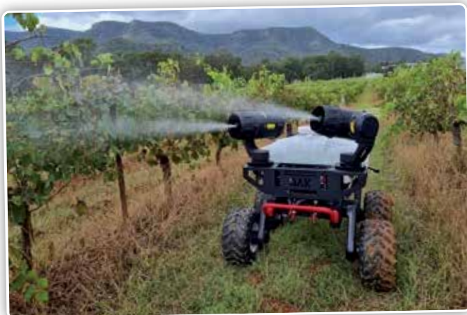
De Rover 150 is eigenlijk niets anders dan de bodemvariant van de V40, uitgerust met het JetSprayer-systeem. Hij kan ook ingezet worden als transportmiddel voor lasten tot 150 kg.
