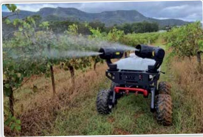
*Le Rover 150 n'est en fait rien d'autre que la variante terrestre du drone V40. Il est équipé du système JetSprayer. Il peut aussi être utilisé comme moyen de transport pour des charges allant jusqu'à 150 kg.*
