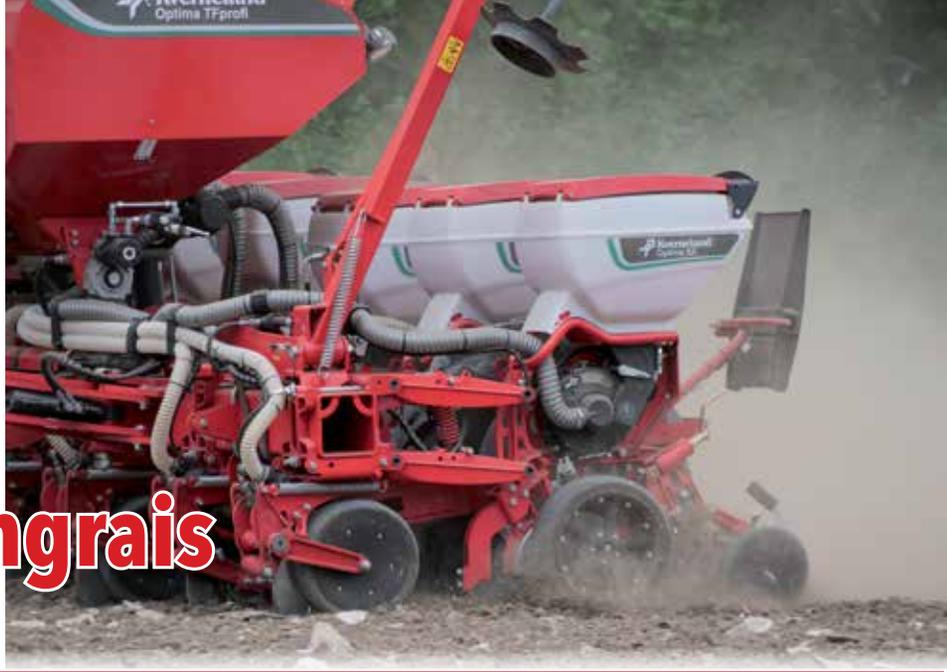
Récemment, Kverneland a présenté la technologie Pudama pour déposer de l'engrais de manière ciblée lors du semis de maïs. Il permet de semer le maïs avec précision avec une application spécifique d'engrais de type starter exactement en-dessous de la semence de maïs, et donc précisément où c'est nécessaire. Compte tenu des prix actuels des engrais, cette technologie mérite certainement que l'on s'y intéresse.
