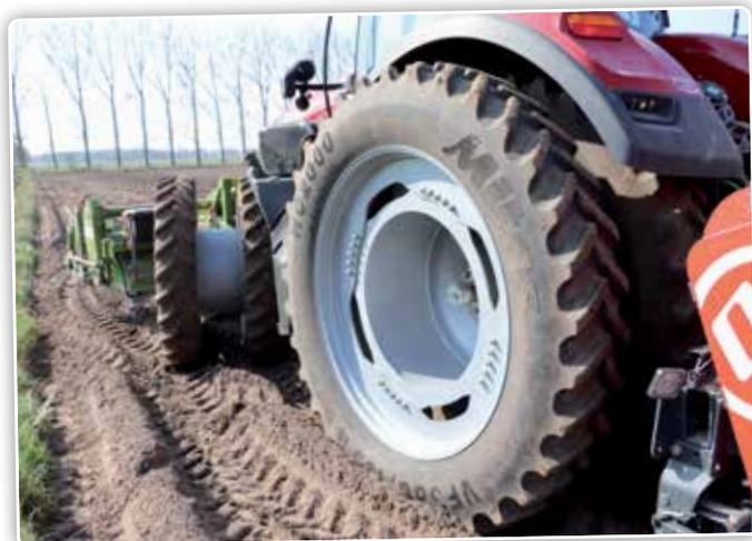
*Comme les clients ne voyaient pas l'avantage d'un système de télégonflage des pneumatiques, l'entreprise ne recourt plus à ce système. Cependant, il y a quelques années, ils ont décidé de recourir à des pneus de plus grandes dimensions, ainsi qu'à des jumelages.*
