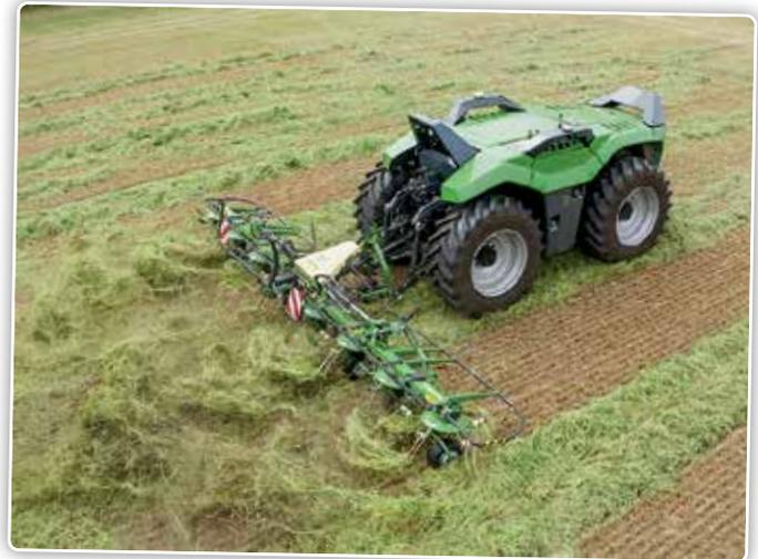
En combinaison avec une faneuse de 8,2 m de large, ce VTE fanait de manière autonome l'herbe d'une parcelle fraîchement fauchée.
