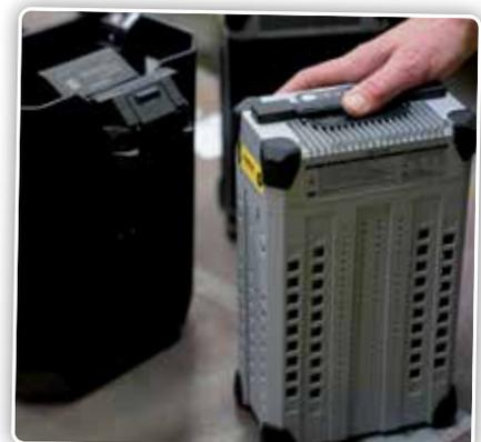
La batterie est chargée en seulement 11 minutes, grâce au recours à un bain d'eau (à gauche) qui empêche les échauffements trop importants.
