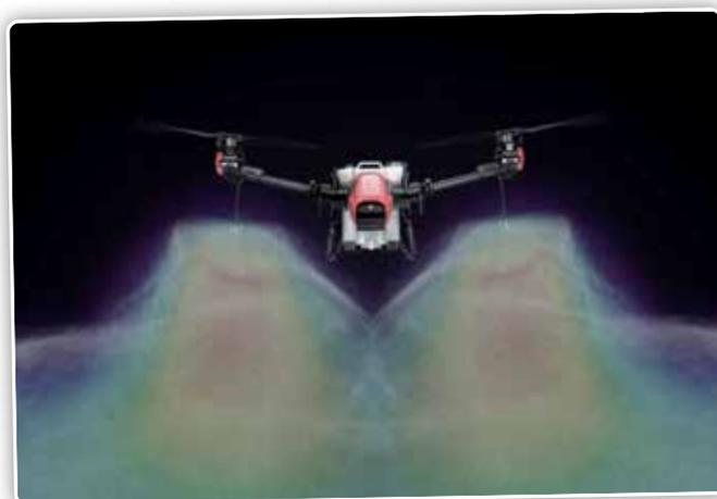
Le flux d'air à grande vitesse pulvérise la substance active en gouttelettes microscopiques directement sur les plantes, assurant une couverture élevée.
