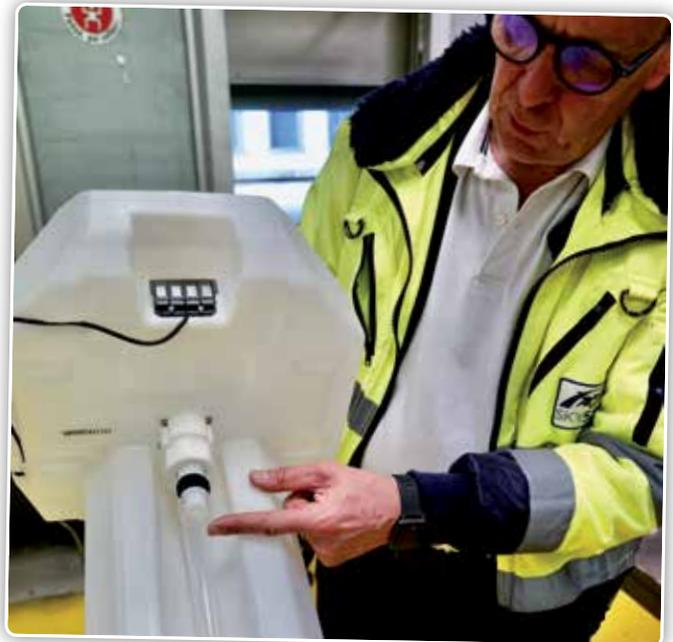
Le réservoir séparé pour l'eau et les pesticides. Ce système permet de remplir le petit bidon de 18 litres du drone uniquement au point d'utilisation et de le connecter au drone.
