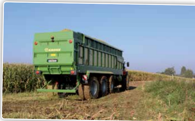
De bodemvrijheid van 70 cm is ruim bemeten, net als de brede banden.
