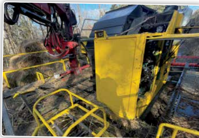
Zodra het onderste niveau gevuld is met balen, stapelt de chauffeur de andere balen met een Palfinger Epsilon E 5.70-kraan op de bovenste 'verdieping'.
