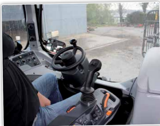
Voor bosbouwwerkzaamheden is een omkeerbare stuurpost een troef.
