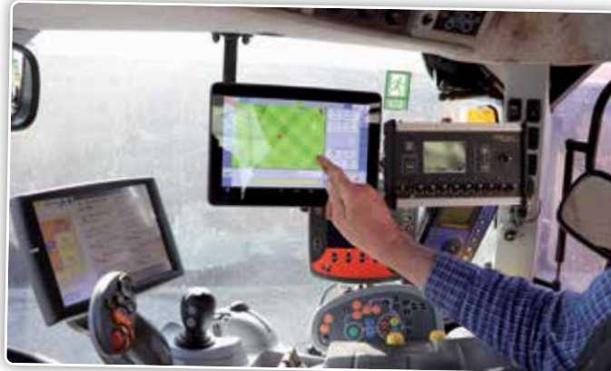
Ze werken al sinds 2018 met rtk-gps. Arthur: 'Gewoonweg zodat wij precisielandbouw kunnen toepassen. Ook kunnen wij sindsdien sectieafsluiting toepassen per sectie bij onze Delvano-spuitmachine en -maïszaaier.'
