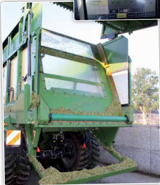
Een sterke gewezen band, twee trekkettingen en de transparante voorwand vormen de losseheid van deze wagen.
