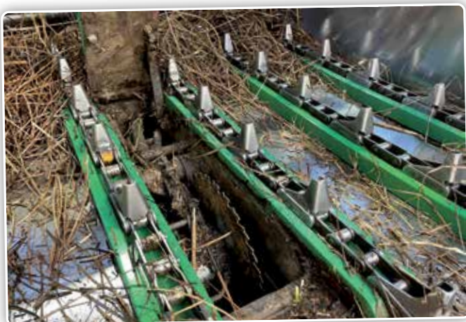
Op verzoek kan de chauffeur de cirkelzaag aan het begin van de baalvorming uitzwenken om de baal tijdens het hele persproces in twee cilinders van gelijke grootte te verdelen.
