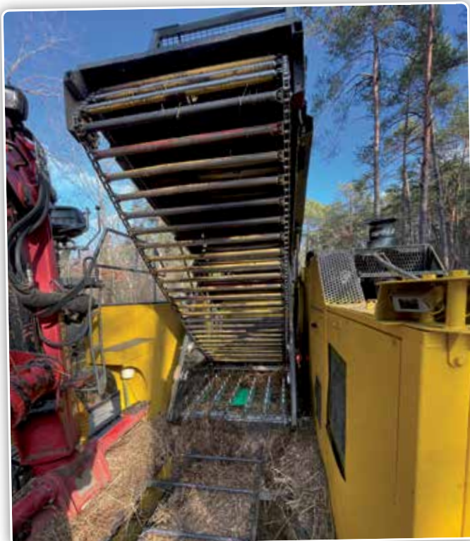
De perskamer (hier met open deur) zit direct achter de cabine.
