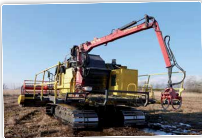
De machine weegt in totaal 19 ton en zit gemonteerd op de bovenwagen van een rupsgraafmachine met brede rupsen.
