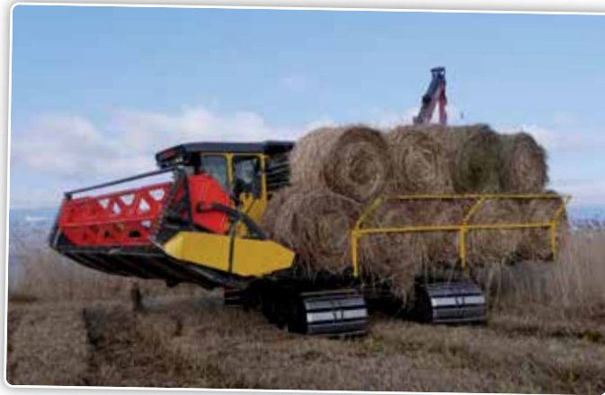
Op het niet-draagkrachtige moerasland kan de machine in enkele seconden van werkrichting veranderen zonder schade aan de ondergrond. Gewoon door de bovenwagen met 180° te draaien.
