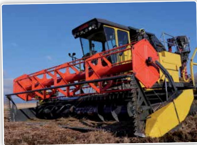
De snij-eenheid is vergelijkbaar met die van een conventionele maaidorser.
