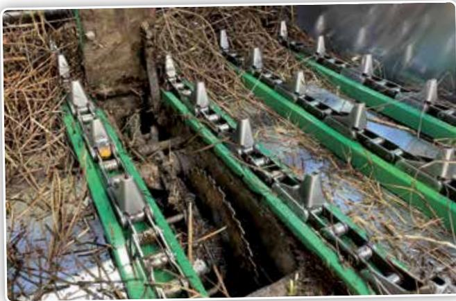
La chambre de pressage a une particularité: il y a une petite scie circulaire au bas de la chambre. A la demande du client, le conducteur peut activer la scie circulaire au début de la formation de la balle pour diviser la balle en deux cylindres de taille égale pendant tout le processus de pressage.
