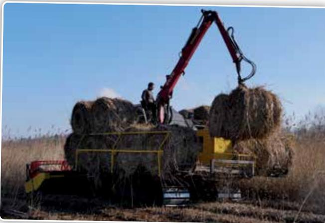
Au total, la machine peut transporter jusqu'à 22 balles rondes.
