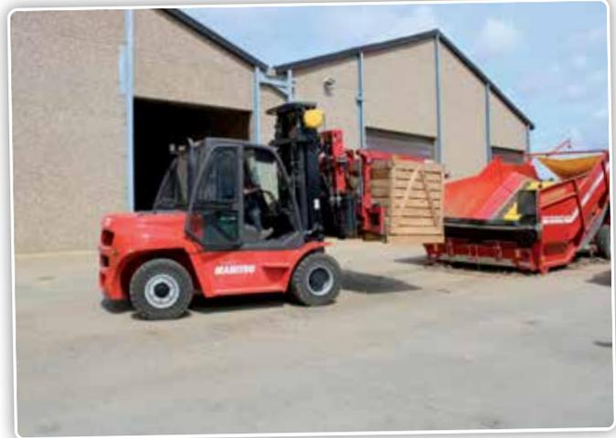
*Les deux chariots élévateurs sont principalement utilisés pour déplacer des palloxe.*
