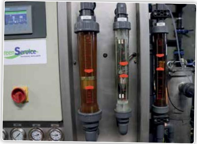
A droite, le flux entrant, au milieu l'eau filtrée et à gauche le concentré de minéraux
