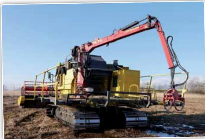
La machine pèse un total de 19 tonnes et est montée sur le chariot supérieur d'une pelle sur chenilles à larges chenilles.
