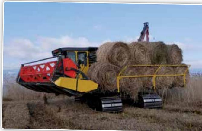
Dans les marais peu portants, la machine peut changer de direction de travail en quelques secondes sans endommager le sous-sol. Simplement en tournant le chariot supérieur de 180°.
