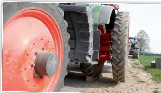
Om de wielen te verstellen moet het buitenste wiel worden ontlast.
