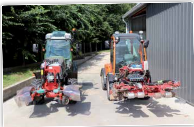
Op de foto beide versies van de dubbelzijdige modellen van de Ladurner, de Krümler 7F en de versie met lintenmaaierunits erop.
