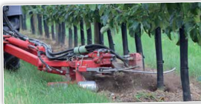
Er zitten twee tasters op iedere unit. De voorste, korte taster is de veiligheidstaster. De achterste, lange taster is de boomvolgende taster.
