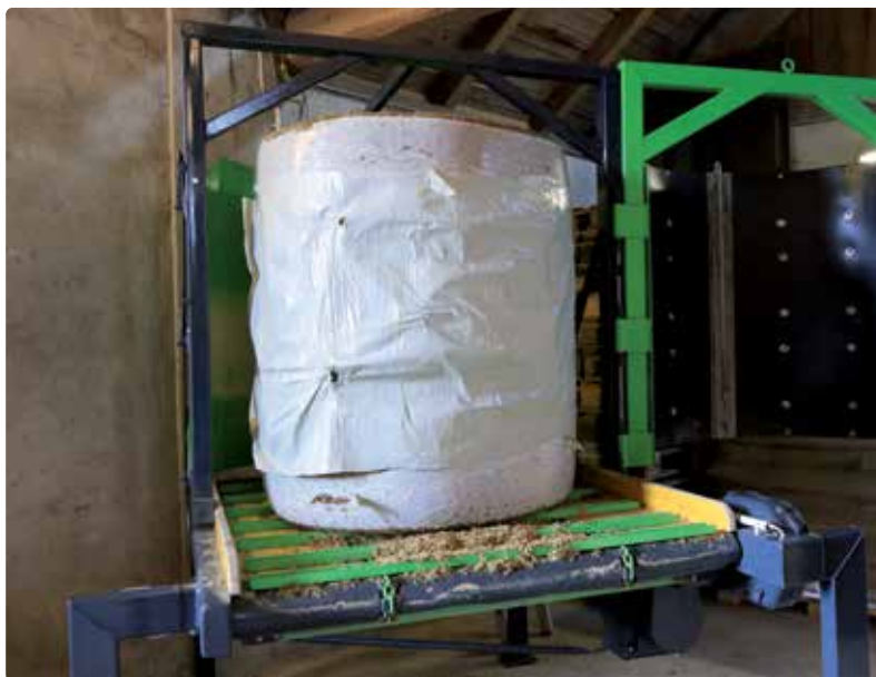
Een blik aan de binnenkant: nagels houden de folie stevig vast terwijl de transportbodem de baal langs onder 'uitfreest'.
