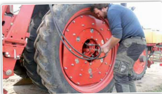
Het geheel wordt in- en uitgeschoven via een hydraulisch ventiel op de trekker.
