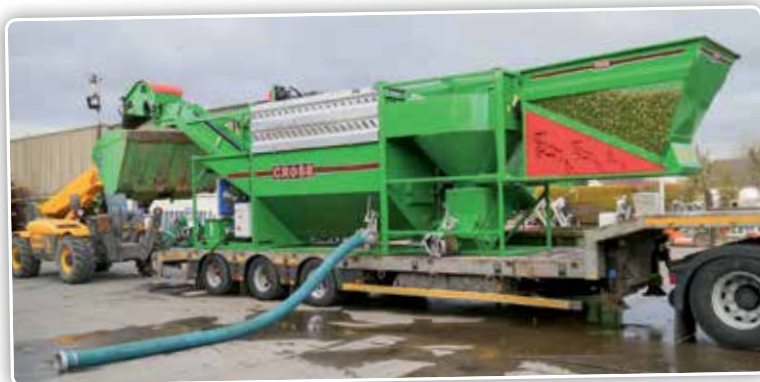
Cross bouwt machines om bieten te wassen, te ontstenen en te snijden.
