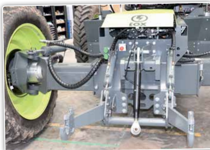
Op ieder wiel zit een elektrische wielmotor van nominaal 20 kW en maximaal 40 kW.
