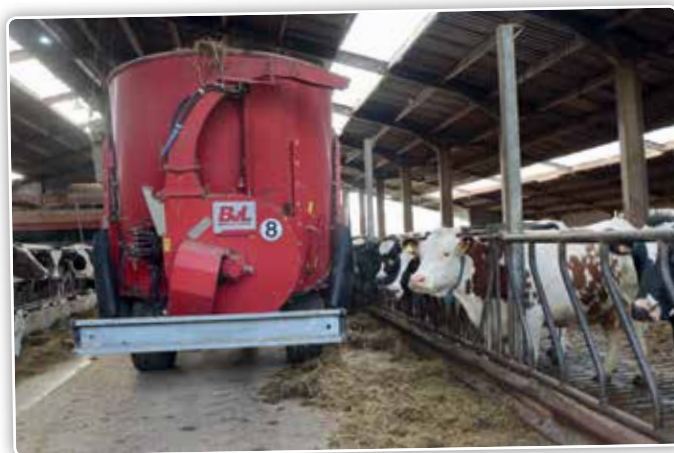
Jonathan investeerde in een mengwagen met stroblazer om de fysieke arbeid te beperken.
