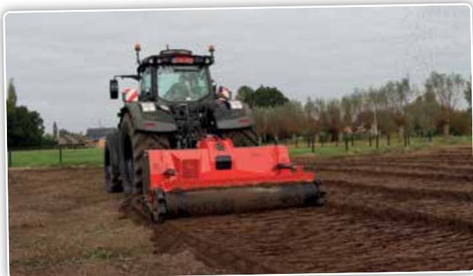
De Prinoth-diepfrees verkleint ondergrondse wortels en wortelresten en werkt ze in de bodem in.
