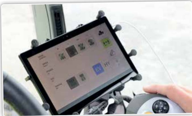
Onder meer de 4 wielstanden van de EOX-175 zijn via het digitale beeldscherm in te stellen.
