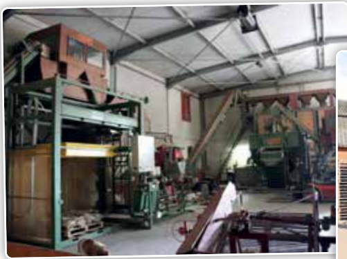
Sorteren doen ze hier met een Schouten-sorteermachine en verpakken met een Visser-verpakkingsmachine. Het pootgoed wordt keurig verpakt voor de export in zakken van 10, 25 en 50 kilo of in bigbags.
