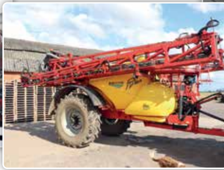
Een recente investering is een Beyne Python-spuitmachine van 40 meter met 4.200l-vat uit 2017.
