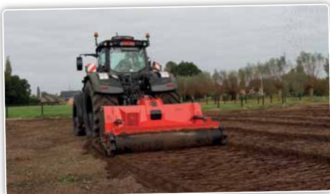
La fraise Prinoth permet de broyer les racines et restes de plantes et de les enfouir dans le sol.
