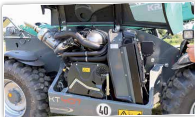
Kramer koos voor de Deutz TCD 3621-motor om aan de Stage V-emissienorm te voldoen.
