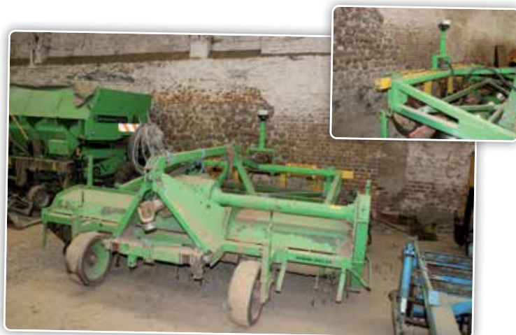
De rijenfrees van AVR wordt gebruikt om ruggen te trekken voor wortelen en pastinaak. De sturing op de frees zorgt voor een hogere nauwkeurigheid.
