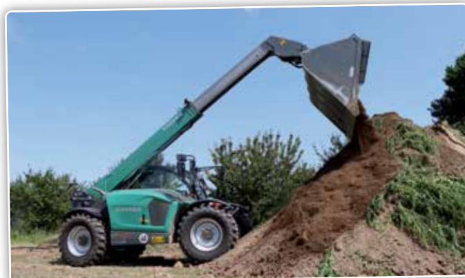
Met een bak die leeg circa 900 kg weegt en een inhoud van ongeveer 2.500 liter heeft, zaten we ruim boven de 4 ton lading.
