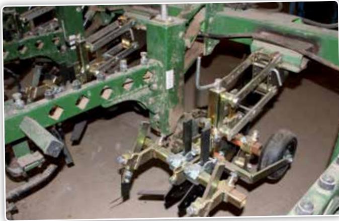
Jean-Pol Tellier bouwde zelf een bestaande schoffelmachine om zodat teelten op ruggen ook optimaal geschouffeld worden.
