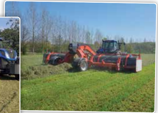
In 2020 werd een bandhark gekocht. Daarmee kan tussen 5 en 8 ha per uur worden geharkt.
