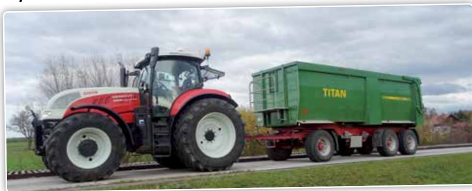
Hoer groter (en zwaarder) de 'oude' aanhangwagen is, des te groter is het risico op gevaarlijke rijsituaties met de 'nieuwe' trekker (testteam 3).
