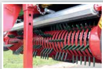
Flexibele tanden van de pick-up
