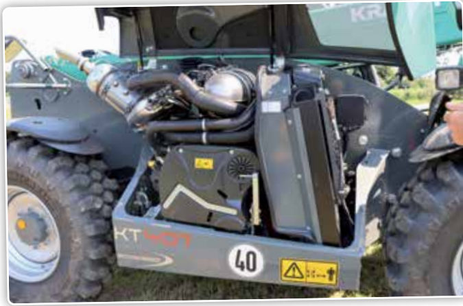
Kramer a opté pour un moteur Deutz TCD 3621 afin de répondre aux normes Stage V.
