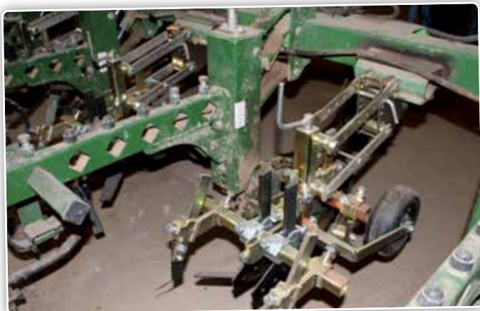
Jean-Pol Tellier a transformé lui-même une bineuse existante afin de pouvoir biner efficacement ses cultures sur buttes.
