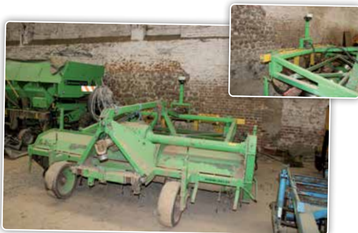
La fraise butteuse AVR est utilisée pour former les buttes pour les carottes et les panais. Grâce au récepteur sur la fraise, la précision de travail est encore plus grande.
