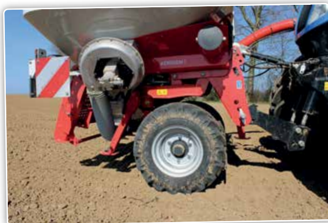
De fronttank kan worden uitgerust met een bandenpacker. De verdeling wordt vooraan geplaatst.
