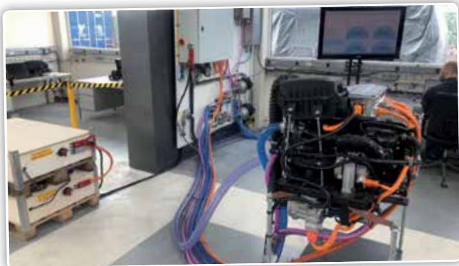
De Hyundai-brandstofcel zorgt voor de aandrijving.
