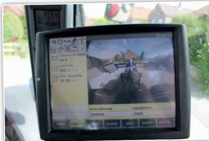
De camera vooraan, die automatisch ingeschakeld wordt in combinatie met de richtingaanwijzers, zorgt voor een hogere veiligheidsgraad en geeft rust.
