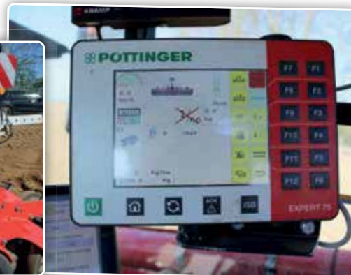
De combinatie wordt volledig via Isobus beheerd.
