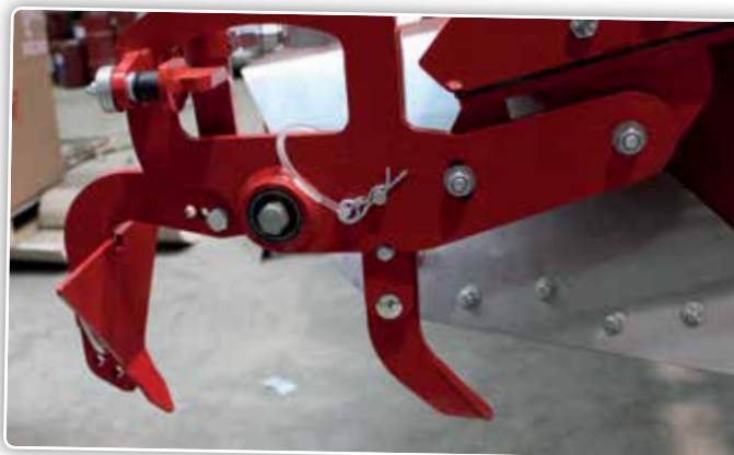
Opbouw van een voorziening om drempeltjes te maken en erosie te voorkomen tussen de aardappelluggen.
