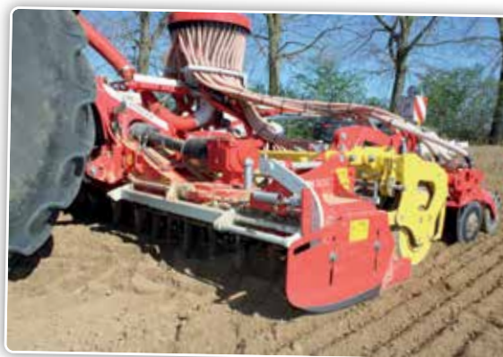
Een van de innovaties op dit model is de integratie van de opvouwcilinders onder de aankoppelbok, zonder vals chassis.
