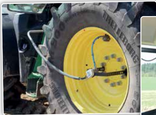
800 millimeter brede banden op de tractoren gebruikte het akkerbouwbedrijf al, maar sinds vorig jaar opteerde het ook voor een automatisch bandendrukwisselsysteem.
