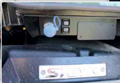
... net als de persluchtaansluiting en massaschakelaar buiten de cabine.
