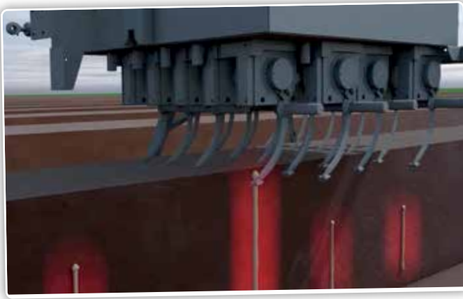
La position des asperges est déterminée grâce à la détection souterraine.
