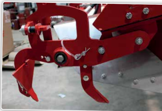
Montage d'un système anti-érosion entre les buttes en pommes de terre.
