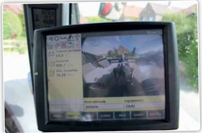
La caméra avant est automatiquement activée lorsque les clignoteurs sont activés. Cela augmente considérablement la sécurité.
