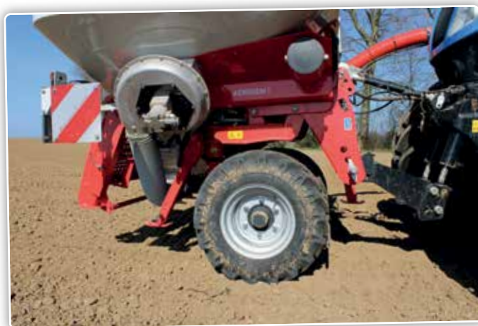
La trémie frontale peut être équipée d'un packer à pneus. La distribution est placée à l'avant.
