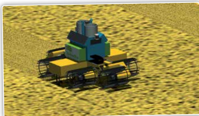
C'est à cela que va ressembler le robot. Il sera guidé via les rouleaux, un peu comme un véhicule sur chenilles. La puissance de cet E-robotiller est de 110 ch.
