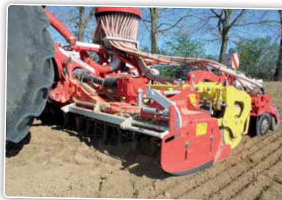
Une des innovations sur ce modèle est l'intégration des vérins de repliage sous la tête d'attelage, sans faux châssis.
