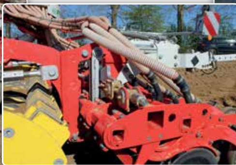
La barre de semis est montée sur le rouleau et suit le réglage de profondeur de ce dernier.
