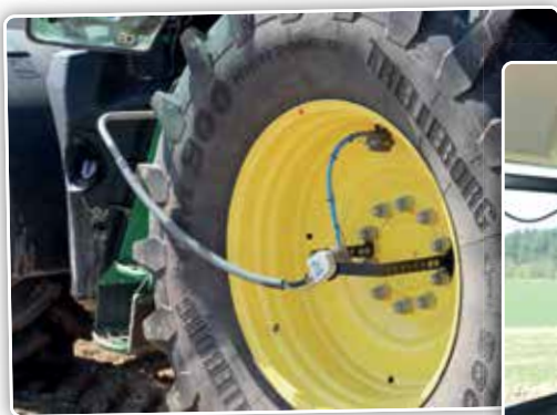
L'exploitation utilisait déjà des pneus de 80 centimètres de large sur les tracteurs, mais depuis l'année dernière, un système de télégonflage des pneumatiques a été ajouté.
