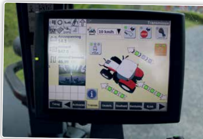
Le CVT Steyr S-Control le plus récent offre des paramètres de transmission personnalisables uniques.
