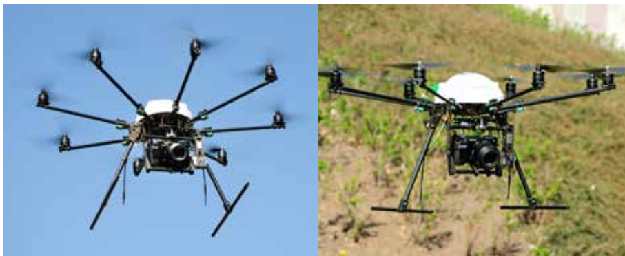
Afhankelijk van de aanwezigheid van sensoren kunnen landbouwdrone, hier een multicopter van CIS met 8 propellers, snel en efficiënt informatie voor een optimale gewasteelt leveren.
