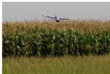
Het vliegtuigje heeft minimaal 150 meter nodig om te kunnen landen en vliegt in principe tussen 80 en 90 meter boven de grond.
