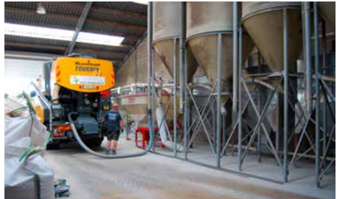
De mengeling kan zowel in big bags als in silo's worden geblazen.
