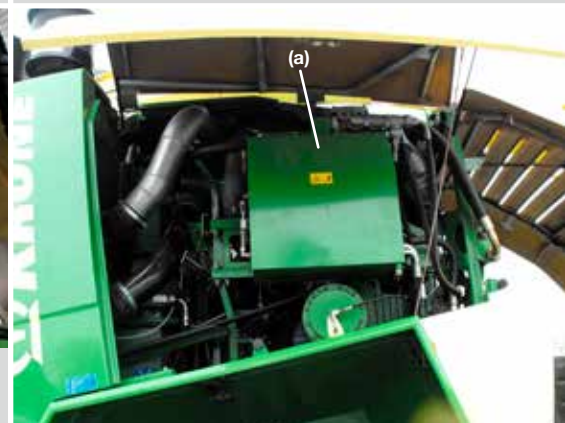
6/ Achteraan zit de transmissie en de hydrauliektank (a) met een kijkglas om het niveau en de toestand van de olie te kunnen controleren. In hetzelfde compartiment maar meer naar voor zit de koelvin.
