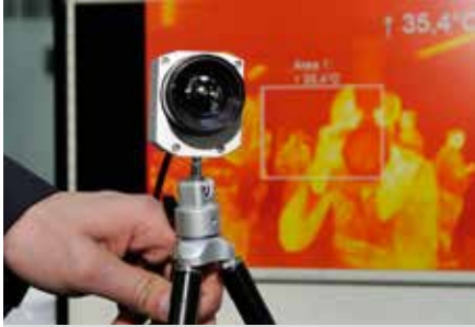
Een infraroodcamera legt de verschillende warmtezones in het afgebeelde bereik vast. Op de monitor is hier een warmtebeeld van de fotografie te zien die op de camera gericht is.
