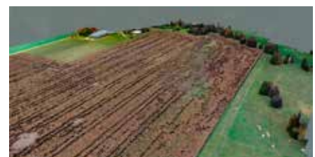
Opmeting van wildschade aan de gewassen via een drone. Het gemaakte 3D-model van de wildschade in een maïsveld toont de vreesporen en ook de loopbeweging van de dieren.
