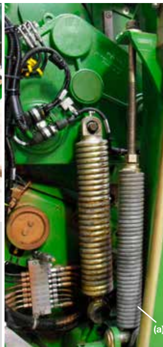
1/ De lagerhuizen aan iedere kant van de invoerrollen moeten worden gecontroleerd op olielekken, met speciale aandacht voor de onderste voorste rol (b) omdat deze over de volledige breedte de metaaldetector bevat. Door druk uit te oefenen tussen de rollen (c) en tussen het huis en de rollen kun je nagaan of de lagers versleten zijn.
