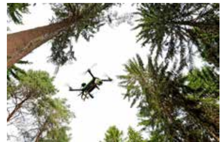
Voorzien van een multispectraalcamera kunnen drones bomen identificeren die door de schorskever zijn aangetast, zelfs weken voordat de verkleuring van de naalden zichtbaar wordt.
