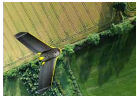
Voor het bepalen van de vegetatieindex (NDVI) op testpercelen wordt er een multispectraalcamera op een drone eBee van de Zwitserse firma SensFly gebruikt.
