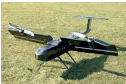
Prototype van een landbouwdroner voor testdoeleinden en zonder laklaag. Om verticaal op te stijgen, zwenkt de kiplvleugel de draagvlakken met de propellers naar boven.
