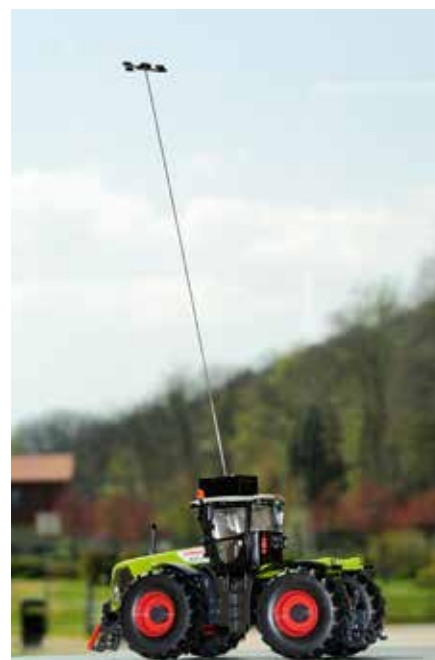
Model van een kabelgebonden vliegend draagplatform voor sensoren. Na de start begeleidt het systeem de mobiele landbouwmachine automatisch in de voorziene positie tot het voertuig.
