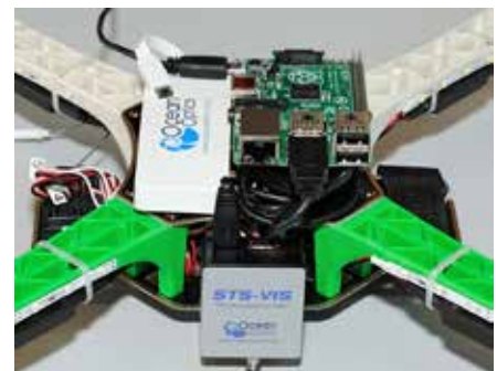
Sensoren worden steeds kleiner en lichter. Deze micro-spectrometerkit van de firma Ocean Optics weegt maar 62 g en is daarom zeer geschikt voor het monitoren van gewassen vanuit de lucht.
