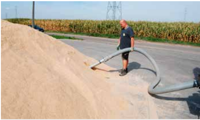
De grondstoffen worden opgezogen in de mobiele installatie.
