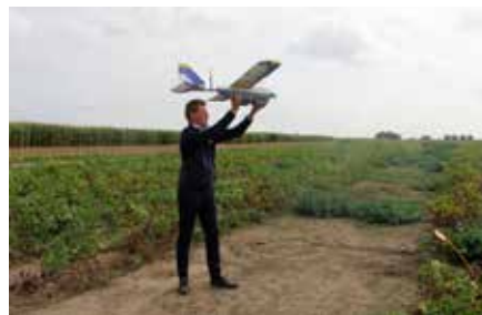
De drone laten opstijgen gebeurt door hem in een hand te houden en een lichte aanloop te nemen waarna hij zich uit je handen wegtrekt en zijn steile klim naar boven maakt.
