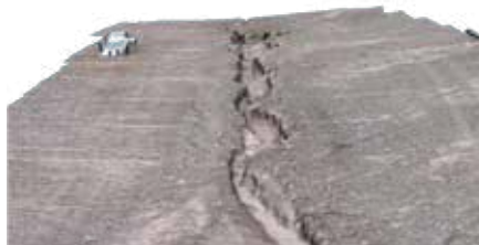
3D-model van een erosie op basis van een dataverzameling die met een drone werd gemaakt.
