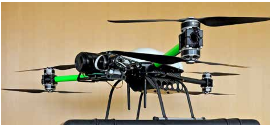
De constructie van deze tricopter met drie dubbele propellers maakt het mogelijk om ook beeldopnames naar boven te maken bv. voor de inspectie van de onderkant van bruggen.
