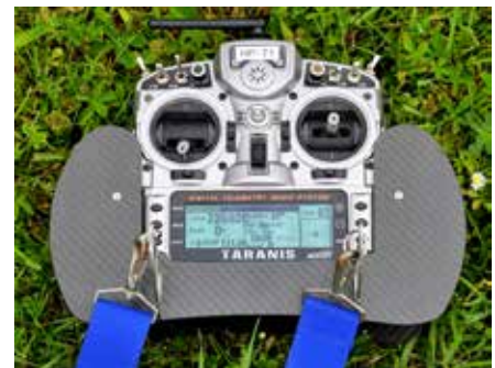
Voorbeeld van een stuurapparaat voor professionele drones: merk de veelvoudige bedieningsfuncties en de live-aanduiding van de belangrijkste vluchtgegevens.
