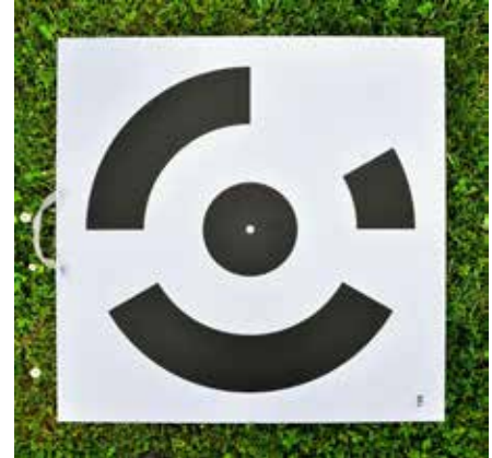
Deze markeringen voor de latere toewijzing van luchtfoto's worden gebruikt waar andere punten op het terrein ontbreken, bv. in een groot graanveld zonder andere gebouwen of andere oriënteringspunten.
