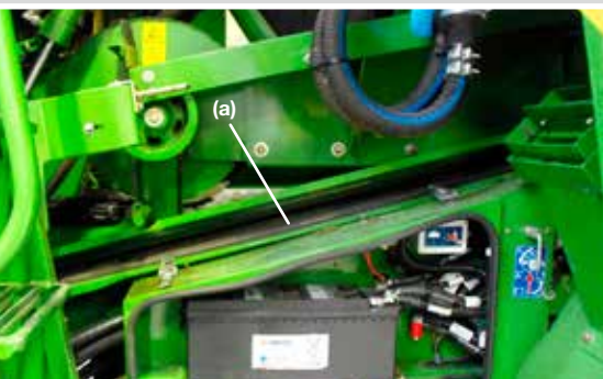
4/ Links van de machine zit de hoofdaandrijfriem (a), net boven de batterijkast. Controleer deze op slijtage en eventuele breuken. Deze riem kan vrij eenvoudig worden vervangen. Deze operatie zal minder lang duren dan een breuk met stilstand tijdens het werk.
