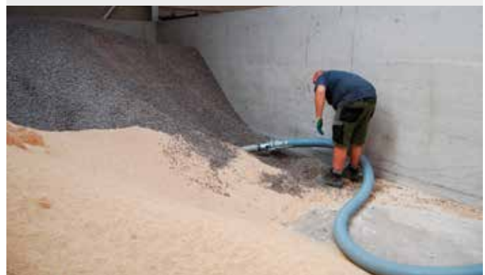
Doordat de installatie mobiel en vrij compact is kunnen de verschillende grondstoffen gemakkelijk uit verschillende silo's gezogen worden. ■
