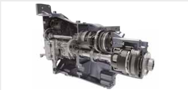
Hart van de X6 VT-Drive is de traploze transmissie die Argo zelf ontwikkelde en bouwde.
