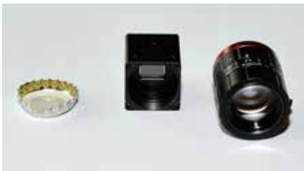
Sensortechniek voor het gebruik in drones. Hier een hyperspectraalcamera van de fabrikant Ximea. De eigenlijke sensor in het midden is nauwelijks groter dan een bierkroontje. Rechts ernaast het daarbij horende objectief.
