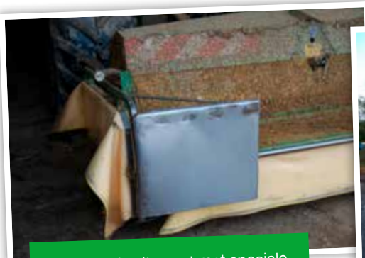
De Big M is uitgerust met speciale inoxplaten op de maaielementen om het gewas te buigen en dit gemakkelijker te kunnen maaien.
