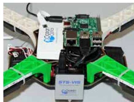
Les capteurs se miniaturisent de plus en plus. Ce mini-spectromètre de la société Ocean Optics ne pèse que 62 grammes et convient donc très bien pour scanner des cultures depuis les airs.
