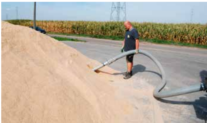
Les matières premières sont aspirées dans l'installation mobile.
