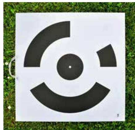
Ces marquages pour l'affectation de photos aériennes sont utilisés lors d'autres points manquant sur un terrain, comme par exemple dans un grand champ de blé sans bâtiments ou autres points d'orientation.
