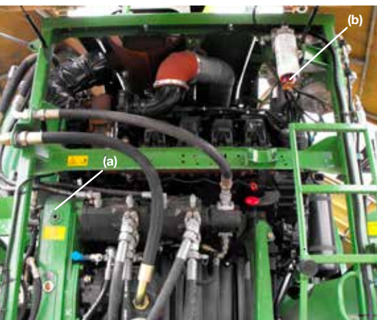
7/ Tout à l'arrière, on retrouve le réservoir d'huile pour la transmission (a). En regardant de gauche à droite, on voit le moteur et des dégâts pourraient indiquer une panne importante par le passé. A droite on voit le séparateur d'eau (b) qui a l'air d'être en ordre.
