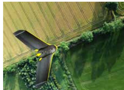
Pour déterminer l'index de végétation (NDVI) sur les parcelles de test, une caméra multispectrale montée sur un drone eBee de la société suisse SensFly est utilisée.
