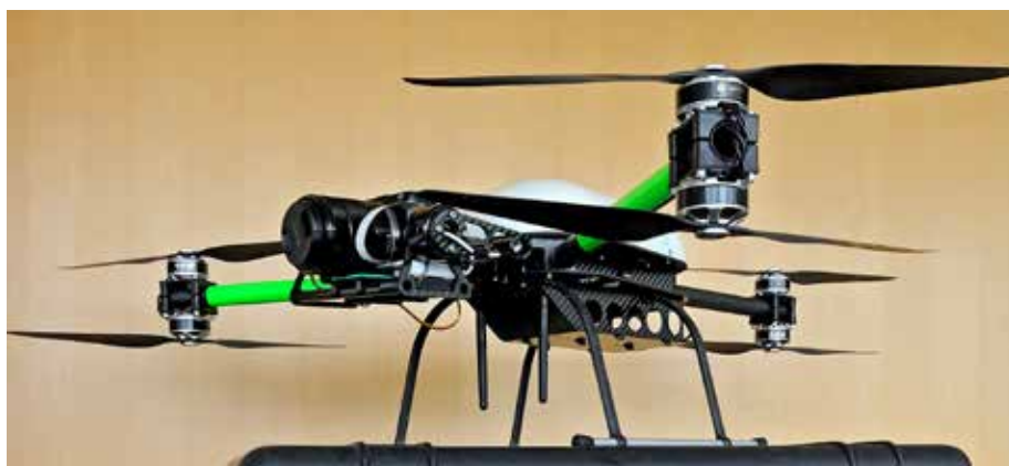
La construction de ce tricoptère à trois doubles hélices permet également de prendre des vues vers le haut, par exemple pour l'inspection de la partie inférieure d'un pont.
