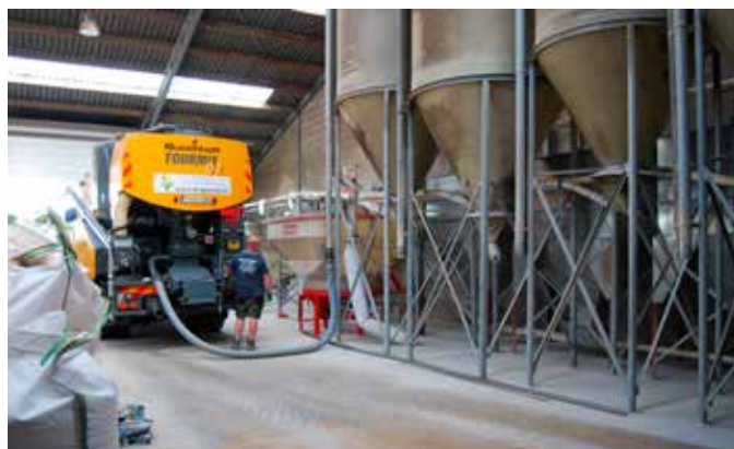
Le mélange peut être soufflé tant en big-bags que dans un silo.
