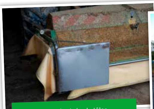
La Big M est équipée de tôles spéciales en inox sur les éléments de coupe afin de coucher la récolte et de la faucher ainsi plus facilement.
