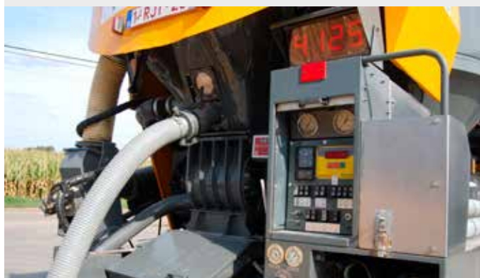
Le panneau de commande à l'arrière avec l'écran d'affichage du système de pesée.
