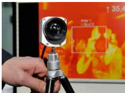
Une caméra infrarouge permet de visualiser les différentes zones de chaleur. Sur le moniteur, on voit l'image de la photographie qui regarde la caméra.
