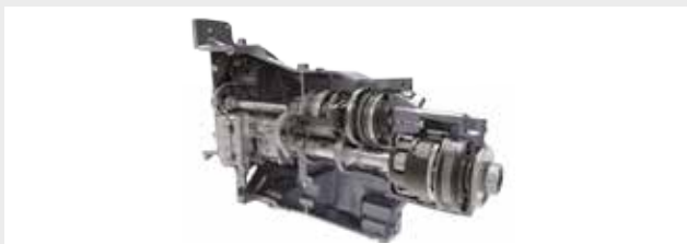
Le coeur du X6 VT-Drive est la transmission à variation continue qu'Argo a développé et produit en interne.
