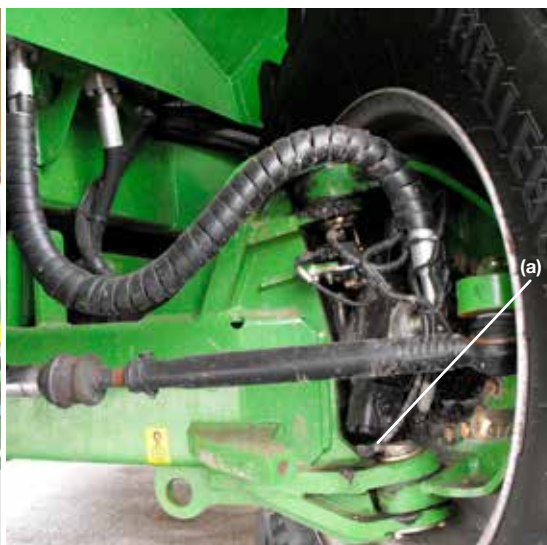
8/ Les moteurs de roues hydrauliques sont visibles en tournant la direction à fond (a). Il faut vérifier l'usure, mais également l'état de chaque roue et pneu.
