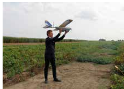
Pour faire décoller le drone, on le tient en main et on le jette vers l'avant et le haut, ce qui lui permet de prendre son envol.
