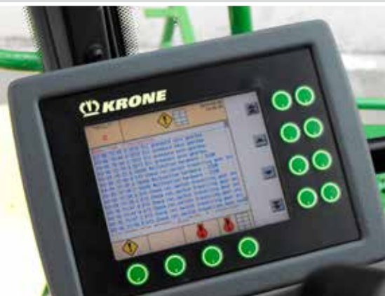
10/ En cabine, le moniteur permet de lire les codes d'erreur. L'historique donne une idée assez précise de la première vie de la machine.
