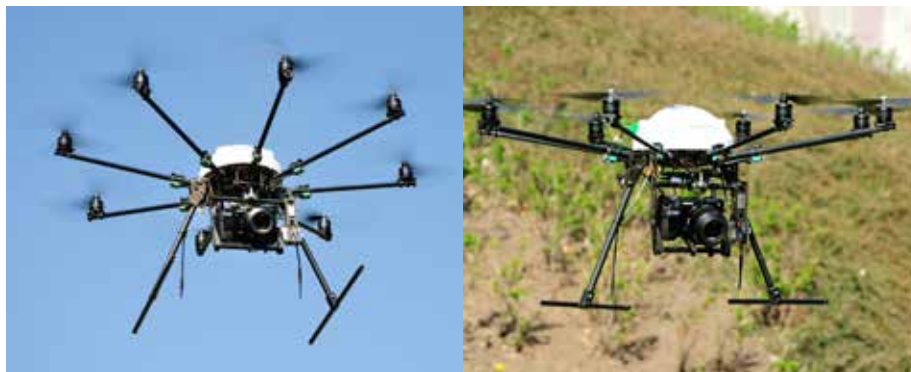
En fonction des capteurs montés, les drones agricoles, comme ce multicopter à 8 hélices de CIS, permettent de disposer rapidement d'informations efficaces à propos de la culture.
