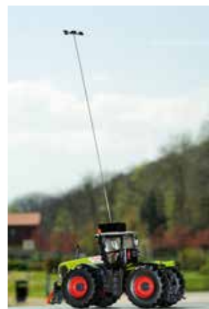
Modèle d'une plate-forme porteuse volante reliée par câble pour les capteurs. Après la mise en route, le système guide automatiquement la machine agricole dans la position déterminée par le véhicule.
