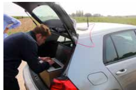
Une antenne est branchée sur l'ordinateur portable et elle assure le contact avec le drone.
