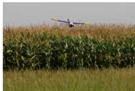
Le drone a besoin de 150 mètres pour pouvoir atterrir. En principe, il vole à une altitude comprise entre 80 et 90 mètres.
