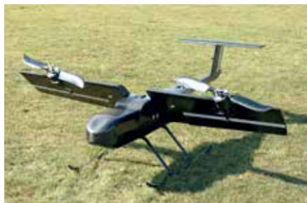
Prototype d'un drone agricole à des fins de test. Pour décoller verticalement, les hélices sont placées vers le haut.
