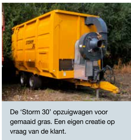
De opvangbak (8m³) met de aftakas-aangedreven ventilator is eveneens een eigen constructie.
