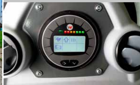
Het stroomniveau van de batterij wordt door een rood-oranje-groen licht op het instrumentpaneel weergegeven.
