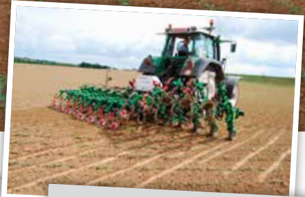
Elk schoffelelement kan afzonderlijk opgeheven worden om een zogenaamde sectieafsluiting per rij te bekomen.
