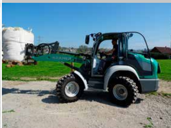
Lasten tot 1750 kg: de KL 25.5e blijft stabiel.
