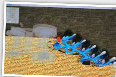
Onder www.lemken.com/de/lemken-aktuell/e-learning kan men de uitwerking van de spindelinstellingen in een interactieve animatie duidelijk zien en begrijpen wat de invloed is van een verkeerde instelling op het ploegen.
