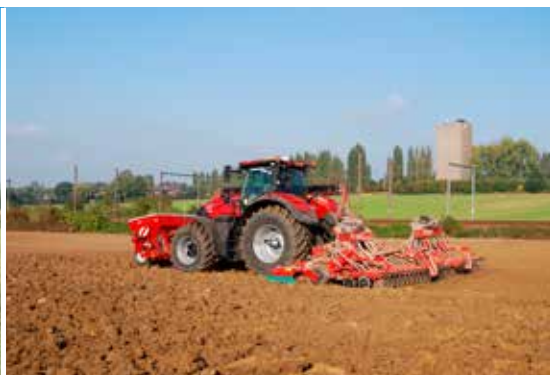
Verleden jaar hebben we onze nieuwe Optum laten uitrusten met een bandendrukregelsysteem waardoor we de bodemdruk nog verder kunnen verlagen, tijdens het zaaien bijvoorbeeld.
