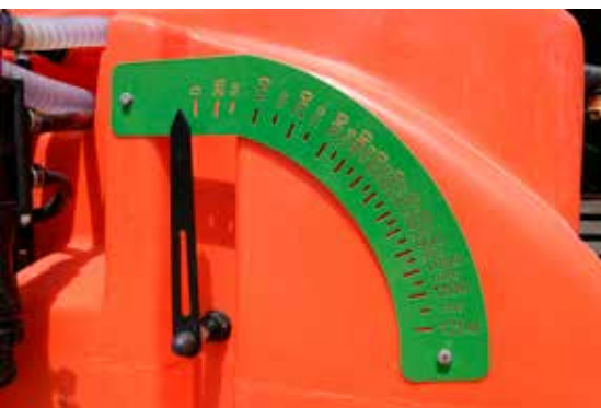
Goed zichtbare aanduiding van het niveau in de tank
