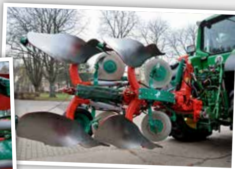
De Kvernelandploeg voor het wereldkampioenschap biedt extra regelmogelijkheden zoals bv. voor het afstellen van de scharen.
