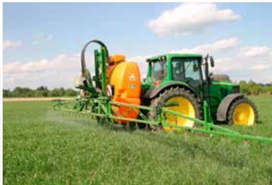
Le repliage horizontal de la rampe
