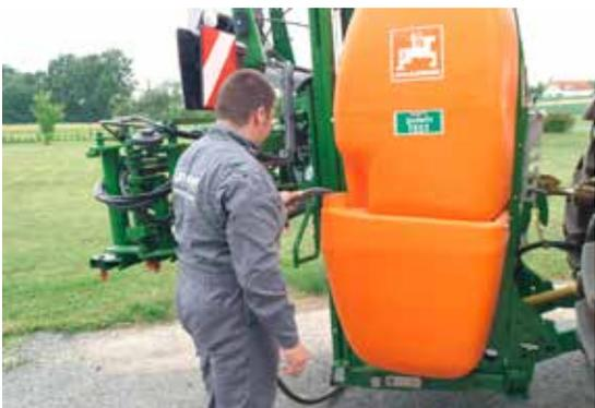
Remplissage du réservoir d'eau propre
