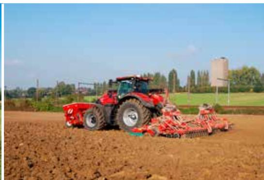
L'an dernier, nous avons équipé notre nouvel Optum d'un système de télégonflage des pneumatiques, ce qui nous permet de limiter davantage encore la pression au sol, lors des semis par exemple.
