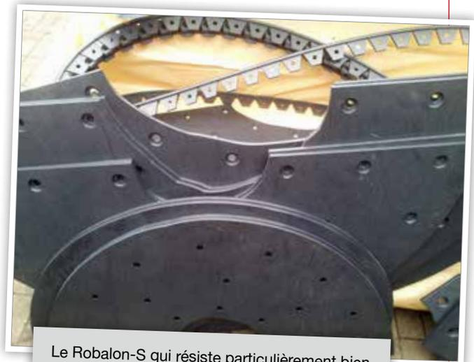
Le Robalon-S qui résiste particulièrement bien à l'usure gagne à présent du terrain dans le domaine de la mécanisation agricole. ■
