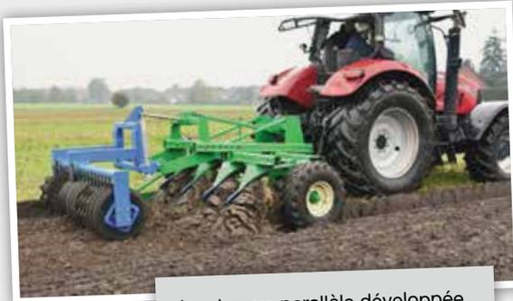
La charrue parallèle développée par Hans von der Heide ne fait que 1,9 m de longueur derrière le tracteur et peut être combinée avec d'autres machines.
