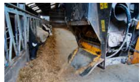
Bij het voederen beweegt de Secufeed klep naar beneden, waardoor er een soort verdeeltrechter ontstaat.
