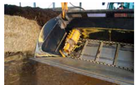
Zicht op het hydraulisch aangedreven verdeelelement boven het lostapijt.
