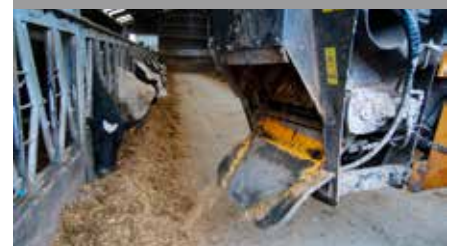
Lors de la distribution, les trappes Secufeed pivotent vers le bas pour former une sorte de goulotte de distribution.
