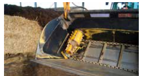
Vue sur le démêleur à entraînement hydraulique placé au-dessus du tapis.
