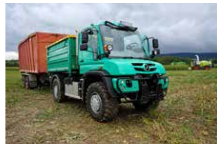
Deze in beladen toestand 28 ton wegende afroaanhangwagen wordt door de Unimog vlekkeloos getrokken tijdens deze presentatie. Vooraan bevinden zich een aftakas, aansluitingen voor 4 dubbelwerkende ventielen en een frontaanbouwplaat, die ook voor een hef kan worden geruild.
