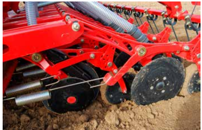
De e-drill is uitgerust met de bekende CX-II-zaaischijven van Kverneland. ■
