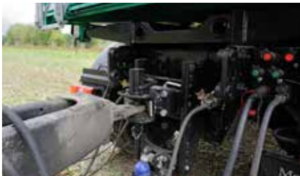
Als trekhaak staat bij de Unimog een in de hoogte verstelbare K80 kogelkoppeling en trekhaak ter beschikking.
