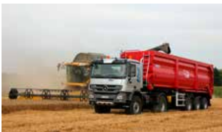
Van de lospijp onmiddellijk op de vrachtwagen: als de toestand van de bodem het toelaat zijn de agrotrucks een efficiënte mogelijkheid om de oogst af te voeren.
