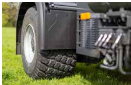
Grotere wielen en brede banden monteren is een van de eerste werken bij het ombouwen van een vrachtwagen tot agrotruck.
