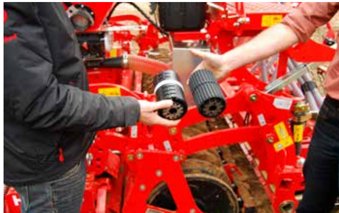
De Eldos-doseerunit kan met vier verschillende rotoren worden uitgerust, die snel en zonder gereedschap aan en af te bouwen zijn.
