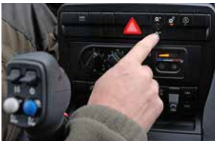
Bij de bandendrukregelinstantie 'Tirecontrol Plus' kan de bandenspanning manueel gescheiden voor de voor- en achteras ingesteld worden. Een andere mogelijkheid is dat de chauffeur via het bedienement aan het stuur een voorgeprogrammeerde modus voor de bandendruk kan kiezen.
