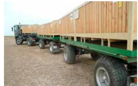
De lading van een door de ombouw ingekorte kipper dient bij de alleterreintruck van Schneider als ballast. Dat verbetert de tractie van het trekkende voertuig bij het trekken van aanhangwagens.
