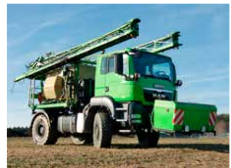
Schneider-alleterreintruck met 30 meter spuitmachine. De frontplaat wordt gebruikt om een tank met concentraat te dragen. →
