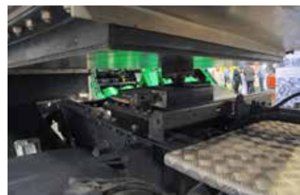
De kogelkoppeling tussen trekker en opligger garandeert een goede stabiliteit op oneffen terrein.
