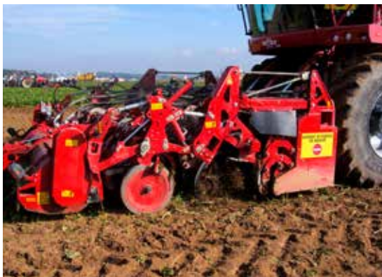
Aangedreven-zelfzoekende rooiwielen 'plukken' de biet uit de grond.
