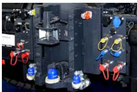
Achterkant met koppelingen en aansluitingen bij de Agro Mover van Paul Nutzfahrzeuge met in de hoogte verstelbare trekhaak, kogelkoppeling van 80 mm en 2 stuurgogels van 50 mm en diverse hydraulische aansluitingen.
