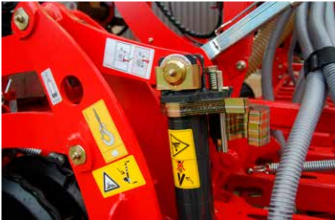
De hydraulische hefcilinders van de kouterbalk zijn uitgerust met vulplaatjes zodat de werkdiepte snel en eenvoudig kan aangepast worden.
