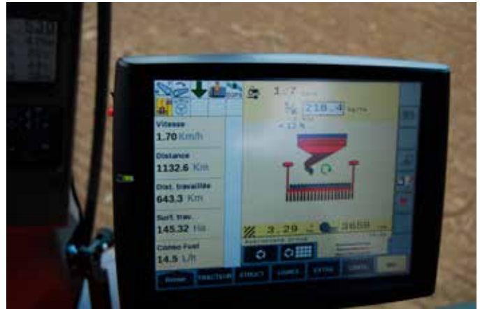
Als de tractor met ISOBUS uitgerust is, kan de zaaimachine eenvoudig via de terminal van de tractor bediend worden.
