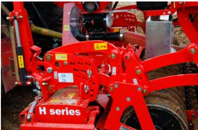
De instellingen van de rol (en dus van de werkdiepte) van de rotoreg hebben geen invloed op de zaaidiepte van de kouterbalk.
