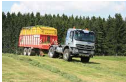
Agrotrucks, zoals hier de Agro Mover van Paul, hebben een aftakas achteraan en kunnen bv. een opraapwagen trekken.
