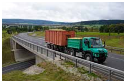
De geoogste gewassen kunnen met een agrotruck snel worden afgevoerd zonder dat er eerst moet worden overgeladen. De maximale transportlengte van 18 meter kan daarbij met een tweeassige aanhangwagen optimaal benut worden.
