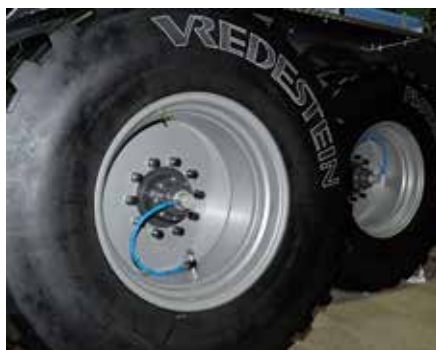
Bandendrukregelsystemen, zoals hier de installatie van PTG, zorgen voor een betere bescherming van de bodem door de aanpassing van de bandenspanning in functie van de ondergrond.
