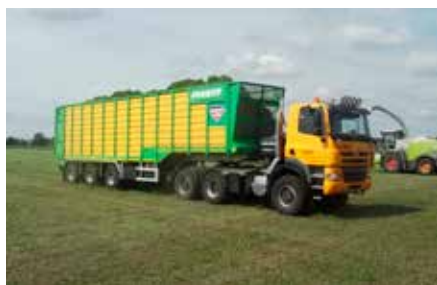
Agrot trucks, hier een trekker met Joskin Drakkar afdraaisysteem, rust de ombouwer Stapel naar wens uit met grootvolumige lagedrukbanden met een diameter van 1m70 en 80 cm breedte.
