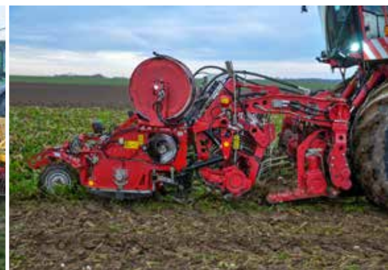
De Holmer Easylift gebruikt een rijonafhankelijke diepteregeling op de Holmer T4-serie.
