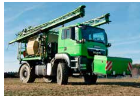
Un camion tout-terrain Schneider avec un pulvérisateur de 30 mètres. La plaque d'attelage frontale est utilisée pour fixer une cuve avec un produit concentré. →
