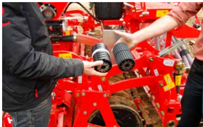
L'unité doseuse Eldos peut être équipée de quatre rotors différents, qui peuvent être interchangeables rapidement et sans outils.
