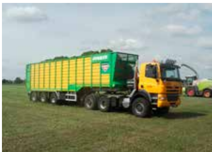
Le constructeur Stapel équipe les agrotrucks, ici en combinaison avec une remorque Joskin, de pneus grand volume et à basse pression avec un diamètre de 170 cm et une largeur de 80 cm.
