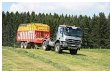
Les agrotrucks équipés d'une prise de force arrière, comme ici l'Agro Mover de Paul, peuvent par exemple entraîner une autochargeuse.
