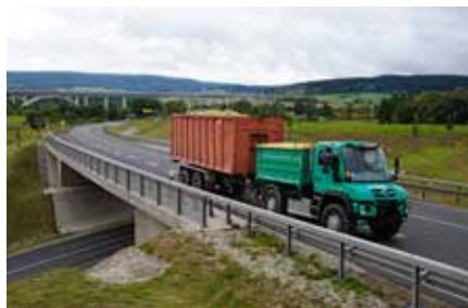
Avec un agrotruck, les récoltes peuvent être transportées rapidement, sans qu'il ne soit nécessaire de les transborder. La longueur de transport maximale de 18 mètres peut être utilisée de manière optimale avec une remorque à deux essieux.
