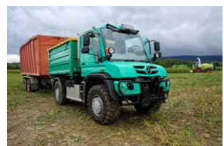
Cette remorque à fond mouvant d'un poids total en charge de 28 tonnes est tractée sans problème par cet Unimog lors d'une présentation. A l'avant, on retrouve une prise de force, 4 distributeurs double effet et une plaque d'attelage qui peut être interchangeable avec un relevage hydraulique.
