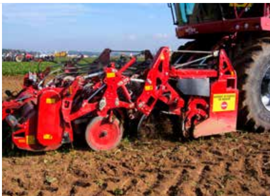
Les roues Ooppel animées permettent d'arracher doucement les betteraves.
