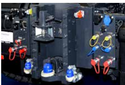
Vue sur l'attelage proposé sur l'Agro Mover de Paul Nutzfahrzeuge avec un attelage à gradin, une boule d'attelage K80 et deux attelages K50 pour les essieux directionnels.
