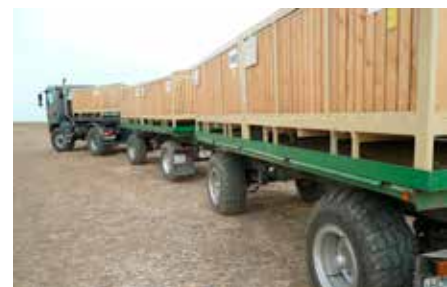
Sur tous les véhicules Schneider, la caisse raccourcie sert de ballast. De ce fait, la traction du véhicule est améliorée lorsqu'une lourde remorque est tractée.
