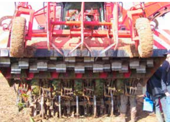
Effeuiller, décolleter, arracher avec des socs animés et nettoyage à l'aide de soleils.
