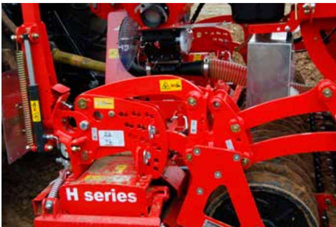
Les réglages du rouleau (et donc de la profondeur de travail) de la herse rotative n'ont pas d'influence sur la profondeur de semis de la barre de semis.
