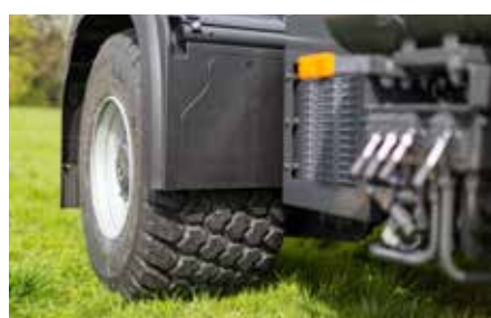
Monter des grandes roues et des pneus larges est une des premières étapes de la transformation d'un agrotruck.
