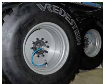
Les systèmes de télégonflage comme l'installation de PTG offrent une meilleure protection du sol en permettant d'adapter la pression de gonflage des pneumatiques.
