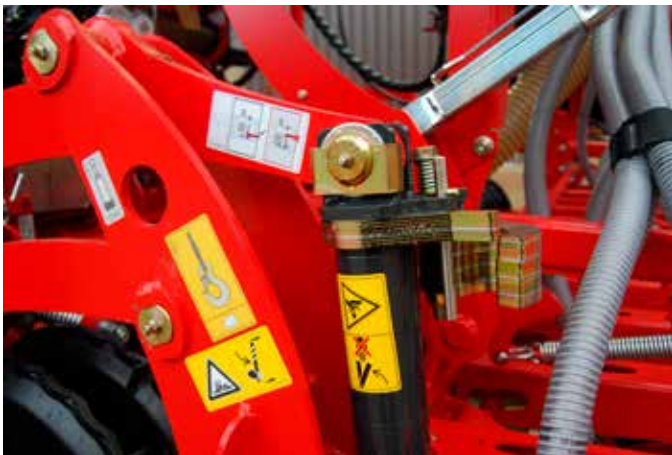
Les vérins de relevage hydraulique de la barre de semis sont équipés de plaques d'espacement, ce qui permet d'adapter facilement et rapidement la profondeur de semis.
