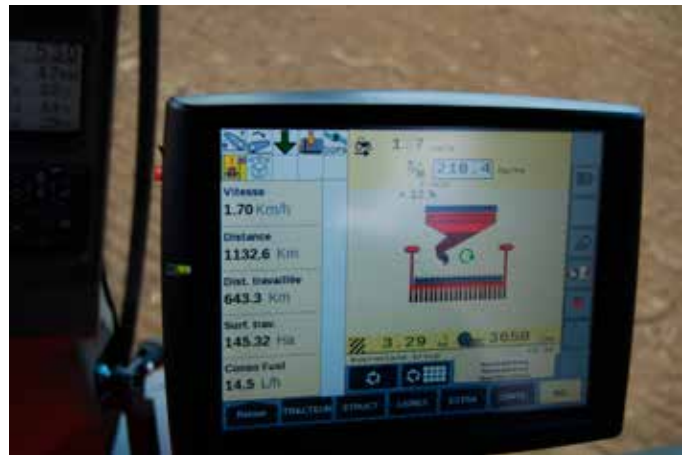
Si l'utilisateur dispose d'un tracteur pré-équipé, il peut alors tout simplement commander le semoir via le terminal du tracteur.
