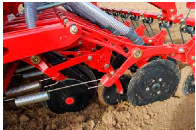
Le e-drill est équipé des disques semeurs CX-II bien connus de Kverneland. ■
