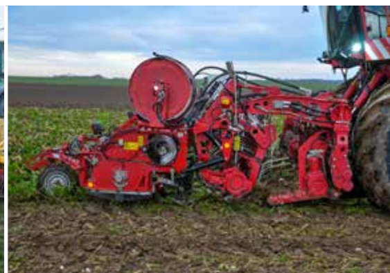
Le système Holmer Easylift propose un réglage de la profondeur indépendant par rang sur l'intégrale Holmer T4.
