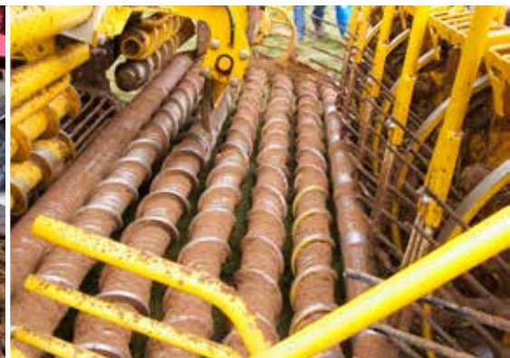
La plupart des constructeurs recourent à des rouleaux axiaux pour le nettoyage, parfois en combinaison avec des soleils.
