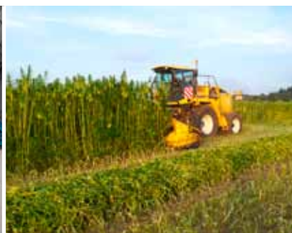
Vezelhennep wordt gemaaid met een omgebouwde hakselaar.
