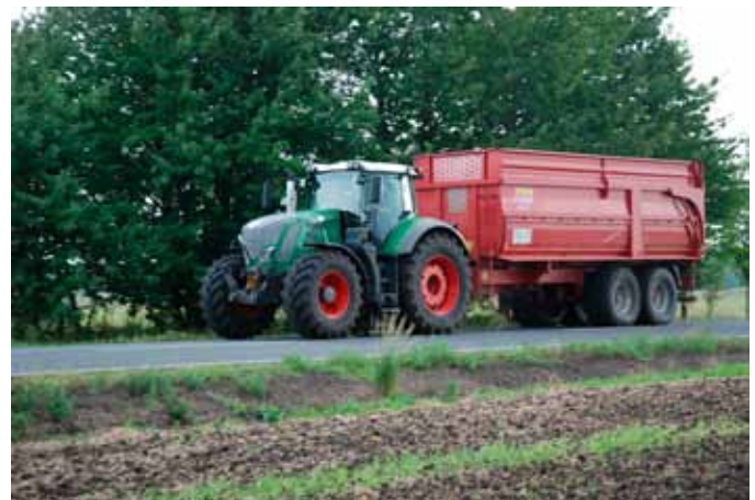
Met 2,4 bar bandenspanning in de trekker gaan de rolweerstand en het verbruik omlaag en bereikt men een hogere stuur- en remveiligheid.
