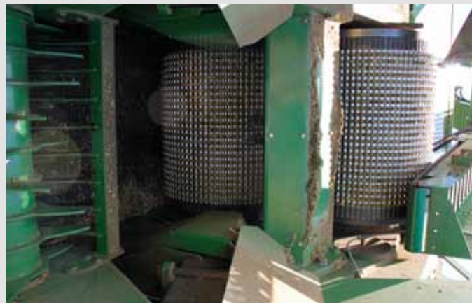
Het stro wordt tussen twee getande trommels doorgeperst en via de gaten tot pellets gevormd.
