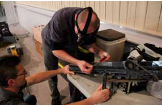
Geert geeft de transportband nog een grondige revisie.
