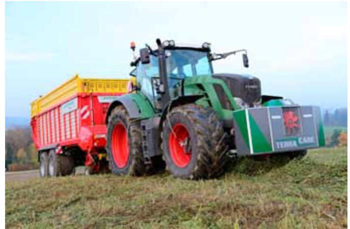
Een juiste bandenspanning (0,8 bar) in het veld vermindert slip en verhoogt het rendement per ha.
