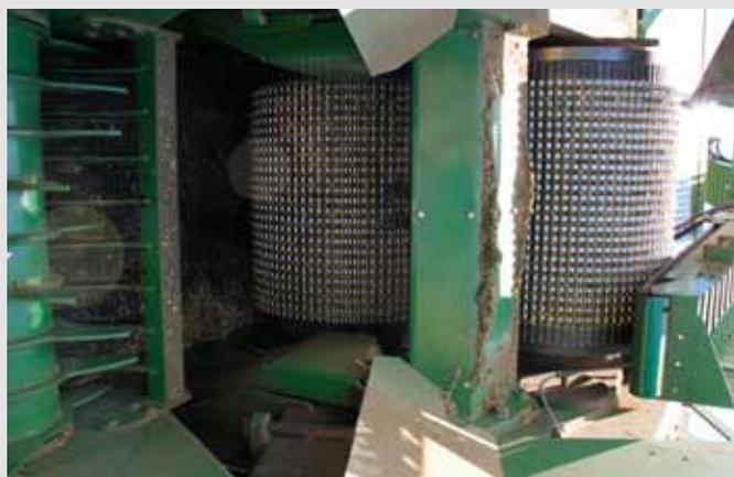
Le fourrage passe à travers deux rouleaux pourvus de trous et qui permettent de transformer le fourrage en pellets.
