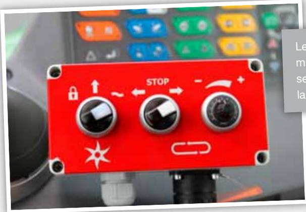
Le boîtier de commande du rotor et du sens de rotation et de la vitesse du tapis.
