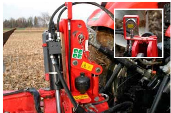
Grâce au report de charge, il est possible de reporter la charge de l'outil sur l'essieu arrière, ce qui permet de réduire le patinage.
