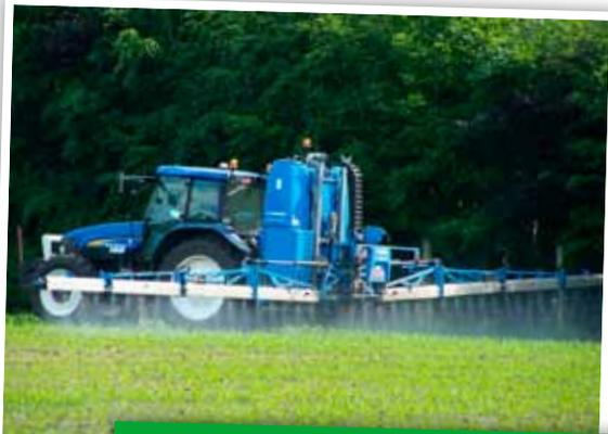
La demande en travaux de pulvérisation progresse. Le pulvérisateur est équipé du gps et du contrôle de sections.
