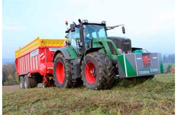
Une pression de gonflage correcte (0,8 bar) au champ permet de limiter le patinage et d'augmenter le rendement par hectare.
