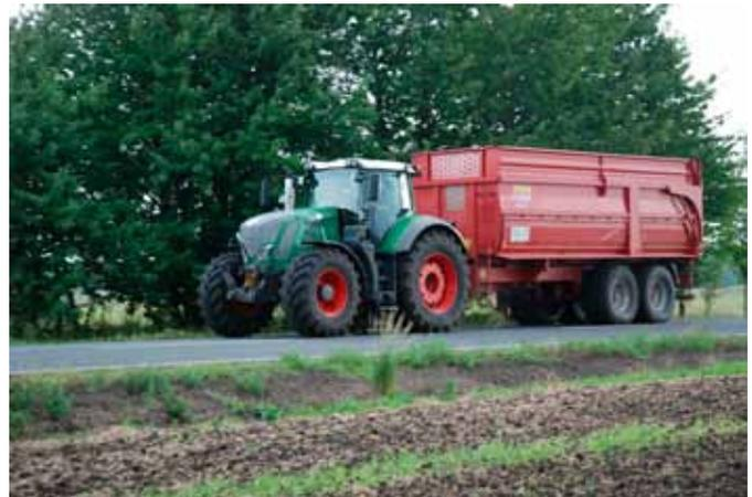
Avec une pression de 2,4 bar, la résistance au roulement et la consommation seront moins importantes, tout en augmentant la sécurité de conduite et de freinage.
