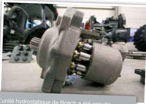
L’unité hydrostatique de Bosch a été ensuite démontée et analysée par les techniciens de Claas.
