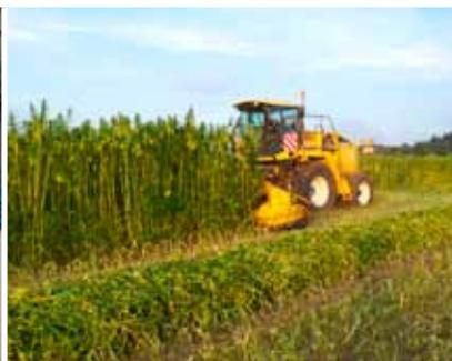
Le chanvre est fauché à l'aide d'une ensileuse automotrice spécialement adaptée.
