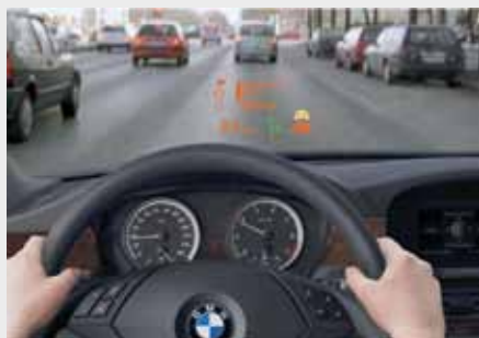
Op het head up-display van de voorruit van deze auto verschijnt de belangrijkste verkeersinformatie in het gezichtsveld van de chauffeur.
