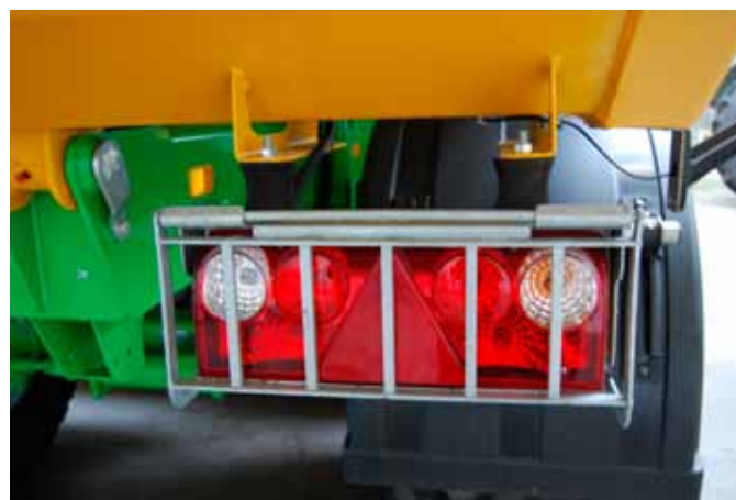
Een typisch voorbeeld van iets dat afgekeurd wordt bij een homologatie, maar dikwijls in de praktijk gevraagd wordt: de bescherming van de verlichting.
