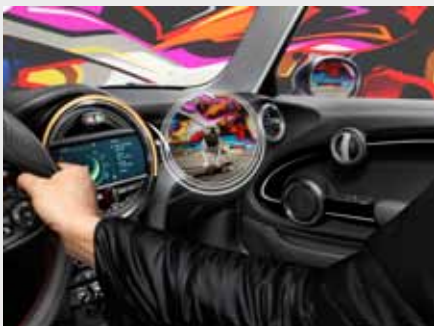
De Augmented Realitybril van de BMW-dochter Mini projecteert informatie voor de bestuurder en maakt het voertuig in röntgenmodus doorzichtig.
