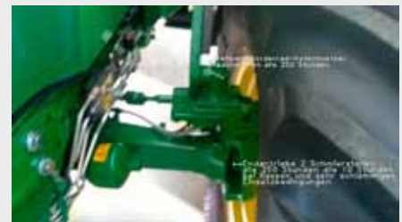
Als men de camera van de tablet op de vooras van de trekker richt, verschijnt er op het display extra informatie zoals de plaats van de smeernippels en aanwijzingen voor de onderhoudsintervallen.
