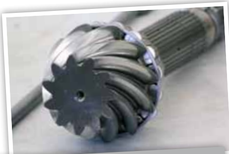
Het kegeltandwiel (worm en wormwiel) liet een lichte polijsting van de oppervlakte zien. Meer was er niet aan de hand.
