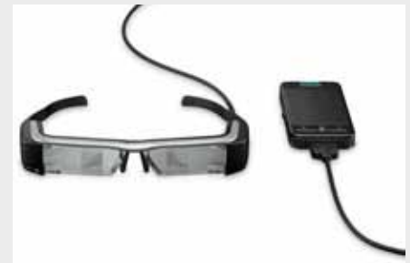
Bij de AR-bril Moverio BT-200 van Epson kijkt de gebruiker door een transparant display. Als besturingssysteem gebruikt men Android.
