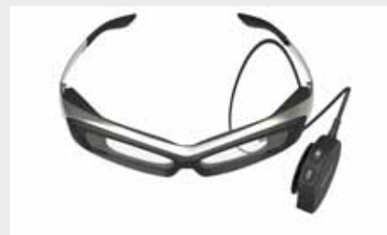
De SmartEyeglass van Sony kan verbinding maken via Bluetooth en WiFi. De databril heeft een ingebouwde microfoon, koptelefoon en een camera.
