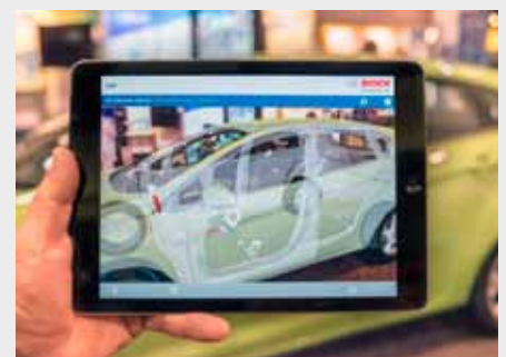
Ook nog een optie voor het onderhoud en de herstelling in de landbouwtechniek: visualisering van niet-zichtbare kabelbomen door Augmented Reality.
