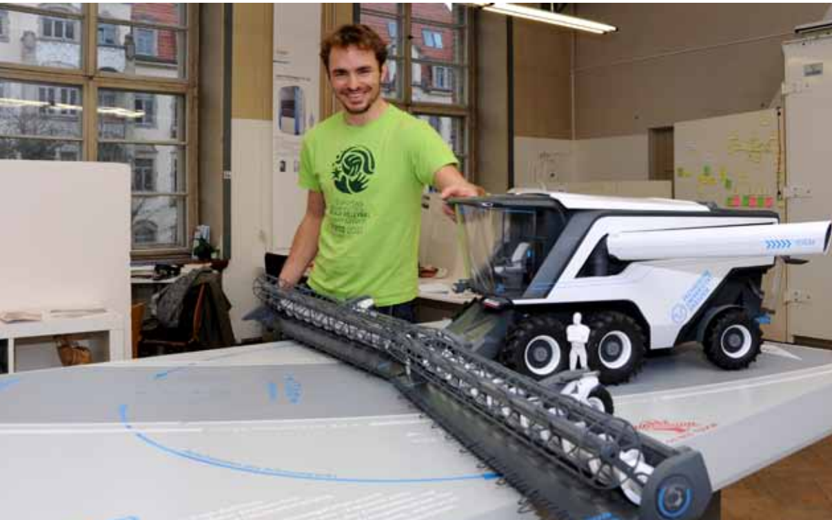
Christoph Philipp Schreiber van de universiteit van Dresden ontwikkelde als eindwerk dit maaidorserconcept met opklapbaar maaibord.
