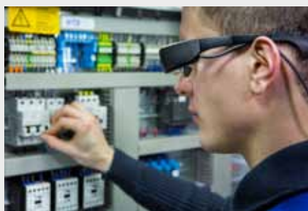
In het gezichtsveld van de databril kunnen de stappen in het arbeidsproces stap voor stap geprojecteerd worden. het systeem herkent onmiddellijk een verkeerde handeling en geeft dan passende aanwijzingen.
