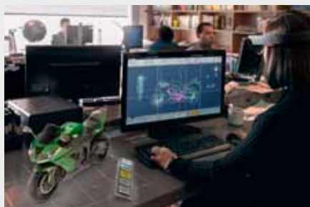
Met de AR-bril HoloLens van Microsoft kunnen ontwerpen onmiddellijk als virtuele 3D-voorwerpen worden voorgesteld.
