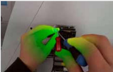
In het gezichtsveld van een Augmented Realityhandboek wordt de gebruiker bij zijn werk stap voor stap verder geleid. De groen gekleurde hand geeft aan dat men op de juiste plaats is.
