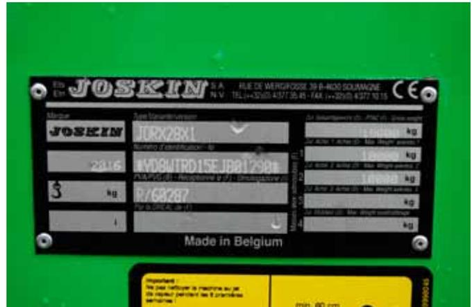
Les véhicules homologués reçoivent une plaquette d'identification.
