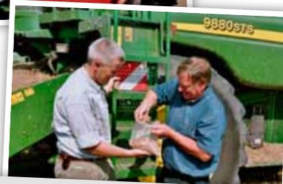
Il faut limiter la proportion de grains cassés en réglant correctement l'écartement entre le batteur et le contre-batteur.
