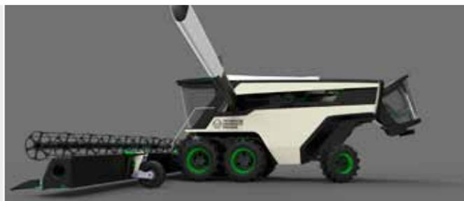
Au travail, la cabine arrière de la moissonneuse est placée en hauteur.
