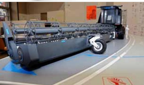
Les roues de la barre de coupe repliable occupent plusieurs fonctions et sont une composante importante de ce concept de battage.
