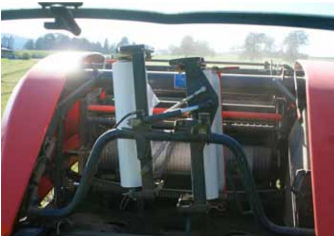
Au repos, ces deux rouleaux sont placés verticalement, ce qui permet de grouper l'entrée de film plastique dans la presse.
