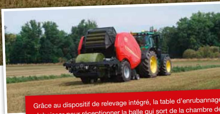
Grâce au dispositif de relevage intégré, la table d'enrubannage va s'abaisser pour réceptionner la balle qui sort de la chambre de pressage.
