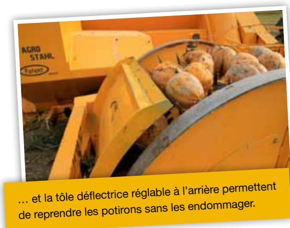
par causer des bourrages. Grâce au montage par parallélogramme, le rouleau à picots s'adapte bien aux inégalités du sol. Au travail, les vérins de relevage sont de plus placés en position flottante. Un vérin amortisseur supplémentaire permet d'amortir les à-coups et assure un dépliage et un repliage en douceur de l'unité de ramassage.
