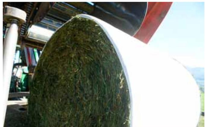
Pour le liage, le film plastique est pré-étiré à 90%. Cela permet d'appliquer également le film sur les côtés de la balle.
