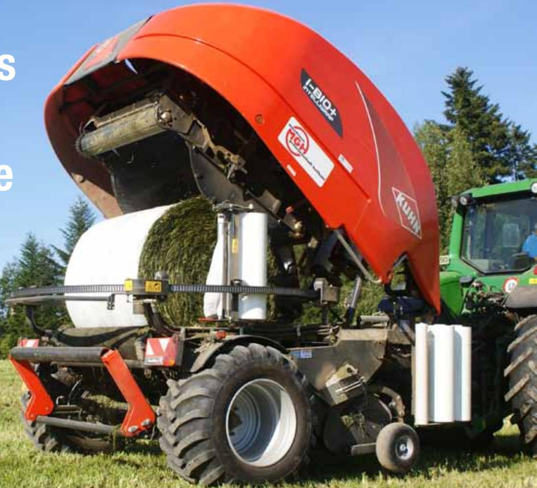
Lors d'Agritechnica, Kuhn a présenté un nouveau système de liage par film plastique pour sa presse à balles rondes i-Bio+. Nous avons eu l'occasion de suivre dans la pratique une machine de présérie. Au cours de la dernière saison, cette presse a réalisé près de 2.500 balles liées avec du simple plastique d'enrubannage.
