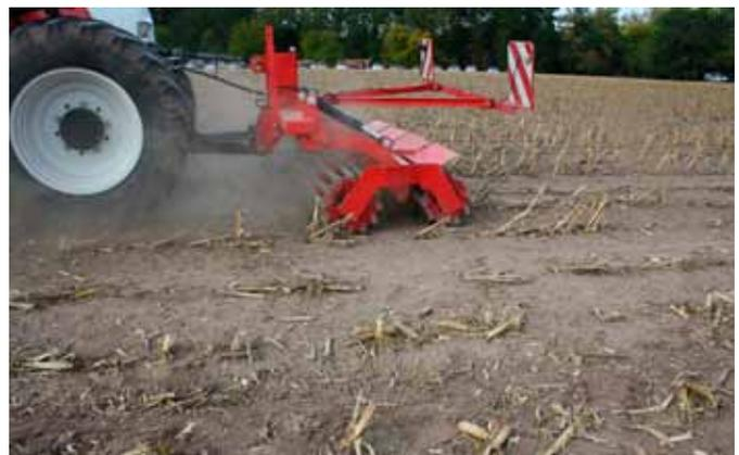
Cette machine est équipée d'un double rouleau modifié et se monte tant à l'avant qu'à l'arrière du tracteur.
