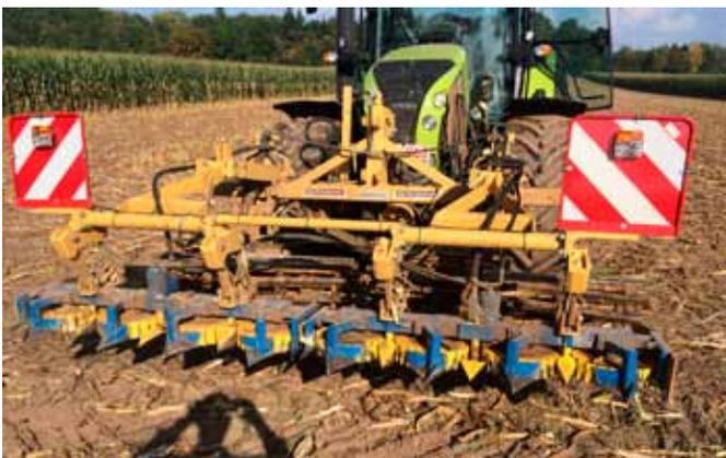
Cette machine se compose de plusieurs tambours à entraînement hydraulique, ainsi que d'un rouleau adapté.
