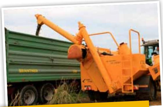
La buse de vidange en deux parties permet de vider la trémie à une hauteur de 3,90 m et à une certaine distance de la récolteuse.
