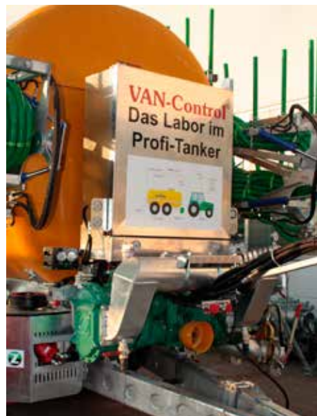
↳ Le spectromètre NIR monté sur la tonne à lisier interprète les données reçues par le capteur NIR et module ensuite la dose de lisier apportée.
