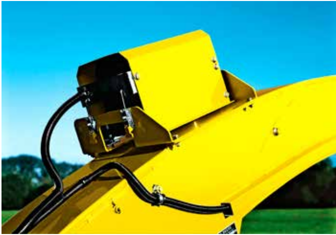
↳ Le spectromètre NIR compact développé conjointement avec Zeiss et monté sur la goulotte de l'ensileuse John Deere autorise une analyse en temps réel et adapte la longueur de coupe en fonction de la teneur en matière sèche mesurée dans le flux de fourrage.
