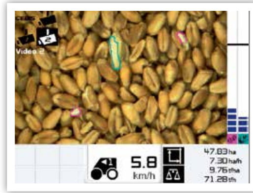
↳ Sur l'écran, les problèmes de qualité de grain sont clairement indiqués en couleur. Les images utilisées à cet effet proviennent de la Grain Quality Camera de Claas.
