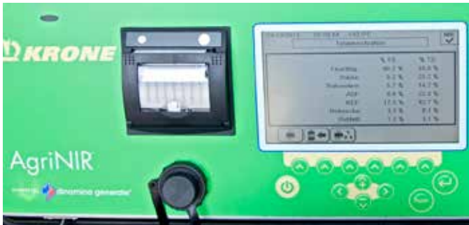
↳ Sur l'écran de l'appareil mobile d'analyse de Krone, il est possible de connaître la composition d'un échantillon de fourrage en quelques minutes.
