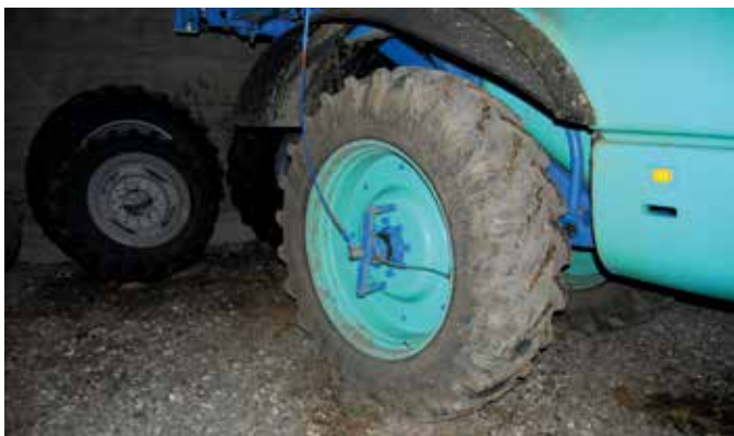
↳ Le tracteur et le pulvérisateur ont été équipés d'un système de télégonflage des pneumatiques que Didier a monté lui-même.
