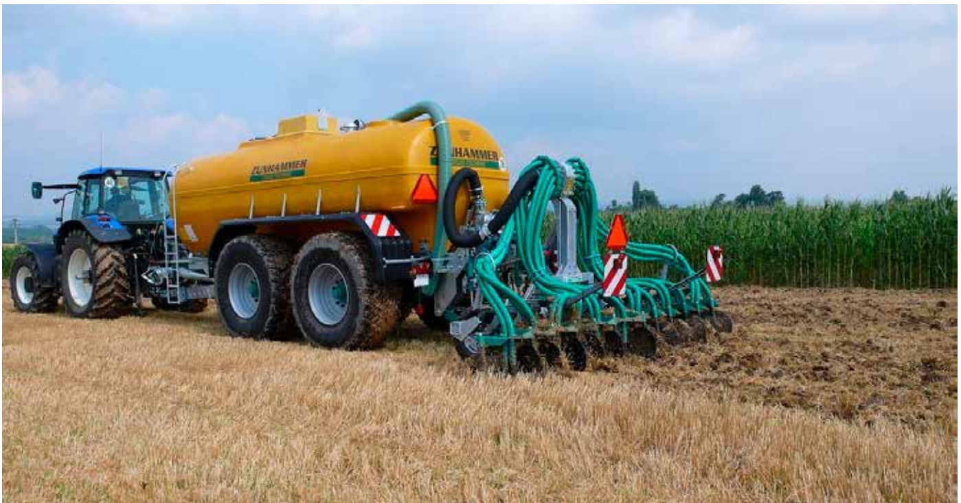
↳ le spectromètre NIR monté sur la tonne à lisier interprète les données du capteur NIR et adapte le dosage en conséquence.
