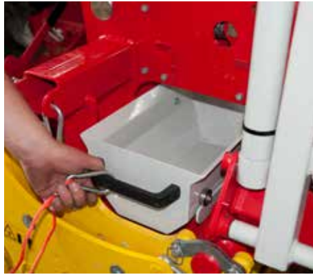
↳ Le réglage de débit a été facilité, grâce au recours à un auget coulissant, du côté gauche de la machine.
