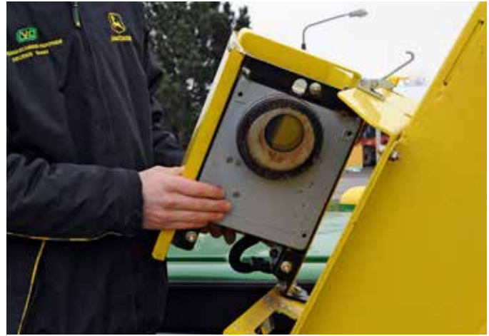
↳ Lors de l'ensilage de maïs pour l'exploitation Hohenroda, le capteur NIR HarvestLab analyse la qualité du maïs ensilé lors de son passage par la goulotte.
