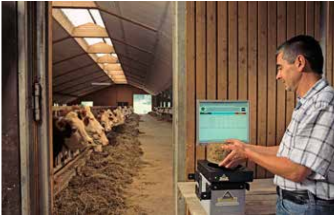
↳ Les spectromètres NIR compacts, comme le HarvestLab de John Deere peuvent également être utilisés comme laboratoire mobile.
