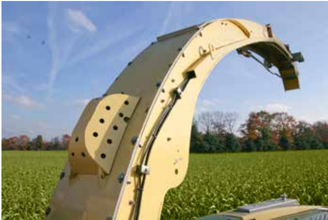
↳ Le capteur NIR monté sur la goulotte de la BigX de Krone enregistre également la teneur en matière sèche du fourrage récolté.
