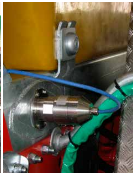
↳ Le capteur NIR du système VAN-Control de Zunhammer mesure la composition du lisier lors du remplissage de la tonne.
