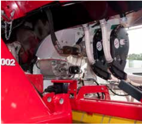
↳ Plusieurs éléments de distributions monograines sont placés sous la trémie de part et d'autre de l'élément de distribution standard.
