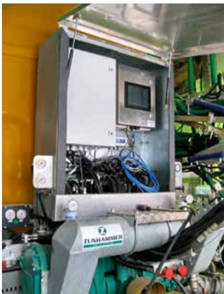
↳ Le spectromètre NIR monté sur la tonne à lisier interprète les données reçues par le capteur NIR et module ensuite la dose de lisier apportée.
