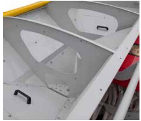
↳ La segmentation de la trémie en trois compartiments permet d'appliquer de l'engrais en localisé, ou même d'implanter un couvert végétal lors du semis.
