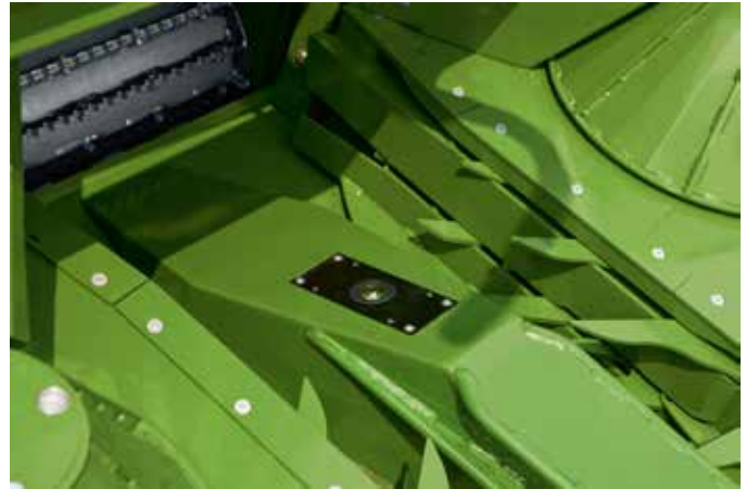
↳ La cellule photo-optique montée au centre du bec de l'ensileuse BigX de Krone mesure le degré de maturité des plantes de maïs, et adapte ensuite automatiquement la longueur de coupe.
