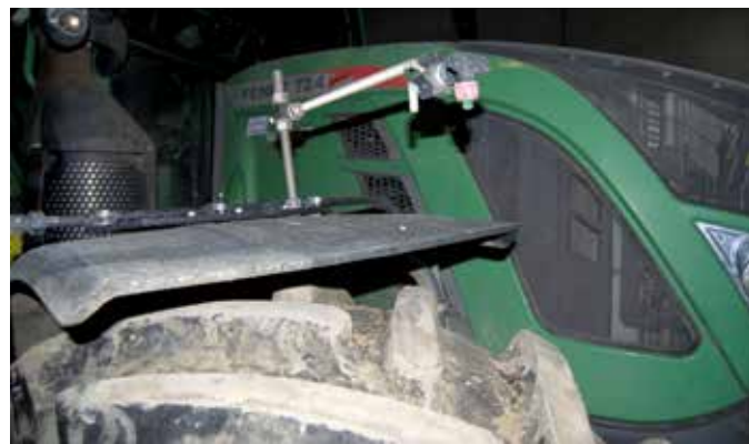
↳ Didier a monté des buses au-dessus des roues avant de son tracteur de pulvérisation. En pulvérisant du Roundup sur les roues avant, les traces de pulvérisation restent propres.
