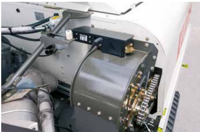
↳ La nouvelle Grain Quality Camera montée dans le haut de l'élévateur à grain sur la moissonneuse Claas aide le chauffeur à contrôler la qualité du grain récolté tout en roulant.
