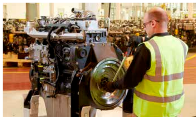
↳ Hoe moderner de motor zelf, hoe groter het regelbereik binnen de emissie-eisen. JCB heeft bijvoorbeeld zo'n compleet nieuwe motorenserie ontwikkeld. Oudere, voor de emissie-eisen telkens opgewaardeerde motoren, herken je aan meer zaken 'om de motor heen' om de eisen te halen.
