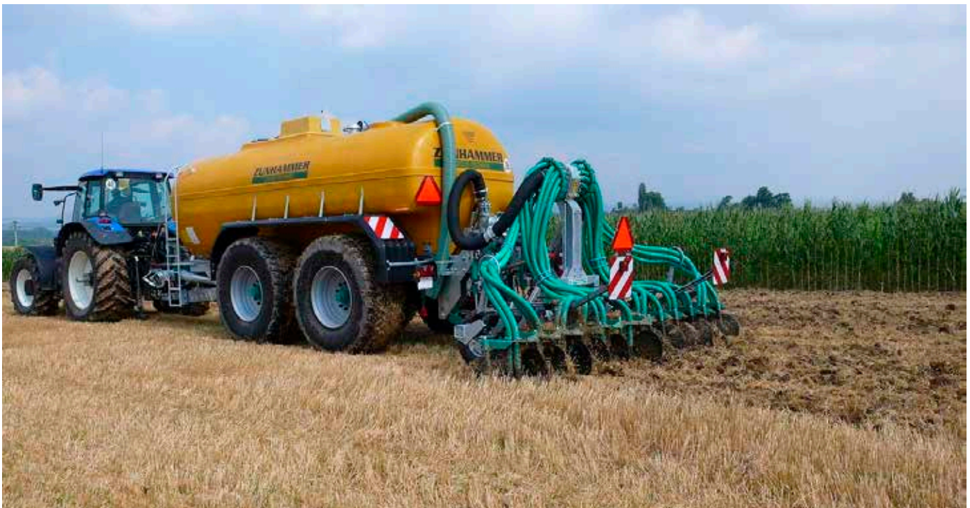
↳ De NIR-spectrometer op de drijfmesttank interpreteert de gegevens van de NIR-sensor en stuurt de uitgebrachte hoeveelheid nutriënten hierop aan.
