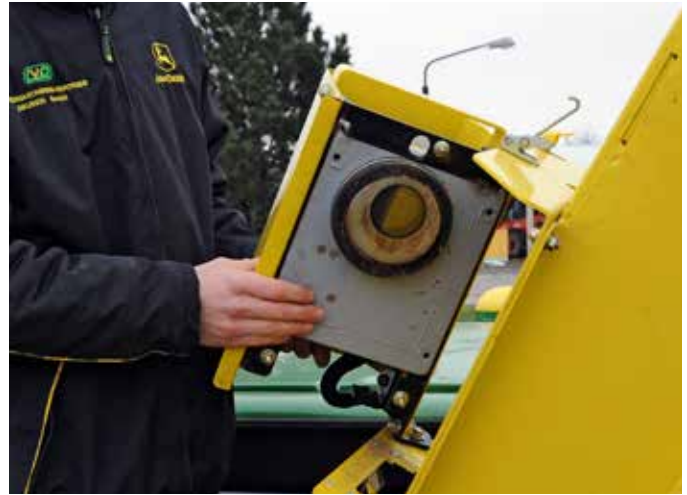
↳ Bij de maïsoogst voor de Agrarergenossenschaft Hohenroda eG analyseert de NIR-sensor HarvestLab de kwaliteit van de gehakselde maïs reeds bij het passeren in de uitwerppijp.
