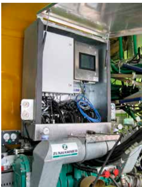
↳ De NIR-spectrometer op de drijfmesttank interpreteert de gegevens van de NIR-sensor en stuurt de uitgebrachte hoeveelheid nutriënten hierop aan.
