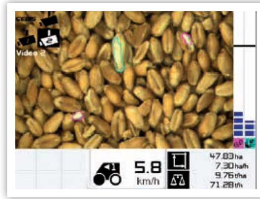
↳ Op het display worden de probleemgebieden bij de korrelkwaliteit in kleuren duidelijk aangegeven. De beelden daarvoor komen van de Grain Quality Camera van Claas.
