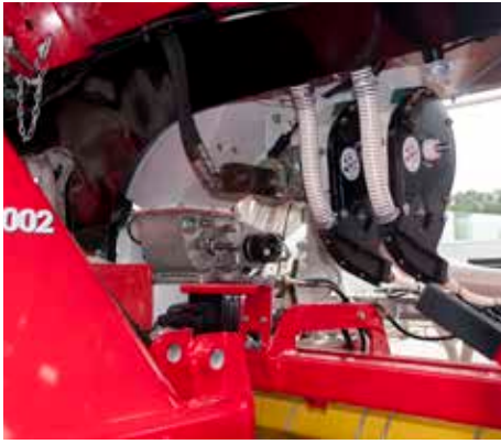
↳ De hydraulisch aangedreven doseerunits verdelen het zaad in de luchtstroom afkomstig van de blazer.
