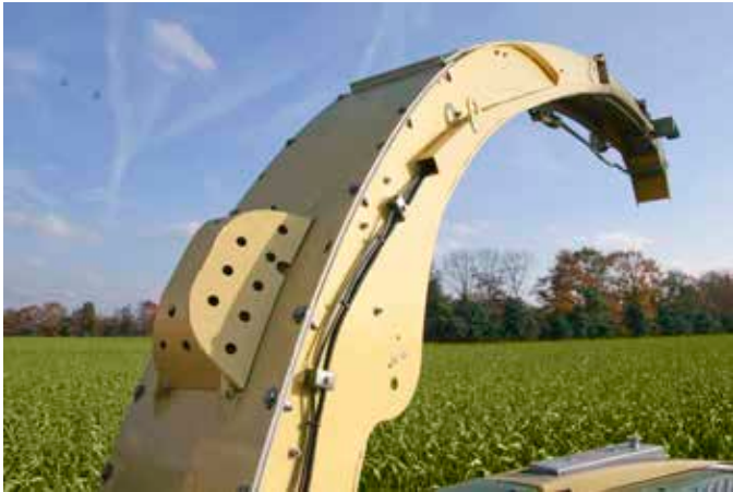
↳ De NIR-sensor op de uitwerppijp van de BIG X van Krone registreert gegevens over de vochtigheid van het geoogste product.
