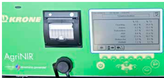
↳ Op het display van het mobiele NIR-analysetoestel van Krone kunnen na enkele minuten de voedingsstoffen van het gewasstaal worden afgelezen.
