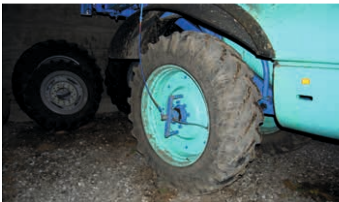
↳ Naast de trekker is ook de spuitmachine uitgerust met een bandendrukwisselsysteem, bedacht en geplaatst door Didier zelf.
