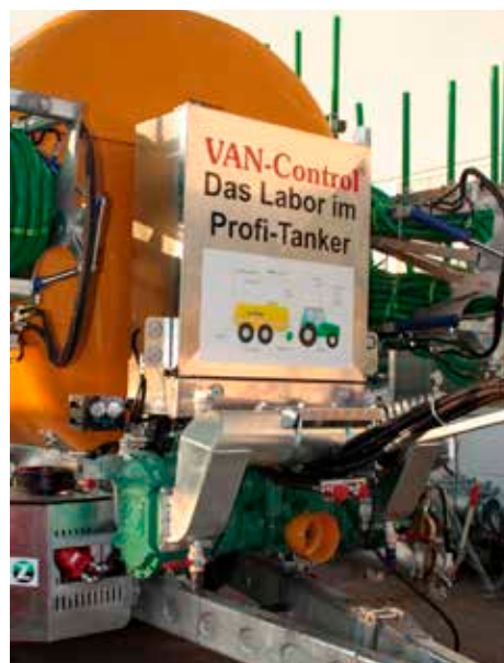
↳ De NIR-spectrometer op de drijfmesttank interpreteert de gegevens van de NIR-sensor en stuurt de uitgebrachte hoeveelheid nutriënten hierop aan.
