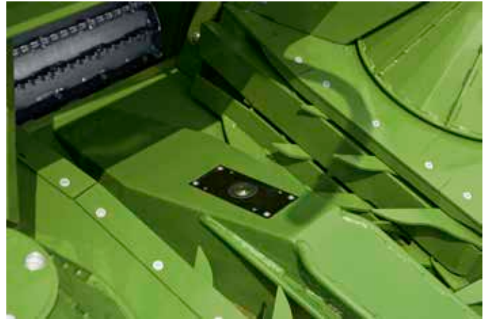
↳ De foto-optische cel in het midden van het voorzetstuk bij de BigX van Krone meet de rijpheidsgraad van de maïsplanten en zorgt voor de automatische aanpassing van de haksellengte.
