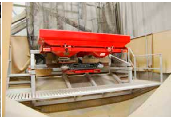
↳ De 'flow test' wordt statisch uitgevoerd en laat toe het debiet te meten dankzij weegcellen.
