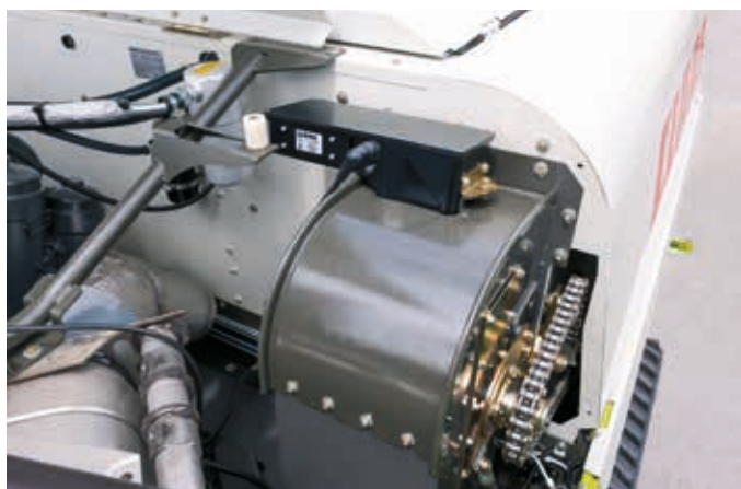
↳ De nieuwe Grain Quality Camera bovenaan de opvoerketting van het graan bij de Claas maaidorser helpt de chauffeur tijdens het rijden bij de controle van het geogste product.
