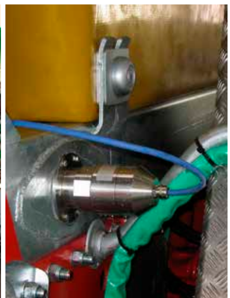
↳ De NIR-sensorkop van het VAN-Controlsysteem van Zunhammer meet bij het vullen van het vat de nutriëntenhoeveelheid in de mest.
