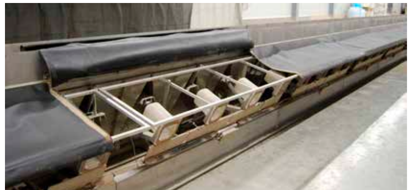
↳ De meststoffen worden opgevangen in meetbakjes van elk 50 x 50 cm.
