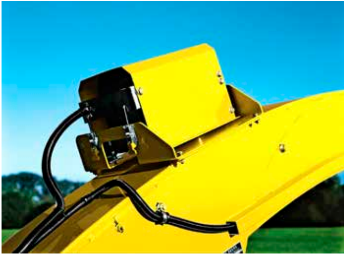
↳ De samen met Zeiss ontwikkelde compacte NIR-spectrometer bovenaan de uitwerppijp van de hakselaar van John Deere maakt een realtime analyse mogelijk en regelt de snijlengte i.f.v. het drogestofgehalte van de gewasstroam.
