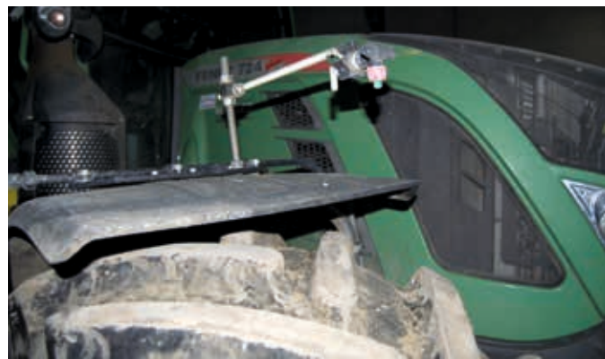
↳ Didier bevestigde spuitdoppen boven de voorwielen van zijn spuittrekker. Door Roundup te laten druppelen op de voorbanden blijven de spuitsporen onkruidvrij.
