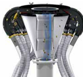
↳ Het IDS verdeelkop werkt in combinatie met een elektrische aandrijving van het verdeelwiel en zal ook op de andere pneumatische zaaimachines van het gamma kunnen gebouwd worden.
