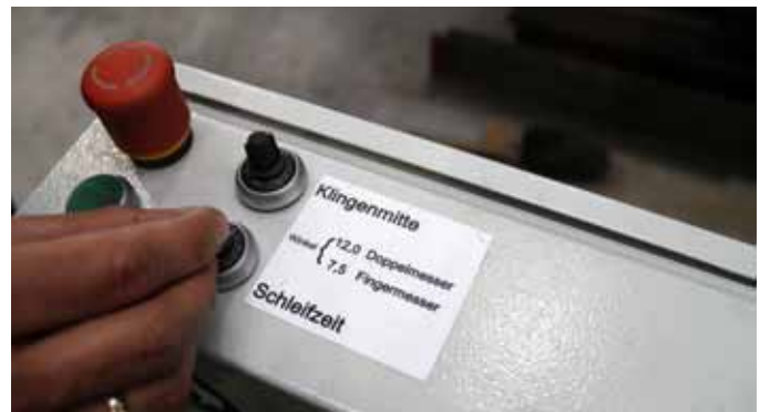
↳ Instelling van de slijptijd afhankelijk van de toestand van de mesjes.
