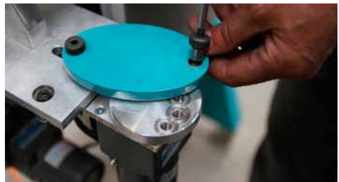
↳ Instelling van de gewenste slijpdikte afhankelijk van het messentype. ■
