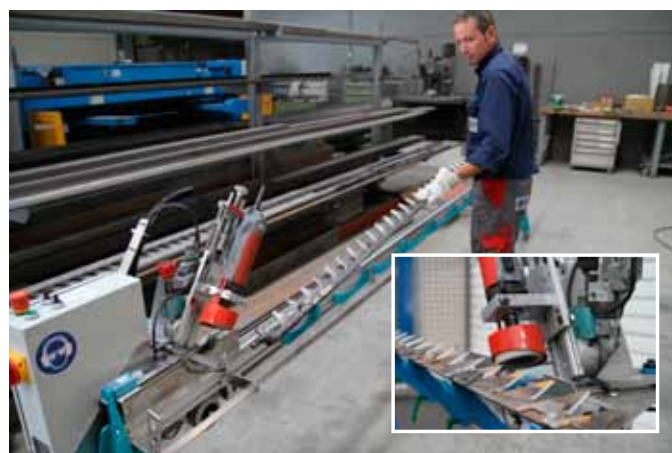
↳ Met de BBS-slijpmachine kunnen alle dubbele en standaardmessen in elke gewenste lengte worden geslepen.
