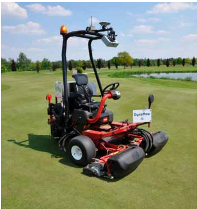
↳ Een van de eerste voorbeelden waar de X-pert-technologie werd ingezet was bij deze zelfrijdende greensmaaier van Toro.
