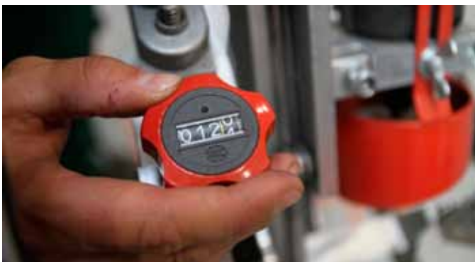
↳ Traploze instelling van de slijphoek tussen 20 en 45°.
