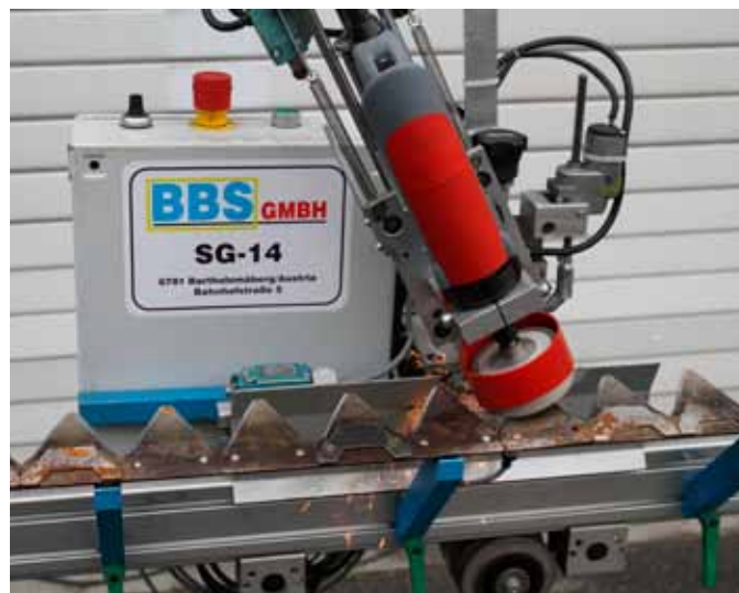
↳ Met de messenslijpmachine van BBS wordt het slijpen van hele maaibalken kinderspel.
