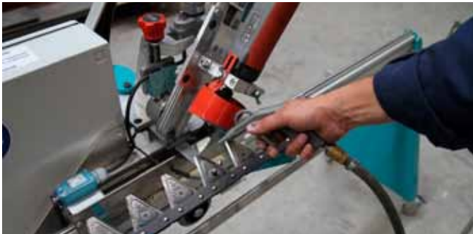
↳ La machine sera soufflée après chaque affûtage. Pour le reste, elle ne demande pas d'entretien particulier.
