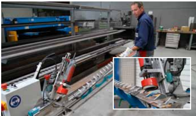
↳ L'affûteuse de couteaux de BBS permet d'affûter tous les lamiers de coupe à simple ou double couteaux.
