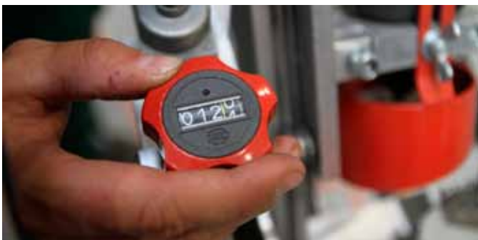
↳ L'angle d'affûtage se règle en continu, et entre 20 et 45°.
