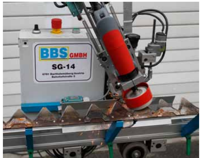
↳ Grâce à l'affûteuse de couteaux BBS, il devient très facile d'affûter des lamiers de coupe.
