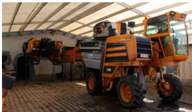
↳ De werktuigendrager, hier met opgebouwde plukunit, kan ook met een spuitopbouw, met een snoeieenheid of met een verdeler voor meststoffen worden uitgerust.
