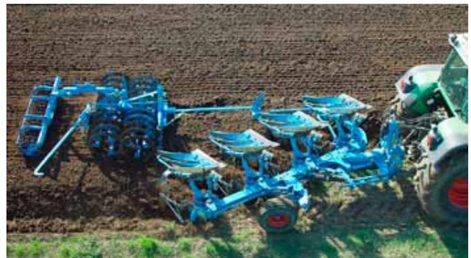
↳ Les packers équipés de bagues en acier utilisés derrière une charrue conviennent pour rappuyer le sol et favoriser le contact entre les différentes couches de sol.
