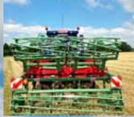
Cultivateur repliable hydraulique
