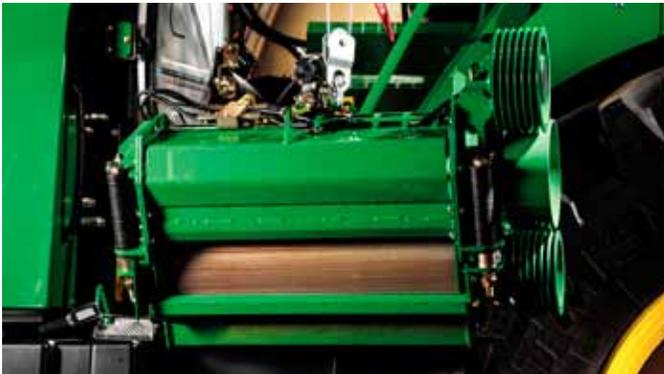
'Les rouleaux éclateurs peuvent pivoter vers l'extérieur sans outils, et se montent et se démontent très rapidement', promet John Deere.
