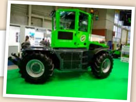
Les constructeurs de tracteurs compacts se livrent une sérieuse concurrence, ce qui se traduit par un design de plus en plus provocateur. Ce BCS Sky Jump 950 Dualsteer particulièrement stylé est équipé d'un moteur diesel VM de 91 ch, une transmission 16/16 et se démarque par la combinaison d'un châssis articulé et d'une direction sur les roues avant.
