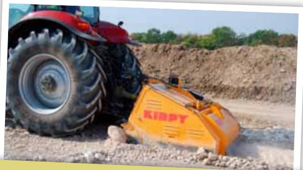
La porte arrière à commande hydraulique permet de régler la granulométrie de la matière sortant de la machine.
