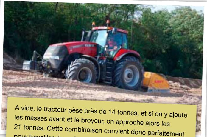
A vide, le tracteur pèse près de 14 tonnes, et si on y ajoute les masses avant et le broyeur, on approche alors les 21 tonnes. Cette combinaison convient donc parfaitement pour travailler dans des conditions difficiles.
