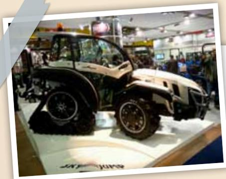
Le Claas Atos a été une des surprises de l'Eima. Cette gamme de tracteurs comporte six modèles équipés de moteurs Deutz développant de 76 à 109 ch. Il s'agit de tracteurs relativement simples qui sont équipés d'une transmission mécanique avec doubleur ou tripleur sur le modèle le plus puissant. Ces tracteurs sont construits chez Same Deutz-Fahr.
