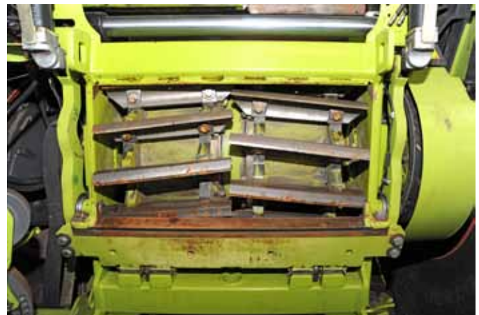
↳ De hakseltrommel van een Claas Jaguar 940. In de toekomst kunnen hier akoestische sensoren online de toestand van de hakselmessen registreren en doorgeven.
