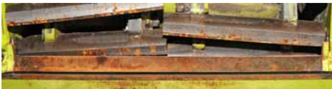
↳ De snijruimte oftewel afstand tussen de messen op de trommel en het tegenmes is een instelling die al te vaak onderschat wordt als kwaliteits- en kostenfactor.
