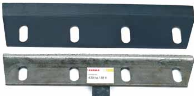
↳ Een nieuw scherp trommelmes (boven) en een gebruikt bot mes na 88 trommeluren op een perceel van 439 ha.
