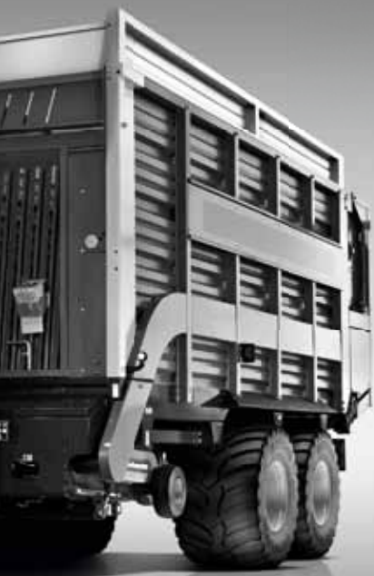
↳ De originele combi-oplossing TSMÜ 240-7 L van Demmler is een afschuifwagen met overlaadfunctie. De bak kan bij het overladen tot op een hoogte van 4,5 meter opgetild worden.
