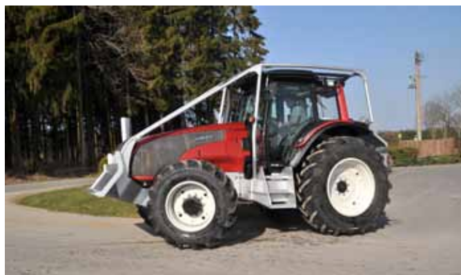
↳ Voor de bosbouwklanten worden volledige tractorbeschermingen, schuifbladen en bosbouwklemmen ontwikkeld en gebouwd. →
