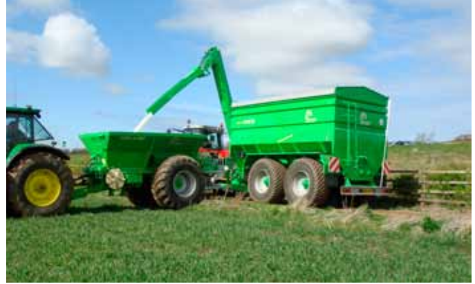
↳ Met een overlaadwagen kan niet alleen graan vlot en met respect voor de bodem van het veld worden gevoerd. Hij zorgt ook voor meer ha/uur bij het meststofstrooien en het zaaien. Hier een overlaadwagen met verlengde uitlaatvizel bij het vullen van een meststofstrooier. Met dezelfde voorziening kunnen ook zaaimachines gevuld worden.
