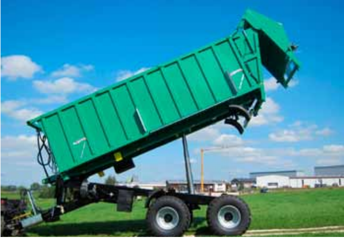
↳ De originele combi-oplossing TSMÜ 240-7 L van Demmler is een afschuifwagen met overlaadfunctie. De bak kan bij het overladen tot op een hoogte van 4,5 meter opgetild worden.
