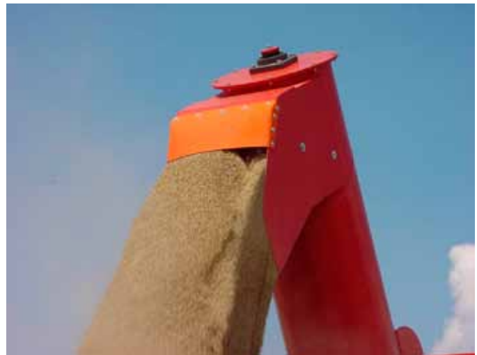
↳ Met een doormeter van 550 mm kan de overlaadwagen van Annaburger lossen aan een debiet van 15 m 3 /minuut bij 1000 toeren van de aftakas.
