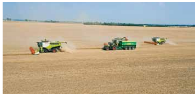
↳ 20 tot 30 % meer capaciteit is de nettowinst die met een overlaadwagen kan worden gerealiseerd. Uitgangspunt is daarbij een goed geregelde planning voor de maaidorsers en overlaadwagen.
