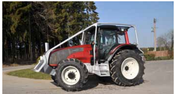
➤ Pour les clients forestiers, des blindages et carénages de tracteurs, de même que des lames avant ou des pinces de débardage, sont développés et construits en main propre. ➔
