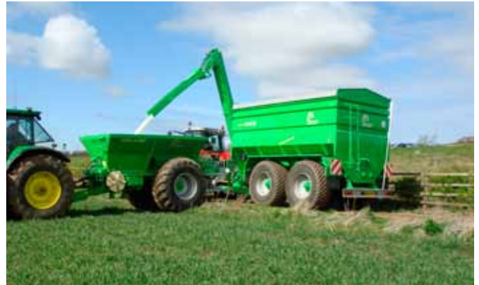
↳ Le transbordeur permet non seulement de transporter des céréales lors de la moisson, mais également d'augmenter le rendement horaire lors des semis ou de l'épandage d'engrais. On voit ici un transbordeur équipé d'une vis rallongée pour le remplissage d'un distributeur d'engrais. Le même équipement permet de remplir facilement un semoir. →
