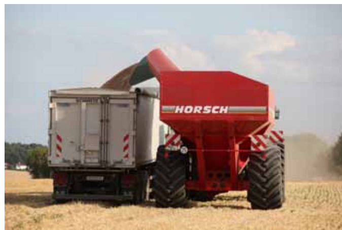
► La nouvelle vis de vidange de 60 cm de diamètre et à repliage hydraulique du transbordeur Titan UW de Horsch permet de transborder 18 tonnes par minute ou 1.000 tonnes par heure. Les 34 m 3 de la caisse sont transbordés en seulement 90 secondes.
