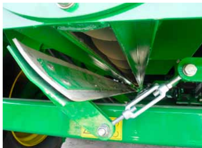
► Sur le transbordeur Güstrower, la trappe de nettoyage s'ouvre sur toute la longueur de la caisse. Cela facilite le nettoyage de la machine lors de l'utilisation de semences ou lors du passage de la configuration céréales à la configuration engrais.
