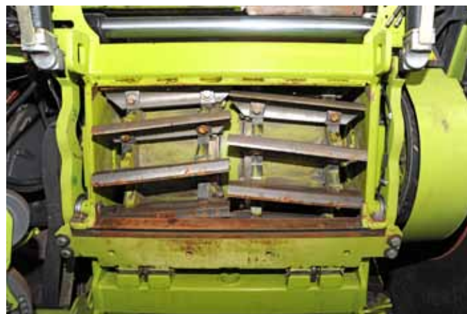
↳ Le tambour hacheur d'une Claas Jaguar 940. A l'avenir, des capteurs acoustiques pourront enregistrer et informer en temps réel sur l'état des couteaux de l'ensileuse.
