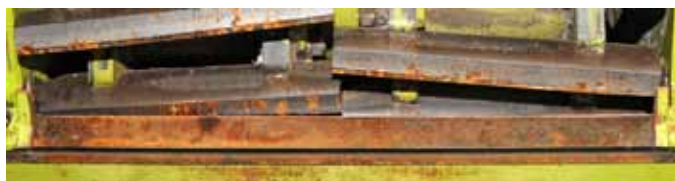
↳ Le réglage de la distance entre les couteaux et le contre-couteau est un facteur encore trop souvent négligé en termes de qualité et de coûts.
