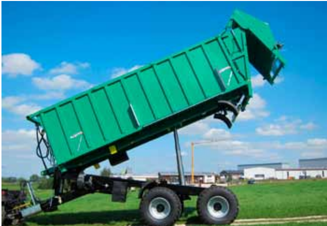
↳ Le transbordeur TSMÜ 240-7 L de Demmler combine une caisse à fond poussant et un transbordeur. La caisse peut monter jusqu'à une hauteur de 4,5 m pour le transbordement.
