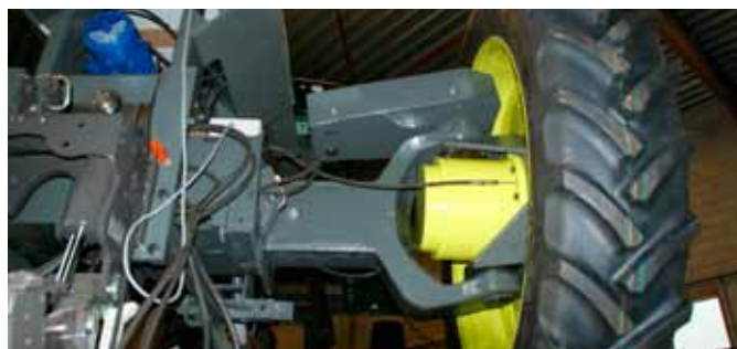
↳ De wielbasis is 5,50 meter en de bodemvrijheid bedraagt 80 centimeter onder de assen. →
