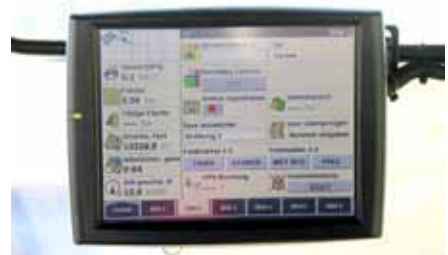
↳ De Split-Monitor-functie bij het AFS Pro 700 systeem van Case IH maakt het de gebruiker mogelijk om de zes beeldschermvensters van het complete scherm individueel te configureren.
