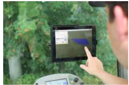
↳ De nieuwe App CCI Control Mobile voor tablets en smartphones documenteert voor het eerst op mobiele toestellen procesgegevens van ISOBUS-trekkers, -werktuigen en -zelfrijders.
