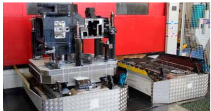
↳ Het machineren van en transmissiehuis duurt ongeveer 4 uur.
