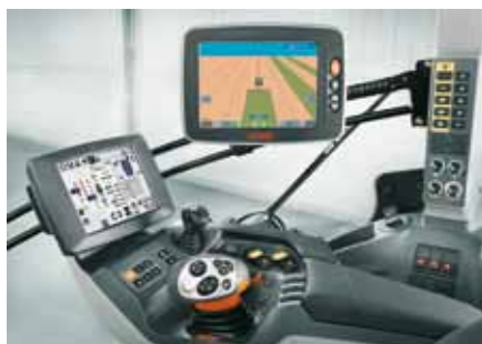
↳ De nieuwe S10 terminal maakt deel uit van het EASY-pakket (Efficient Agriculture Systems) van Claas. Onder deze naam brengt Claas zijn complete elektronica knowhow samen. Het touchscreen toont naar keuze aparte toepassingschermen, geeft schermvullende beelden van de camera weer, drie schermen met verschillende toepassingen of alle vier de camerabeelden tegelijk in een scherm.
