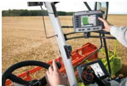
↳ De Cebis Mobile van Claas kan met alle ISO-geteste machines communiceren, van werktuig in de hef tot zelfrijdende hakselaar. De ingave verloopt via toetsen.
