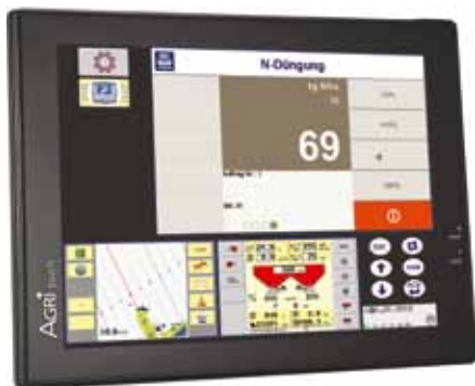
↳ Het bedieningsconcept van de Agri Touch terminal maakt het mogelijk om instellingen aan een toepassing uit te voeren zonder daarbij de andere toepassingen uit het oog te verliezen.
