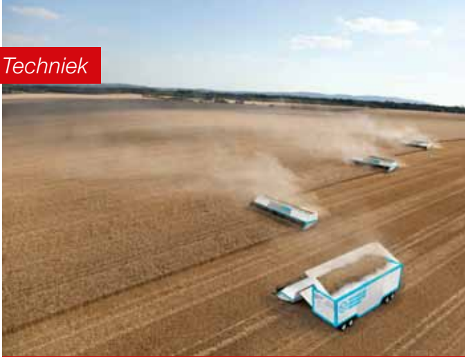
Modulair systeem met stationair dorsen aan de rand van het veld. Bron: TU Dresden
