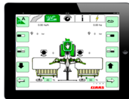
↳ Dankzij de nieuwe App 'Universal Terminal ISOBUS' (UT APP) van Claas is de landbouwer in staat om de functies van het ISOBUS-systeem op zijn tablet-PC te activeren.
