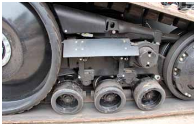
↳ Het onderstel: versterkt voor het hogere vermogen.
