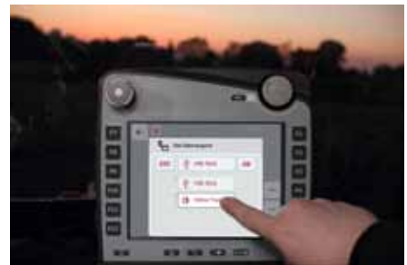
↳ Bij veldwerk 's nachts beschermt een 'nachtmodus' zoals hier bij de CCI-terminal de ogen. Door middel van een omgevingslichtsensor past de helderheid van het scherm zich automatisch aan.
