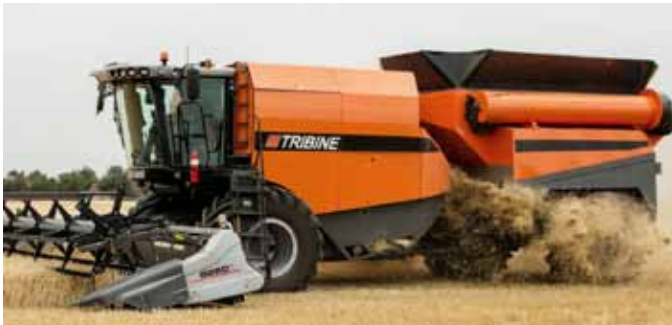
De Tribine-maaidorser met aangebouwde graantank. Het concept van de machine heeft als voornaamste bedoeling de bodemverdichting te beperken. (Ben Dillon)
