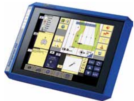
↳ De field-operator 450 van WTK-Elektronik is een universele ISOBUS-terminal. Nieuw is zijn gebruiksvriendelijke oppervlakte met Triple-Action-Touchscreen.
