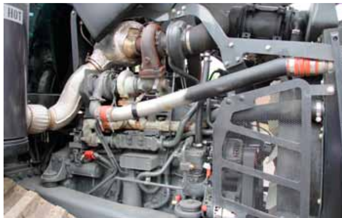
↳ De 7-cilinder Agco Powermotor met 9,8 liter inhoud uit Finland.
