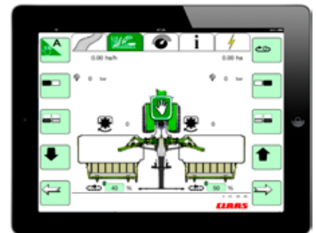
↳ Grâce à la nouvelle App 'Universal Terminal ISOBUS' (UT APP) de Claas, l'utilisateur peut à présent activer les fonctions du système ISOBUS sur sa tablette.
