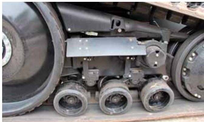
↳ Le train roulant a été renforcé pour les puissances plus élevées.
