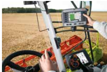
↳ Le Cebis Mobile de Claas peut communiquer avec toutes les machines testées ISO, du simple outil à l'ensileuse automotrice. Des touches permettent d'activer les fonctions.
