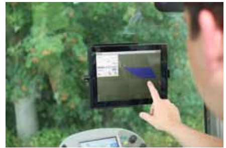
↳ La nouvelle App CCI Control Mobile pour tablettes et smartphones documente pour la première fois sur des appareils mobiles les données de tracteurs, outils ou automoteurs ISOBUS.
