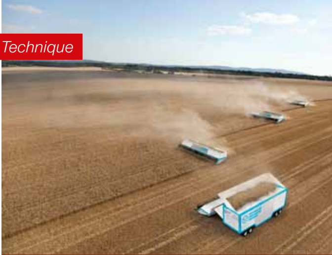
Système modulaire de battage stationnaire en bordure de champ. Source: TU Dresden
