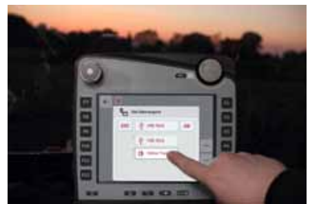
↳ Pour le travail de nuit, un mode spécial permet de protéger les yeux, comme ici sur le terminal CCI. Un capteur de lumière adapte automatiquement la clarté de l'écran.
