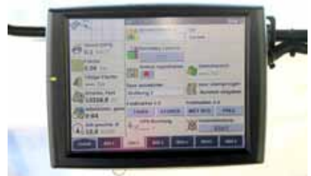
↳ La fonction Split-Monitor sur le système AFS Pro 700 de Case IH offre à l'utilisateur la possibilité de configurer jusqu'à six fenêtres de manière individuelle.
