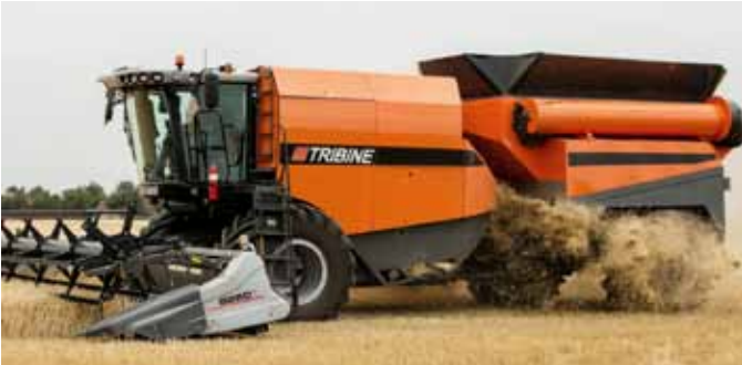
La moissonneuse Tribine à trémie tractée. Le concept de cette machine a pour principal but de réduire tant que possible la compaction du sol. (Ben Dillon)
