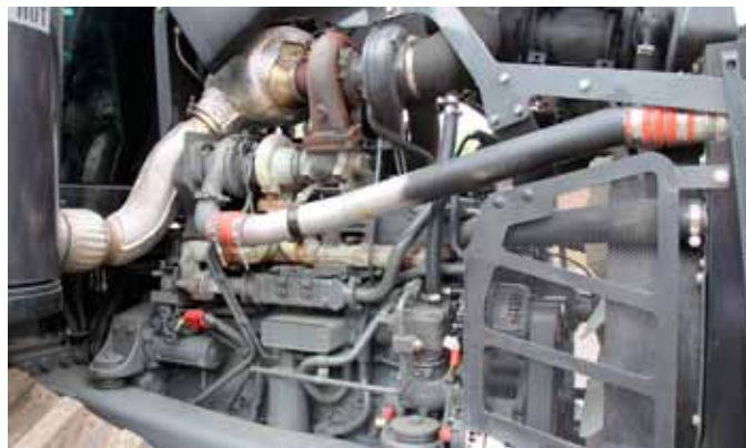
↳ Le moteur Agco Power 7 cylindres de 9,8 litres originaire de Finlande.
