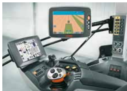
↳ Le nouveau terminal S10 fait partie du pack EASY (Efficient Agriculture Systems) de Claas. C'est sous cette appellation que Claas commercialise son savoir-faire en la matière. L'écran tactile affiche, au choix, les fenêtres d'applications, les images en provenance d'une caméra, trois écrans pour différentes applications ou les images provenant de quatre caméras en simultané.
