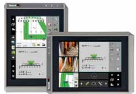
↳ Le terminal Touch 1200 de Müller-Elektronik dispose d'une interface tactile à commande intuitive, qui permet d'afficher simultanément jusqu'à 5 applications de manière verticale ou horizontale.
