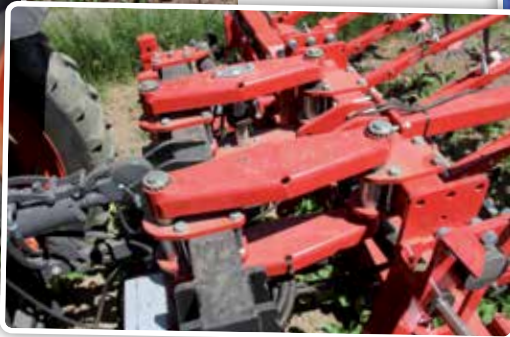
Het IC-Light systeem bestaat uit een camera, het verschuifbare frame en een terminal.
