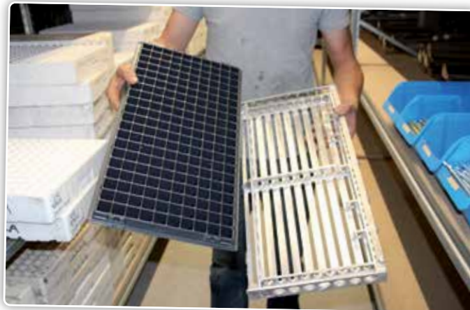
In samenwerking met Canadese vollegrondsgroentetelers ontwikkelde Agriplant een speciale aluminium behuizing voor hun trays.
