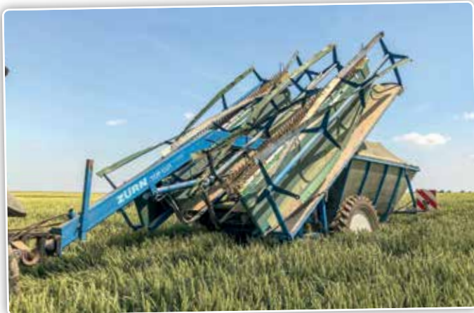
Voor transport over de weg worden de dwarsbanden opgeklapt, inclusief de messenbalken aan de zijkant van de machine. Hierdoor is de Top Cut Collect relatief smal: ingevouwen is hij minder dan 2,5 meter breed.
