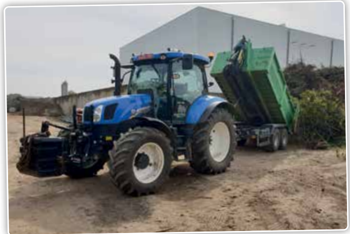
Het Pronar-containerhaaksysteem, waarmee hij groenafval en dergelijke afvoert.
