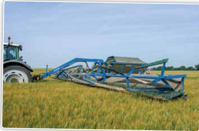
De Top Cut Collect combineert de processen van snijden (dubbel messensysteem), samenvoegen (haspel en transportbanden op de stempels) én verzamelen en verwijderen (bunkerband en opvangbunker met hoogtelediging).
