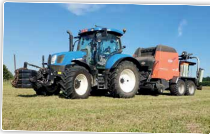
In de zomer is de hooibouw een belangrijk onderdeel van de werkzaamheden van Dasu. Dit jaar kocht de loonwerker een grote Kuhn 2160 perswikkelscombinatie voor het persen en wikkelen van grote ronde balen.
