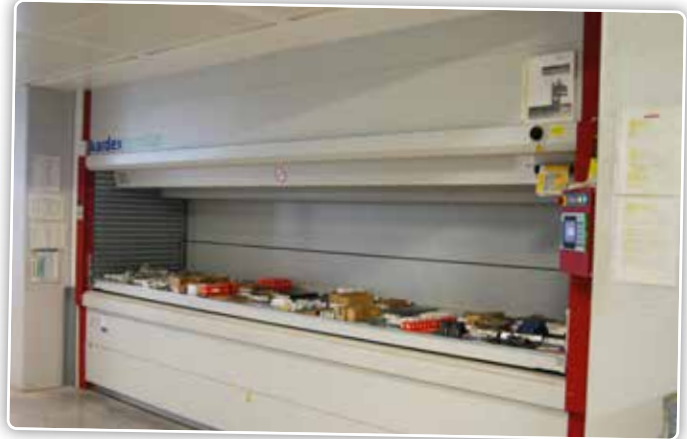
Een Kardex maakt het mogelijk om kleinere onderdelen efficiënt te stockeren.
