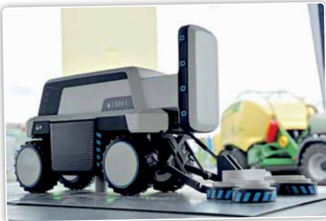
De autonoom werkende, elektrisch aangedreven plantagerobot Elwobot, die momenteel wordt ontwikkeld aan de TU Dresden, kan op elk moment worden geïntegreerd in een 5G-infrastructuur, net als miljoenen andere mobiele apparaten.
