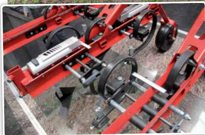
Met de EC-Space kunnen de schoffelelementen traploos worden ingesteld: manueel, elektrisch of automatisch.
