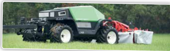
De 100 pk sterke Conver Greenbot is een volledig autonome tractor. Handmatige interventie op afstand zou alleen mogelijk zijn met 5G.
