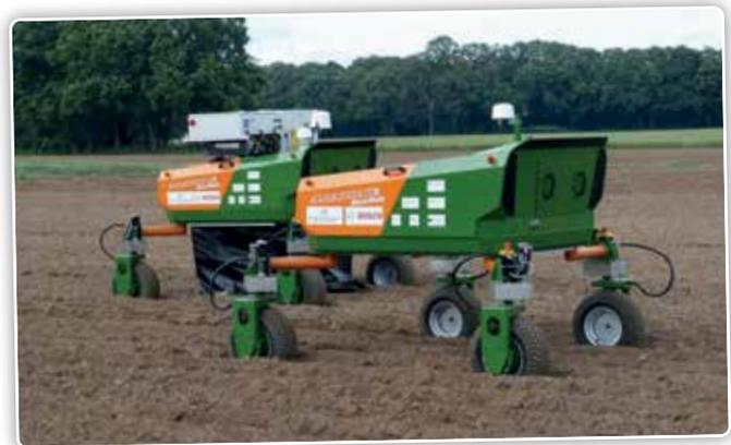
Un exemple est le projet EU Flourish dans lequel un drone pour identifier les tâches d'adventices est lié à un robot de terrain qui effectue indépendamment le travail de terrain nécessaire. De tels systèmes feront à l'avenir partie d'un 'Edge Cloud' temporaire.
