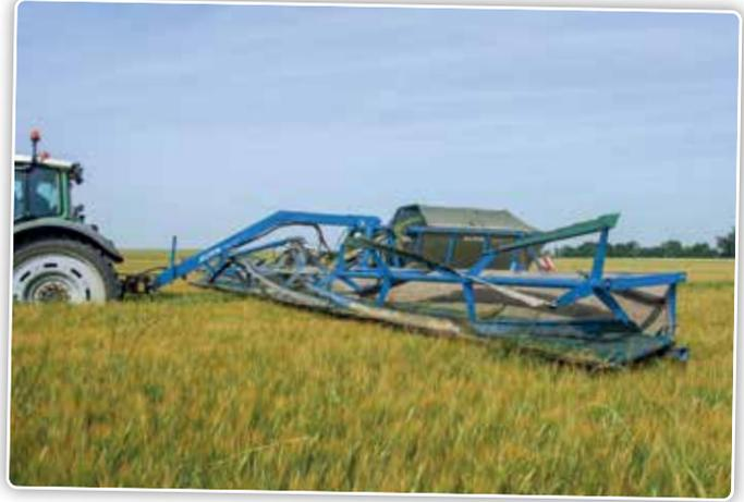
Le Top Cut Collect combine les procédés de coupe (système de double couteau), de collecte (rouleaux et tapis roulants) et d'évacuation (tapis et trémie de collecte).
