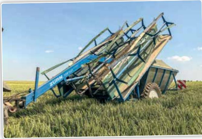
Pour le transport routier, les tapis d'évacuation et les couteaux sont repliés latéralement le long de la machine. De ce fait, cette dernière est relativement étroite et ne dépasse pas une largeur de 2,5 m en position de transport.
