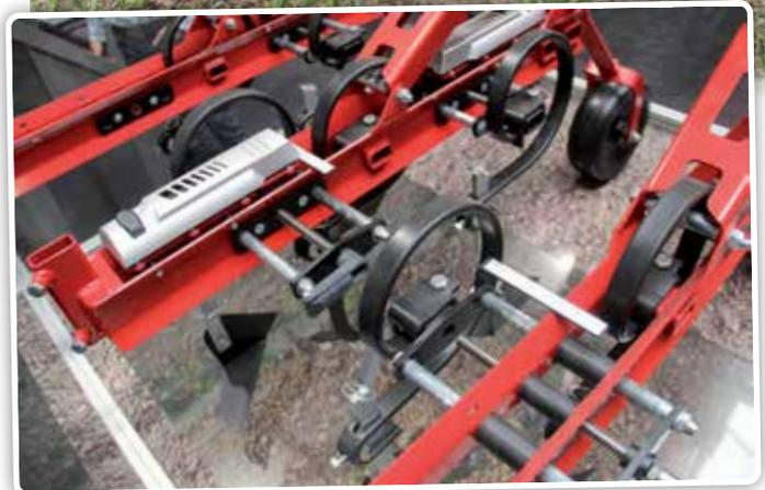
L'EC-Space permet d'ajuster en continu les éléments de binage en mode manuel, électrique ou par gps.
