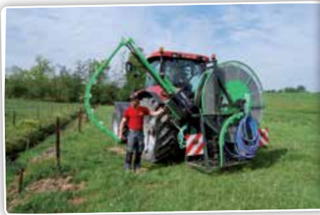
De geleidingsarm is uitgerust met hydraulische functies voor het in- en uitklappen, het in- en uitschuiven en de hoogteverstelling.
