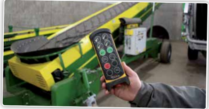
Ook de Vissers-inschuurlijn is bijzonder en helemaal op maat gemaakt. Het geheel is op afstand bestuurbaar met draadloze afstandsbediening.
