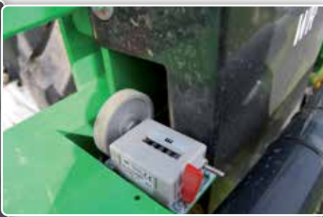
Een handige meterteller op de machine laat de gebruiker toe om exact te weten waar de verstopping zich bevindt.
