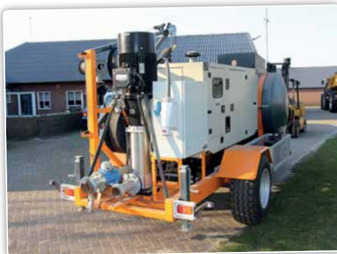
De schoonbroer van Huijbregts, Bram Wijnen, ontwikkelde een innovatieve beregeningspompset die via een app kan worden bestuurd en uitgelezen.
