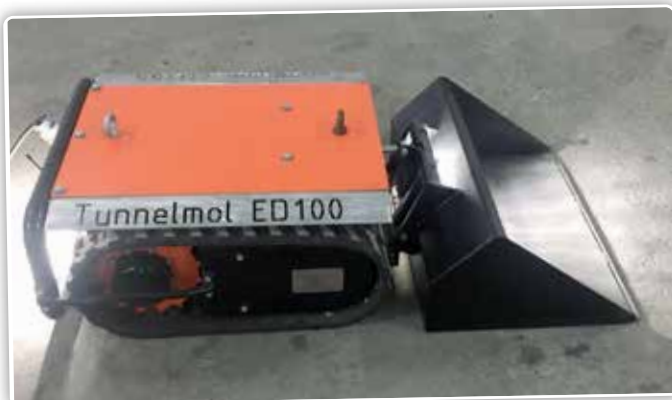
Nast de nieuwe pompset ontwikkelde zijn schoonbroer ook de Wijnen Tunnelmool ED 100, een kleine robot voor onder de ventilatieroosters.
