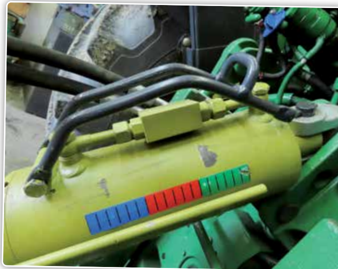
De lange grijpbeugel is zo gebogen dat hij de olieleidingen en de gestuurde terugslagklep beschermt.
