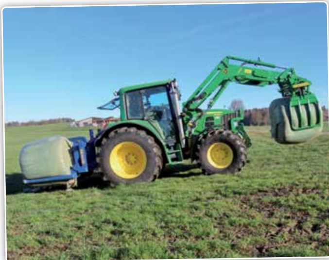
In de praktijk wordt de hydraulisch geveerde topstang bijvoorbeeld bij het transport van silagebalen ingezet. De tractor was geladen met 3 balen van in totaal 900 kg, twee achteraan en één vooraan.
