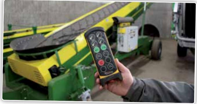
La ligne de stockage Vissers est également spéciale; elle a été construite entièrement sur mesure et est gérable à distance via une télécommande sans fil.
