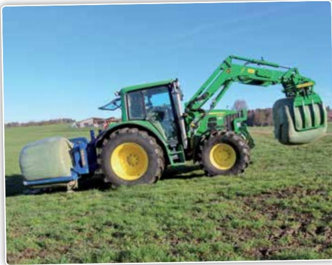
Dans la pratique, par exemple, le troisième point hydraulique est utilisé pour le transport de balles d'ensilage. Le tracteur transportait deux balles de 900 kg à l'arrière, et une troisième à l'avant.
