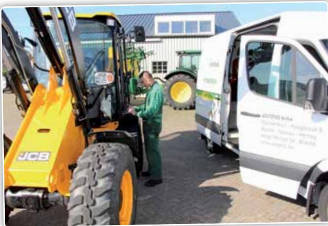
*M. Antens veut se concentrer sur ces systèmes de suivi et d'entretien, où vous pouvez voir avec précision la consommation de carburant, les heures et autres. De plus, le personnel est maintenant avisé 25 heures à l'avance si une machine a besoin d'un entretien.*
