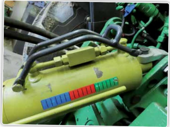
La longue barre d'attache est recourbée de telle sorte qu'elle protège les conduites hydrauliques et la vanne anti-retour.
