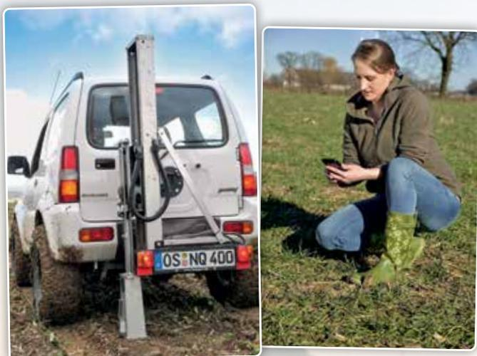
La prise d'échantillons de sol est de plus en plus automatisée. C'est la base pratique pour l'agriculture de précision.
