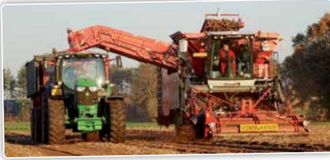
En 2018, M. Huijbregts a également acheté une nouvelle arracheuse automotrice quatre rangs Dewulf Kwatro avec son oncle. M. Huijbregts: 'Cette machine endommage très peu les pommes de terre.'
