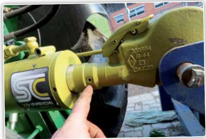
Le troisième point bénéficie d'un réglage d'usine à une pression de 60 bar. Si cette pression ne convient pas aux outils, elle peut être ajustée par un revendeur agréé.
