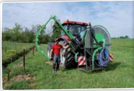
Le bras de guidage est équipé de fonctions hydrauliques pour le dépliage et le repliage, l'extension du bras et l'ajustement de la hauteur.
