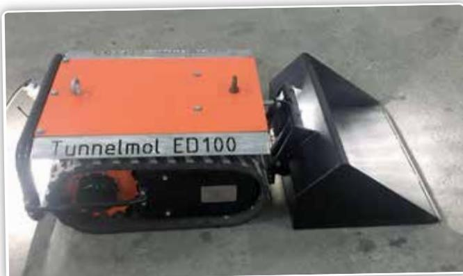
En plus de ce nouvel ensemble de pompes, M. Wijnen a également développé le Wijnen Tunnelmol ED 100, un petit robot qui se déplace sous les grilles de ventilation.
