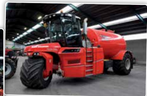
Precisiebemesting wordt steeds belangrijker. Bemesten doet het loonbedrijf met de Vervaet Hydro Trike die werkt met sectieafsluiting met afsluiting per twee doppen (dus zeer nauwkeurig).
