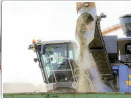
De geperste en afgekoelde pellets worden via een dwarsafvoerband gelost.
