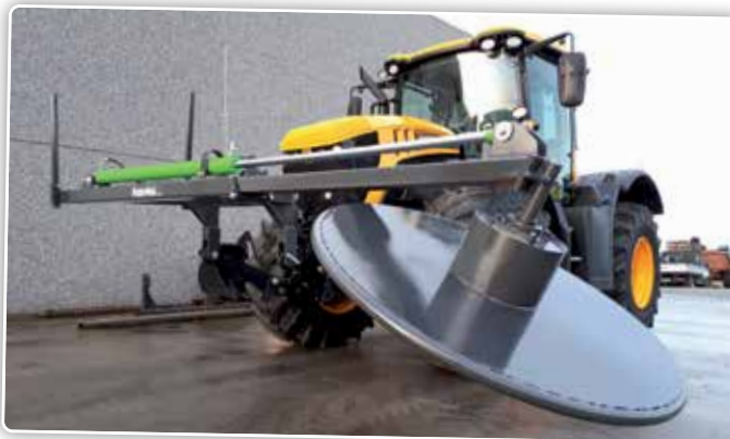
De Underbeet is de eenvoudige versie om een doek vast te leggen.
