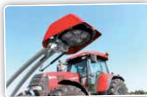
4 leds op elke arm bestralen het in te zaaien grasland.
