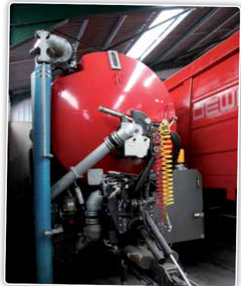
Op de recente mengmesttank van 24.000 liter is een gps-systeem voorzien, net als een weeg- en bemestingsstelsel.
