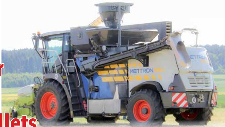
Avec le Metitron 560, le constructeur allemand CSP a développé le premier automoteur au monde qui produit des pellets. Krone les avait déjà devancés avec sa machine tractée de fabrication de pellets, la Premos 5000, tandis que le constructeur autrichien Schaidler avait de son côté présenté la Pelletec D 8.0. La base de la machine est une Claas Jaguar sur laquelle le constructeur CSP a développé une presse à pellets. Nous avons jeté un coup d'oeil sous le capot.
