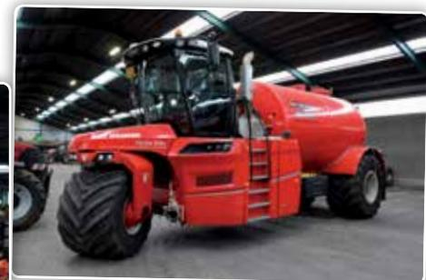
L'injecteur automatique de lisier Vervaet de Sprangers est équipée d'une coupure de sections, ce qui augmente la précision de l'épandage d'effluents.
