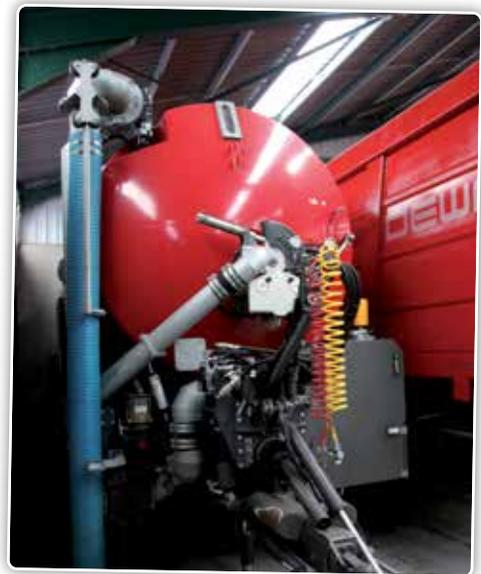
La récente tonne à lisier est dotée d'un système de gps, de même que d'un dispositif de pesée et d'échantillonnage.
