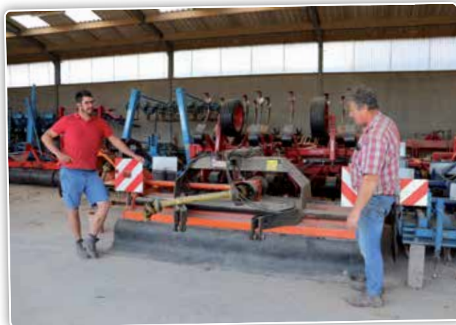
Vader en zoon Jackers bij de 3 m brede klepelmaaier van Perfect. De linkse en rechtse sideshift zorgen ervoor dat het klepelen van de groenbemester en het ploegen in één werkgang kunnen doorgaan.
