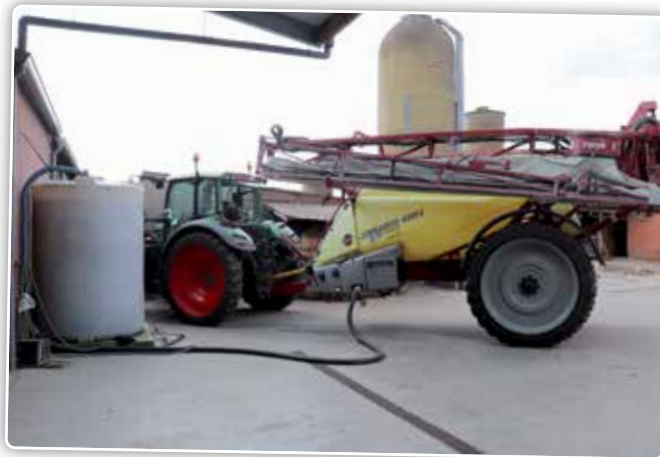
Dankzij een voorraadtank van 5.000 liter heeft de spuitmachine een grote autonomie.
