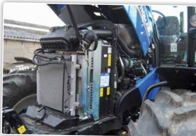
Als krachtbron kiest New Holland logischerwijze voor een NEF-blok van 4,5 liter met de HI-eSCR 2 technologie.
