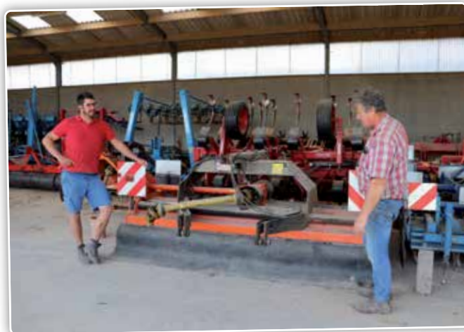
Le père et le fils Jackers avec le broyeur Perfect de 3 m de large. Les déplacements latéraux gauche et droit permettent de broyer l'engrais vert et de labourer en un seul passage.
