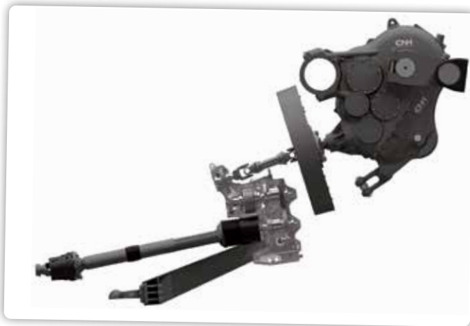
Le nouveau boîtier d'entraînement permet d'entraîner le volant et le piston plus en douceur.
