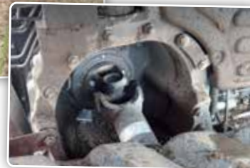
L'entraînement en lui-même est équipé d'un cardan entre le boîtier de transmission et l'axe entrant du TerraTrac.
