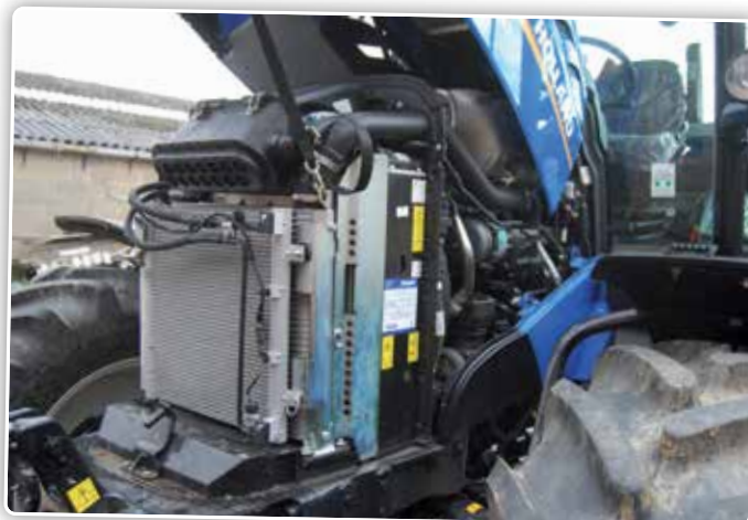
New Holland a logiquement opté pour un bloc moteur NEF de 4,5 litres équipé de la technologie HI-eSCR 2.
