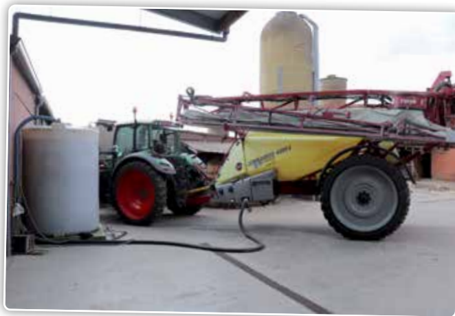
Grâce à une cuve de 5000 litres, le pulvérisateur a une grande autonomie.
