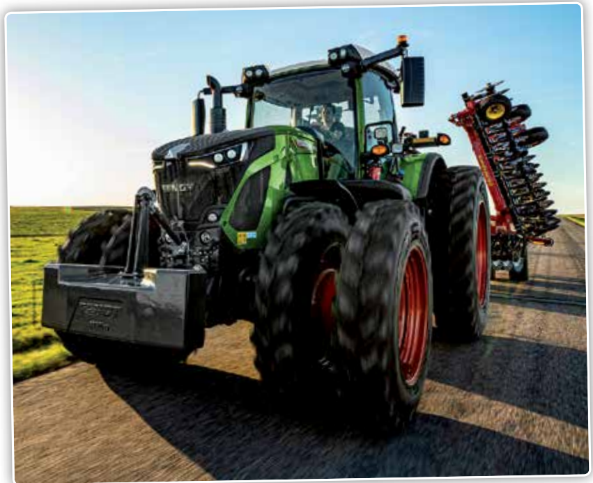
De nieuwe 900 heeft de koelventilator tussen radiator en motorblok staan. Daarom zijn er hier wel ventilatieroosters in de motorkap in vergelijking met de 1000 serie.
