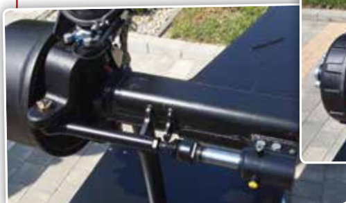
Hier een wiel voor een Horsch-spuitmachine al dan niet voorzien van een hoeksensor voor de wieluitslag.
