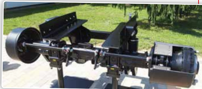
Neusje van de zalm is de BPW-as met hydraulische wielmotoren met twee snelheden. Voor de hydraulische motoren wordt samengewerkt met de Finse firma Black Bruin. Merk hier in het midden op de as de meetcel voor het weegsysteem.
