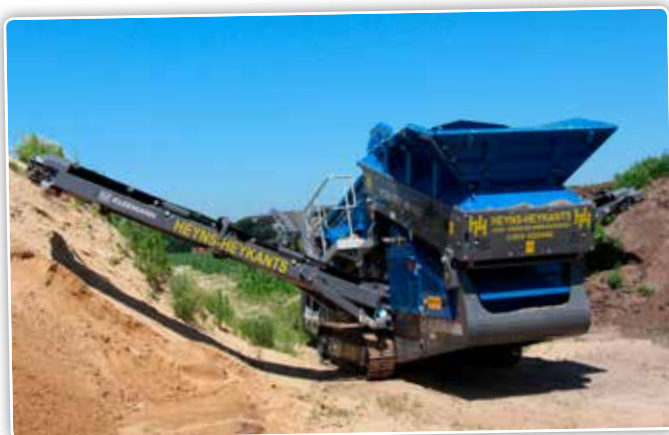
Met deze zeef wordt het grondoverschot, groenafval en puin gezeefd.
