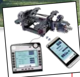
Eén sensor per as, twee toerentalsensoren, een sensor tussen dissel en trekkoog en dat alles verbonden met de AgroHub-computer.
