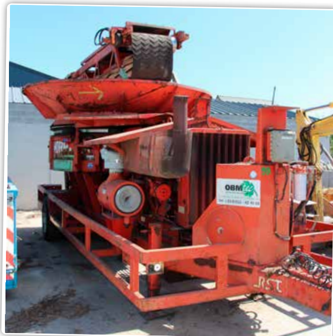
Dit jaar investeerde het bedrijf ook in een tweedehandse Amerikaanse Morbark voor het versnipperen van bomen. Hiermee kunnen volledige boomstronken tot één meter diameter worden geshredderd. Geert: 'We hebben gekozen voor een tweedehandse omdat we even willen aanzien hoe deze nieuwe bedrijfstak zich gaat ontwikkelen.'
