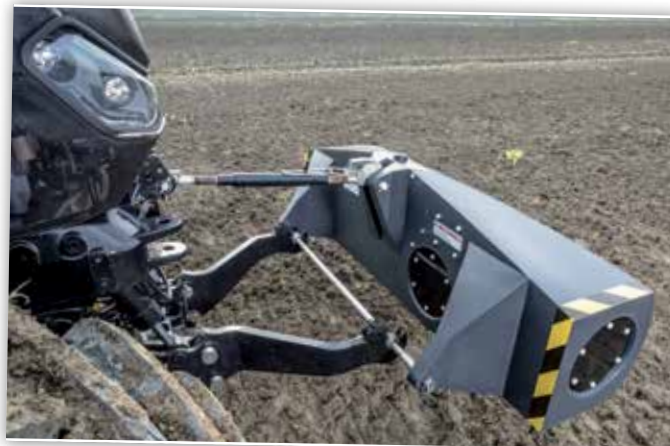
De bodemscanner is compact, weegt niet veel en is niet in contact met de bodem tijdens het meten.
