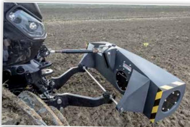
Ce scanner de sol est compact, léger, et n'entre pas en contact avec le sol pendant les mesures.
