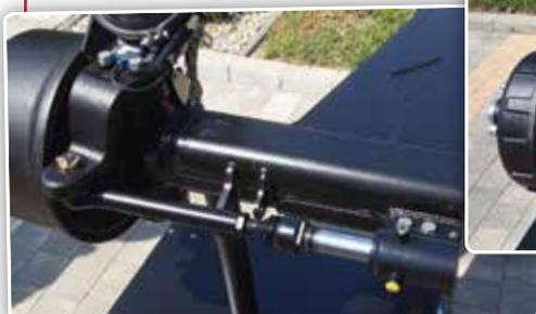
Une roue de pulvérisateur Horsch, qui peut être équipée d'un capteur d'angle pour adapter la direction.
