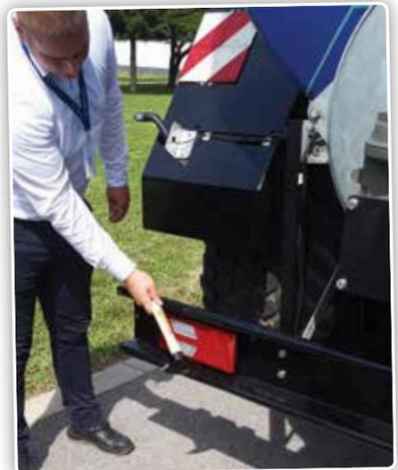
BPW produit des éclairages et des couvercles en polycarbonate qui sont si robustes qu'il n'est pas possible de les casser avec un marteau. Les feux LED sont équipés d'un dispositif au cas où les lampes de clignoteurs ou les feux de freinage tomberaient en panne. Ils sont disponibles en connexion 12 et 24 volts. Les connexions pour le câblage sont hermétiquement scellées contre l'eau et la poussière.
