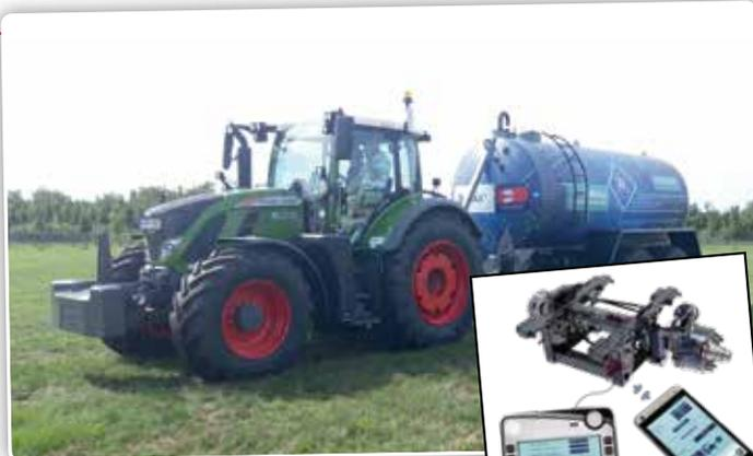
Un capteur par essieu, deux capteurs de vitesse et un capteur où l'œillet d'attelage et le timon se rejoignent sont reliés à l'ordinateur AgroHub.
