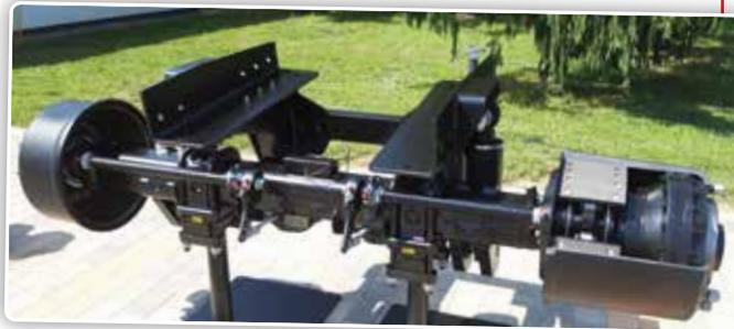
Un bijou de technologie chez BPW est l'essieu équipé de moteurs hydrauliques de roues à deux vitesses. Les moteurs hydrauliques viennent de la société finlandaise Black Bruin. On remarque également le peson du système de pesée.
