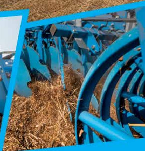
Le **Rubin 10** est un excellent choix de déchaumeur pour un travail à faible profondeur sur toute la largeur de l'outil. Avec son nouvel arrangement de disques symétriques, il apporte un mélange intense et homogène de la matière organique et du sol, même à des vitesses de travail élevées ! Découvrez ses nombreux autres avantages par vous-même :
