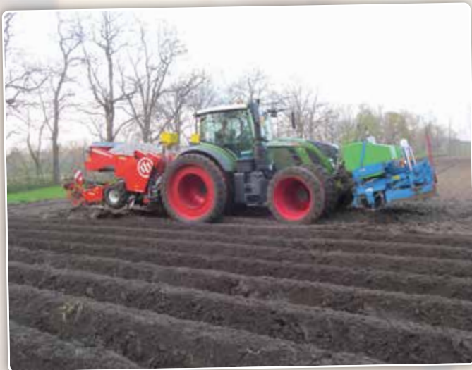
Poten gebeurt op de ploegsnede. De cultivator en pakker vooraan worden verzaaid door de container voor vloeibare meststoffen.
