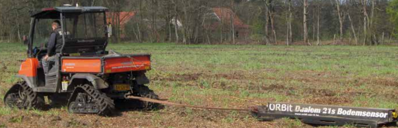
De basis van de zandbodem bij VDB: een bodemscanner geeft een beeld van het vochthoudend vermogen.
