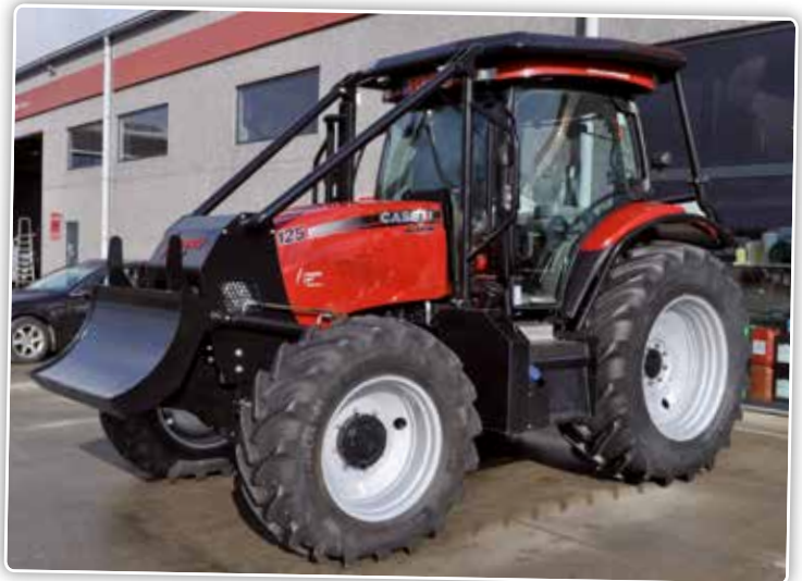
De las- en constructieafdeling bouwt onder meer bosbouwbeschermingen op maat.
