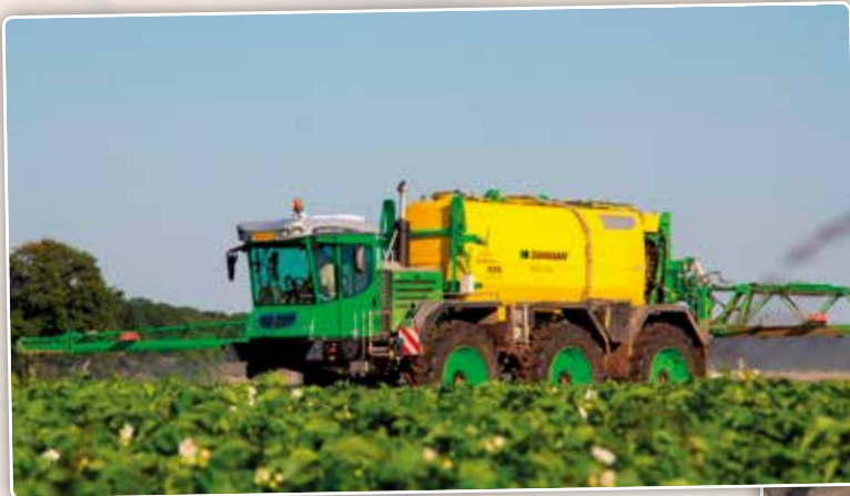
Het grootste deel van de gewasbescherming wordt uitgevoerd door vader Louis met deze zelfrijdende Damman, uitgerust met sensoren en dubbele spuitleiding.
