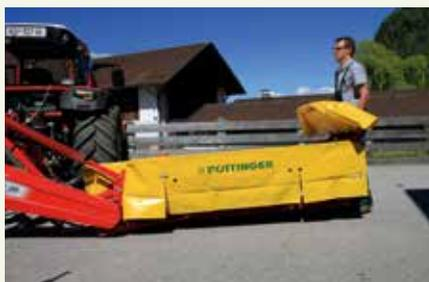
Lorsque le délestage est réglé correctement, il doit être possible de relever le bout de la faucheuse sans efforts.
