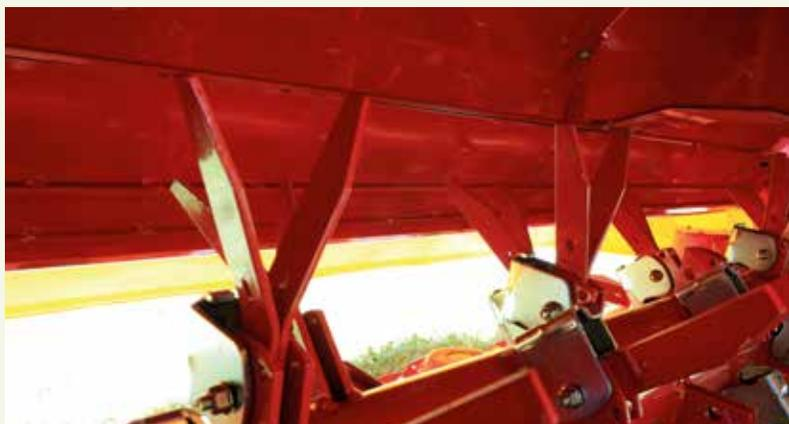
L'intensité de travail du dispositif conditionneur se règle en agissant sur le régime de rotation et/ou la largeur de passage. Attention cependant pour celui qui veut faire du foin: laisser travailler le conditionneur trop intensivement va augmenter le risque de pertes!
