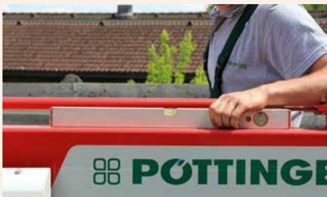
La principale différence réside dans le réglage du châssis. Ce dernier doit être placé à l'horizontale via les bras de relevage du tracteur. C'est uniquement ainsi que la cinématique des rotors travaillera correctement.
