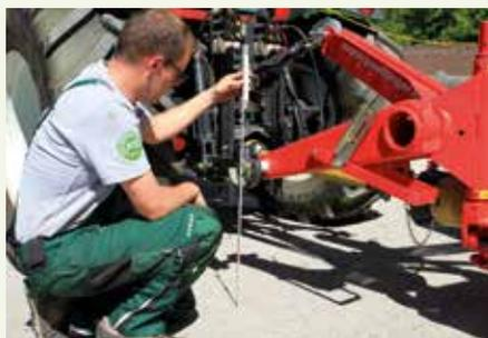
Le délestage, de même que la cinématique de relevage ou d'abaissement de la faucheuse ne fonctionnent que si la hauteur du relevage a été correctement réglée. A ce niveau, il faut bien suivre les consignes données par le constructeur.
