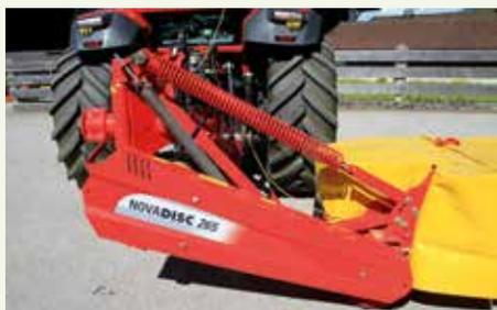
Lorsque le relevage arrière du tracteur est correctement réglé, le délestage de la faucheuse sera réglé. Ici également, il convient de suivre les conseils donnés par le constructeur.
