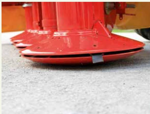
Lorsque l'on veut faucher plus haut, il faut modifier la distance entre le patin et le tambour. Suivant les marques, les constructeurs recourent à un système à manivelle, des bagues d'écartement ou des patins spéciaux.
