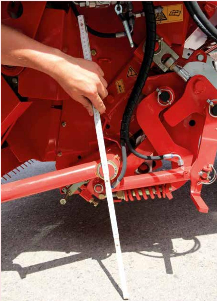
Afin que le ramasseur puisse suivre les inégalités du sol, il doit pouvoir bouger vers le haut et le bas. C'est uniquement possible si la hauteur d'attelage est correcte. Respectez les consignes données par le constructeur, soit dans le manuel d'utilisation, soit via les annotations sur le châssis.
