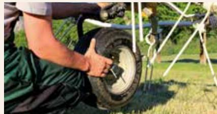
Le réglage de l'angle de travail permet d'optimiser le travail de la machine en fonction de la quantité d'herbe et du résultat de fanage voulu. Il sera alors parfois nécessaire de révéifier la hauteur de travail des dents.
