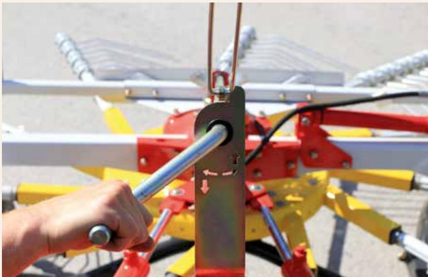
Après les réglages de base au niveau de la roue de jauge, on va ajuster la machine horizontalement par rapport au sens d'avancement à l'aide d'une manivelle. Le réglage fin de la hauteur est effectué via le châssis de l'andaineur.
