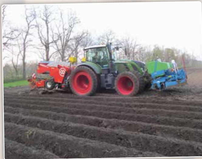
La plantation s'effectue directement sur le labour. Au-dessus de l'outil frontal, on retrouve la cuve pour les engrais liquides.
