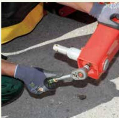
Les broches d'attelage pour les bras de relevage doivent être réglées latéralement. Elles vont déterminer la distance latérale par rapport aux roues et donc également le recouvrement par rapport à la faucheuse frontale.
