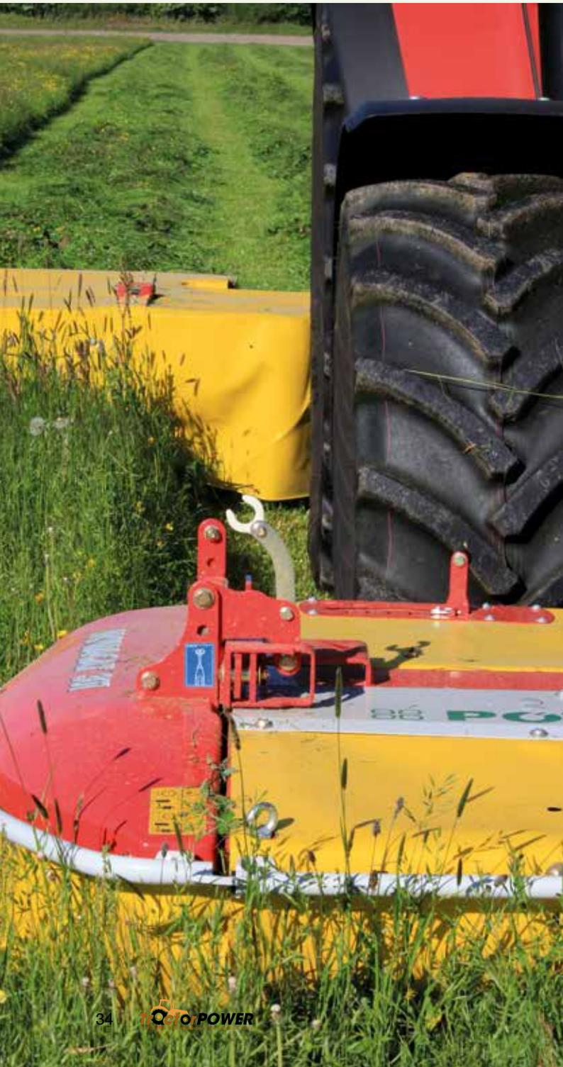
**La base pour la récolte d'un fourrage de bonne qualité est un réglage correct de la faucheuse. Le réglage de la hauteur de coupe et du délestage du lamier de coupe déterminent la qualité du travail de la faneuse et de l'andaineur qui suivent. Une fauche correcte permet par ailleurs de diminuer les pertes, de même que le taux d'impuretés dans le fourrage.**
