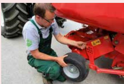
Le réglage de hauteur est réalisé à l'aide des roues de jauge montées à gauche, à droite, et souvent aussi à l'arrière du ramasseur. La distance entre les dents et le sol doit être d'au moins 3 centimètres.
