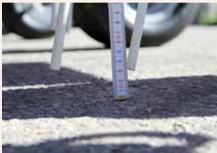
Le réglage de la hauteur de travail : à leur point le plus bas, les dents doivent respecter un dégagement minimal de 3 cm par rapport au sol.
