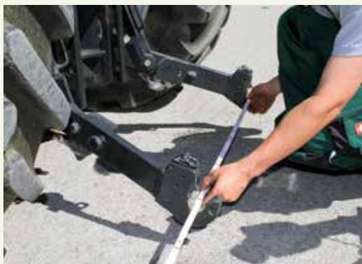
Avant d'atteler la faucheuse, il faut régler la largeur entre les bras de relevage à l'aide des stabilisateurs latéraux en fonction de la largeur d'attelage de la faucheuse. Ensuite, les deux bras de relevage doivent avoir la même hauteur.
