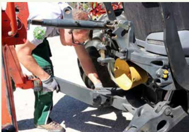
Les bras inférieurs du relevage avant seront placés en position fixe ou flottante suivant que l'on travaille avec une faucheuse équipée d'un cadre d'attelage tiré ou poussé. A ce niveau, il est conseillé de consulter le manuel d'utilisation.
