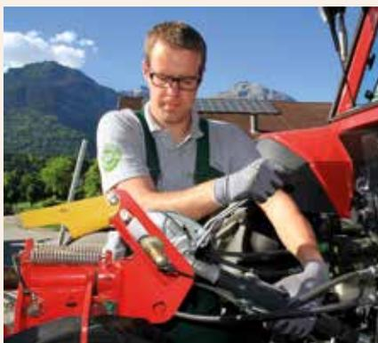
La longueur du troisième point doit être réglée de telle façon que la faneuse puisse tant bouger librement vers le haut que vers le bas, et donc en position centrale dans le trou oblong. Lorsqu'il n'y a pas de roue de jauge, le réglage de la hauteur de travail s'effectue avec le troisième point en position fixe.
