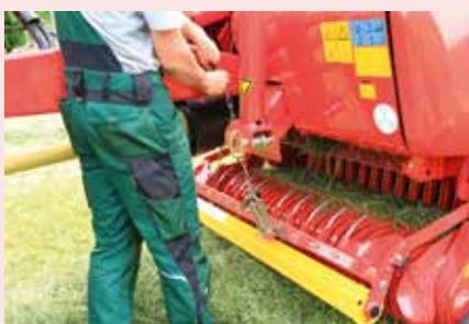
La distance avec le rouleau supérieur qui guide les andains dépendra de la quantité de fourrage à récolter. Le but de ce rouleau est en effet de guider le flux de fourrage. S'il est réglé trop haut dans de petits andains, il ne va pas faciliter la reprise de ces derniers. De même, s'il est réglé trop près du ramasseur dans de grands andains, il va compliquer la reprise de ces andains au lieu d'accompagner le flux.
