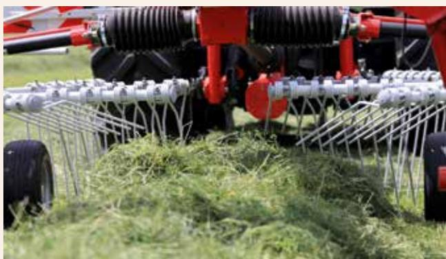
La largeur de l'andain doit être adaptée à la largeur du ramasseur de la machine qui suit. L'andain doit avoir une forme trapézoïdale avec des flancs fortement inclinés afin de faciliter la reprise à l'aide du ramasseur. Des flancs trop plats seront aplatis par les roues du tracteur, et ne seront donc pas ramassés de manière optimale.
