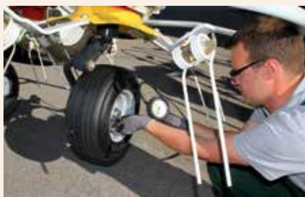
Avant de commencer à travailler, il faut s'assurer qu'aucune dent n'est cassée, que leur angle de travail est correct, que le dispositif anti-perte de dents fonctionne et que la pression de gonflage des pneumatiques est correcte.
