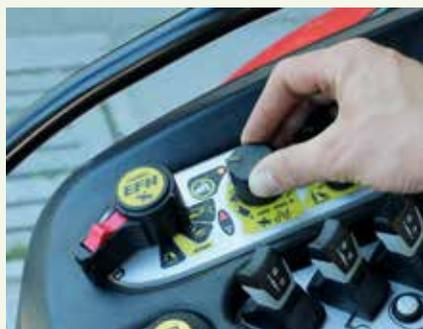
Lorsque le tracteur est équipé d'une commande électronique du relevage avant, il est possible d'adapter la pression de la faucheuse au sol en fonction des conditions. Lorsque la faucheuse ne porte pas assez, elle aura tendance à sautiller, ce qui se traduit par une fauche beaucoup moins précise.
