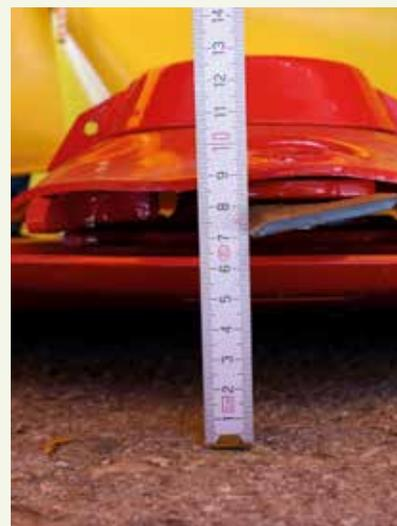
Lorsque la faucheuse est réglée à l'horizontale, la hauteur de coupe est d'environ 7 cm. On peut l'augmenter ou la diminuer quelque peu ( $\pm 2$  cm) en agissant sur la longueur du troisième point.
