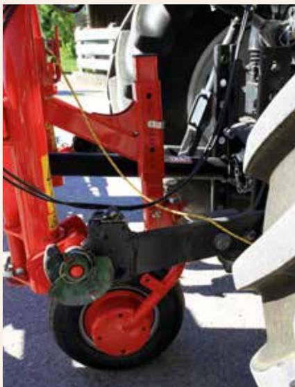
Si une roue de jauge est présente, le réglage de la hauteur se fait via la roue de jauge montée sur le cadre d'attelage. Les réglages se feront de préférence sur un sol plat.
