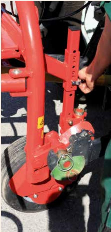
Tout comme pour la faneuse, la hauteur des roues de jauge se règle sur une surface en dur: on contrôlera la distance entre les dents et le sol à l'avant de la machine, au plus près de la roue de jauge.
