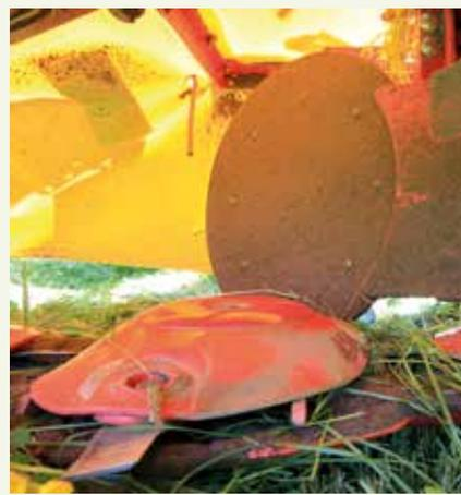
Les déflecteurs d'andains permettent de déposer l'herbe en andains et entre les roues du tracteur.
