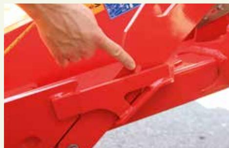
Vous trouverez des conseils sur la hauteur correcte du relevage dans le manuel d'utilisation ou sur les autocollants sur la faucheuse. Les marquages comme sur la photo ne servent qu'à titre de contrôle.
