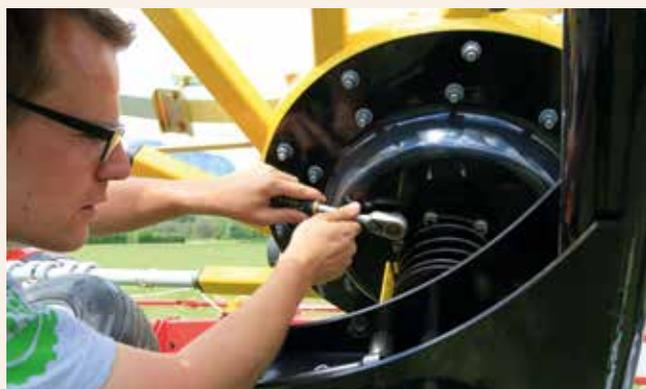
La forme de l'andain peut être influencée par le chemin de roulement. Si les côtés sont trop plats, on adapte le chemin de roulement afin que les dents se relèvent un peu plus tard. Le fourrage sera alors davantage déposé au centre de l'andain.
