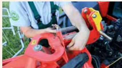
De plus en plus de faneuses portées sont équipées d'un kit de transport avec des roues arrière. Lors du passage de la position de transport à la position de travail, il faut relever cet essieu.
