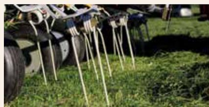
Au champ, il est nécessaire de contrôler une nouvelle fois la hauteur de travail en fonction de la hauteur de coupe. Cela se fera le plus facilement en roulant d'abord pendant quelques mètres afin que la machine trouve sa position de travail, et en mesurant ensuite la distance entre les dents et le sol. Les dents ne peuvent en aucun cas entrer en contact avec le sol.
