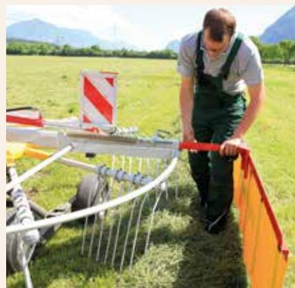
La bêche à andains peut être réglée en largeur, en hauteur et bien souvent aussi dans le sens de la longueur. La largeur de l'andain doit être adaptée en fonction de la quantité d'herbe et de la largeur du ramasseur de la machine qui suit.
