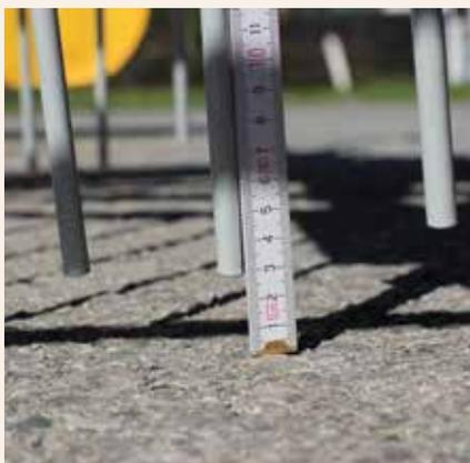
Il faut respecter une distance minimale de 3 cm entre les dents et le sol. Il est important de contrôler à nouveau ce paramètre au champ.
