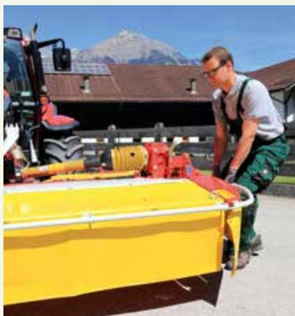
En relevant la faucheuse d'un côté, on peut tester le fonctionnement des ressorts de délestage.
