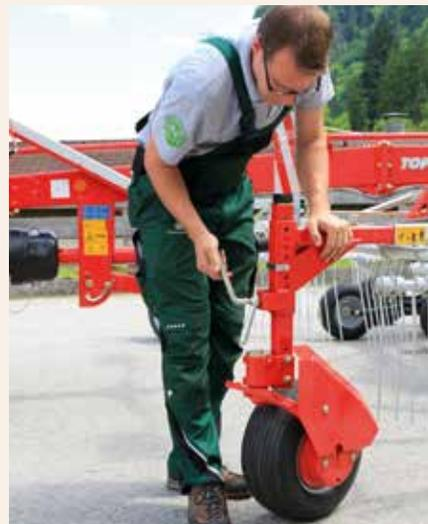
Il convient de d'abord régler la hauteur de la roue de jauge avant d'adapter la hauteur de travail du rotor dans son ensemble.
