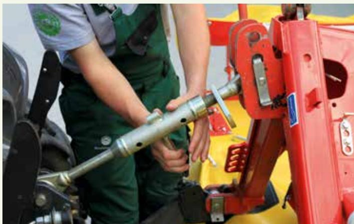
Sur une faucheuse à tambours, il faut adapter la longueur du troisième point afin que les tambours soient placés à l'horizontale. Dans ce cas, la hauteur de coupe ne peut pas être réglée à l'aide du troisième point afin d'éviter les 'vagues' lors de la fauche.
