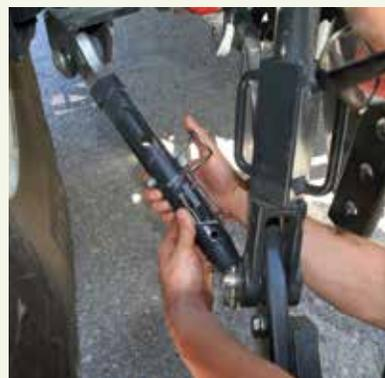
Les deux bras de relevage doivent d'abord être centrés à l'aide des stabilisateurs latéraux avant d'être bloqués.
