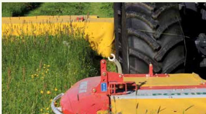
Le chevauchement entre la faucheuse avant et arrière (minimum 10 à 15 cm) doit être réglé en fonction de la largeur de voie et de la largeur de travail des deux faucheuses afin d'éviter que des traces d'herbe ne soient pas fauchées.
