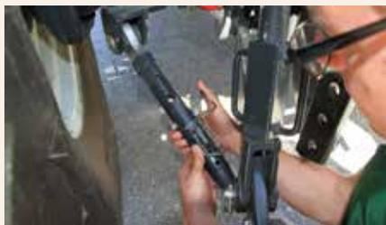
Comme pour la faucheuse, le châssis de la faneuse doit également être rigidifié via les bras de relevage du tracteur.
