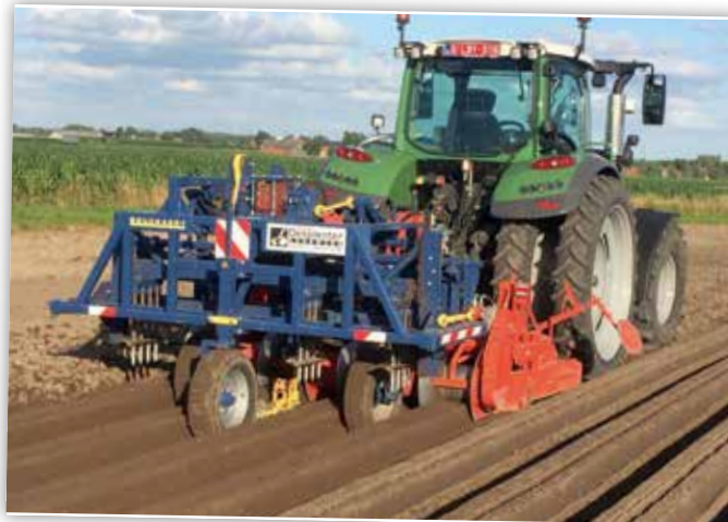
Om ruggen te trekken en te ponsen beschikt Stefaan over drie identieke combinaties. De tractor is uitgerust met dubbele cultuurwielen achteraan.
