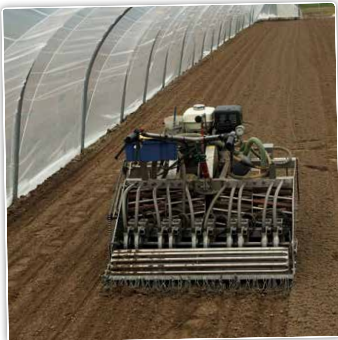
Het zaaien in de serres met een motoculteur uitgerust met een precisiezaaimachine
