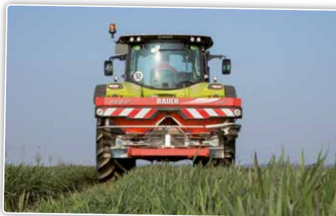
Radarsensoren meten bij Rauch en Amazone de uitgestrooide kunstmesthoeveelheid.
