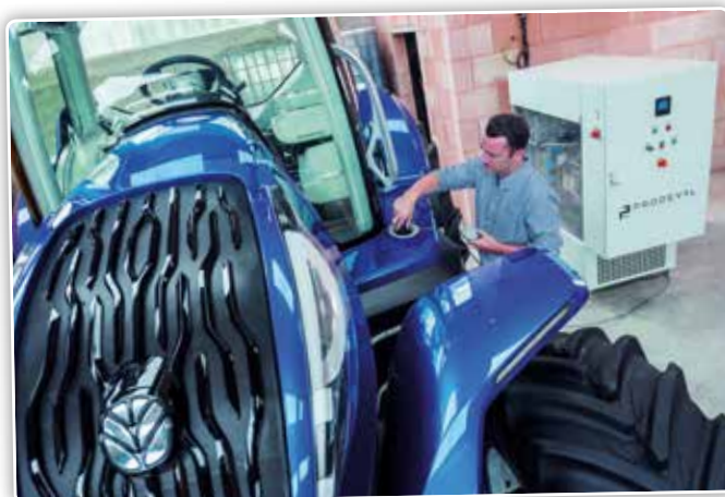
Een motor die op methaan draait, heeft een grotere tank nodig. De reden ligt in de lagere energiedichtheid van methaan tegenover die van gewone dieselbrandstof.
