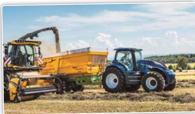
Voor het eerst werden verschillende motorenconcepten op methaanbrandstof in grote trekkers op hun praktische uitvoerbaarheid getest.
