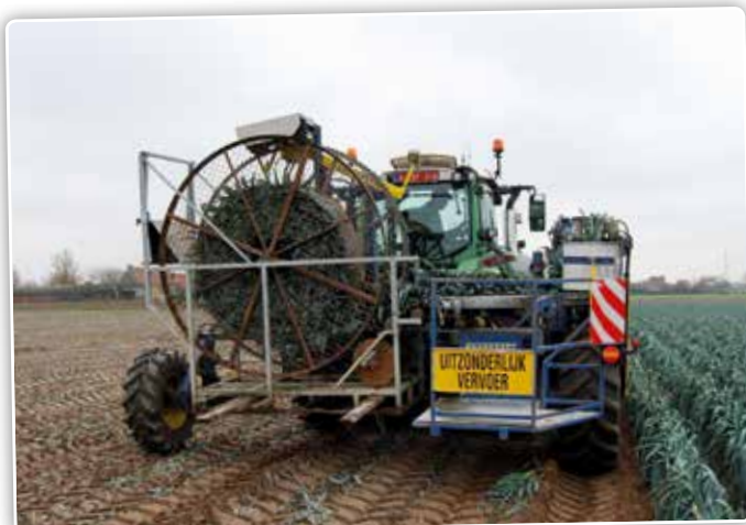
Tegenwoordig wordt ongeveer een derde van de oppervlakte volautomatisch gerooid, met rollen.
