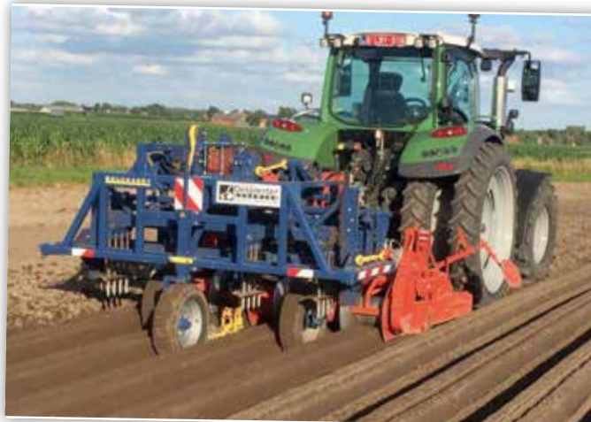
Pour le buttage et la réalisation de trous de repiquage, Stefaan dispose de trois combinaisons identiques. Le tracteur est équipé de roues étroites jumelées à l'arrière.
