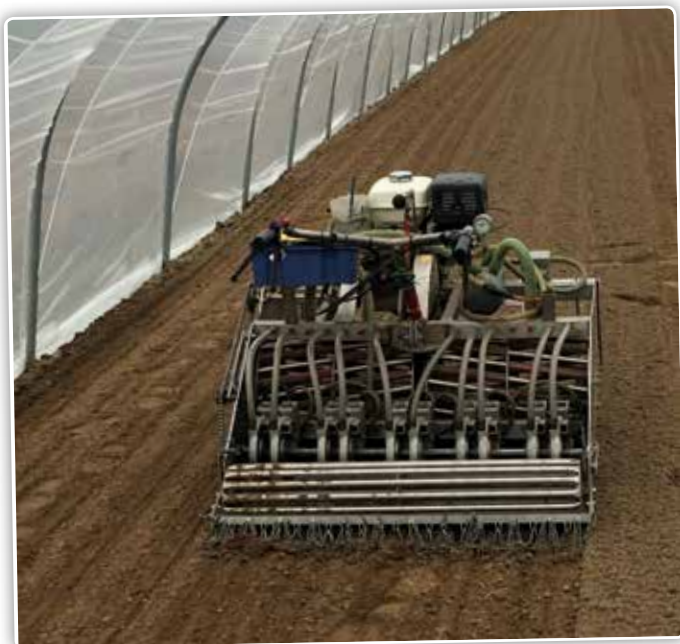
Le semis en serres à l'aide d'un motoculteur spécifique doté d'un semoir de précision.
