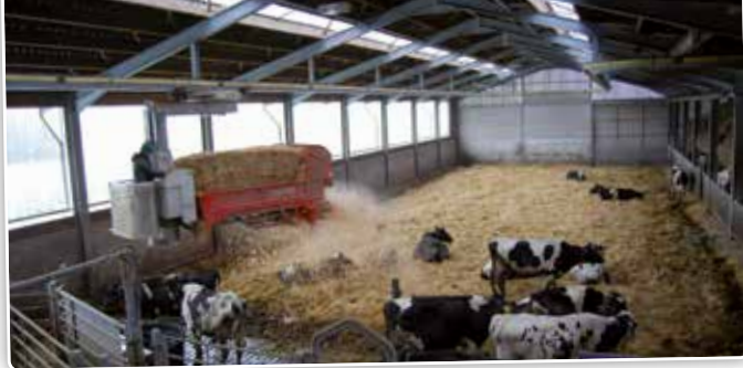
La facilité de travail est au centre des attentions: en plus du robot de traite, Jean-Marie a investi dans une pailleuse montée sur un rail.
