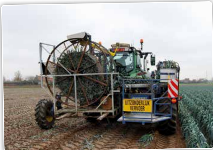
A l'heure actuelle, environ un tiers des surfaces est arraché de manière entièrement automatique, avec ces enrouleurs.
