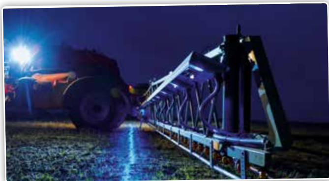
Grâce aux capteurs fluorescents, les doses de bouillie peuvent être fortement réduites.
