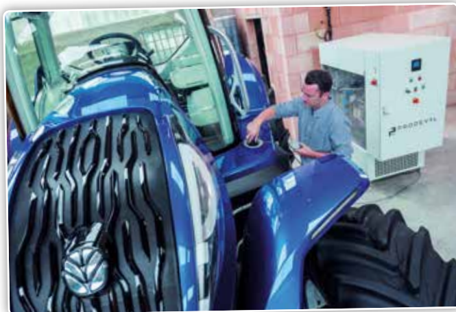
Un moteur qui tourne au méthane a besoin d'un réservoir de capacité plus importante. La densité énergétique du méthane est en effet moins importante que celle du diesel.
