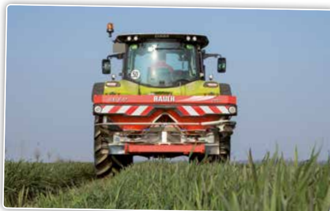
Les capteurs radar permettent de mesurer la quantité d'engrais épandue chez Rauch et Amazone.
