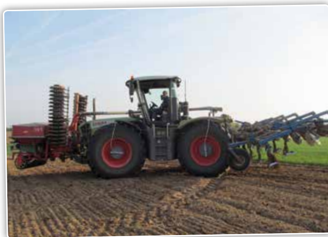
Hubert Colsoul est le spécialiste du travail sur les terres. Ici, il s'occupe d'incorporer du fumier à l'aide d'un cultivateur. Le guidage par gps facilite les choses.
