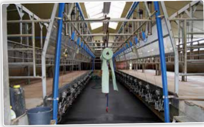
La salle de traite est une 2 x 16 côte-à-côte avec sortie rapide.
