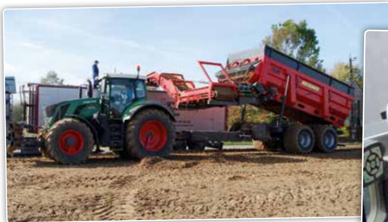
Au travail, la trémie est relevée et l'unité de nettoyage est placée à hauteur de l'opérateur.
