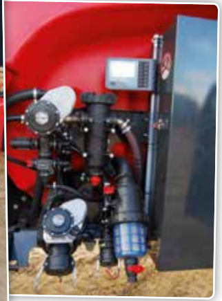
Les vannes EasySet sont agencées de manière assez logique et réduisent de ce fait le risque de mauvaises manipulations. Grâce au grand filtre d'aspiration transparent, l'encrassement est visible depuis l'extérieur.
