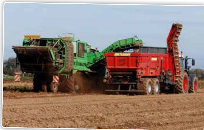
La capacité de chargement de 22 tonnes correspond à 3 trémies pleines d'une arracheuse 4 rangs AVR.
