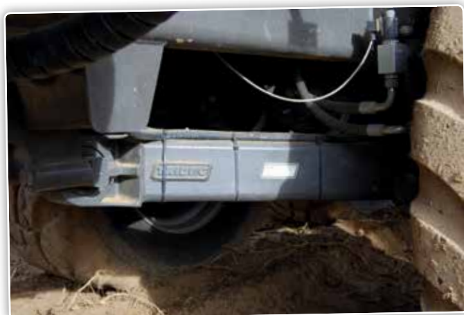
Le constructeur a fait appel à des composants éprouvés, comme la suspension Tridex HDO avec mise à niveau automatique.
