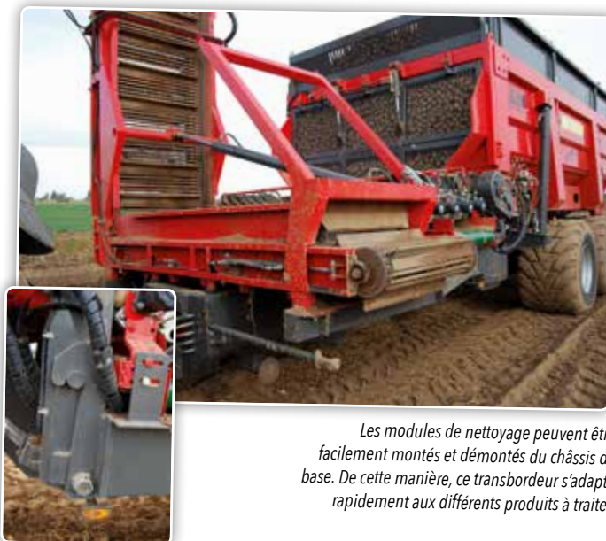
Les temps de mise en oeuvre restent limités vu que l'ensemble est monté sur un train roulant. La combinaison se déplace jusqu'à l'endroit où le produit sera nettoyé et transbordé.
