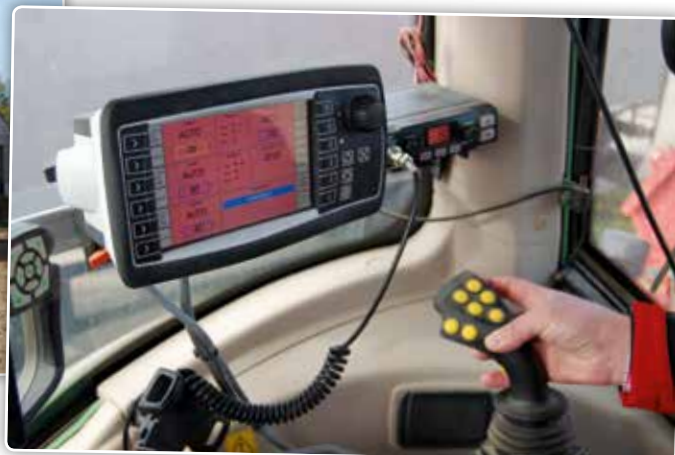
Le Multiloader est géré via une commande Can-bus avec un écran de 7 pouces et un joystick multifonctionnel avec fonction start/stop automatique.
