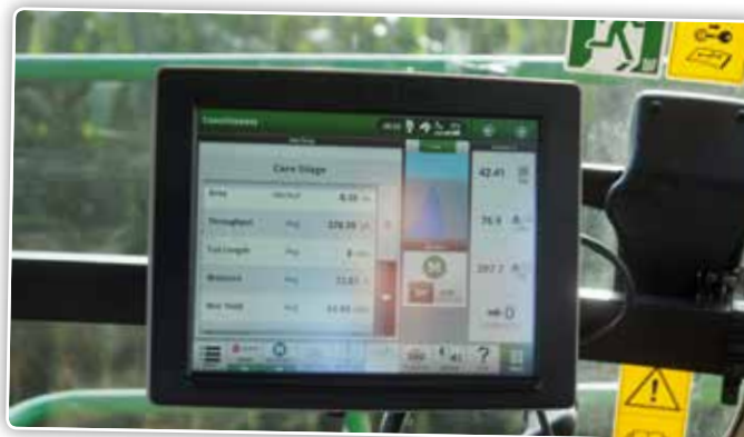
Un écran tactile de 13 pouces permet de visualiser clairement les réglages.
