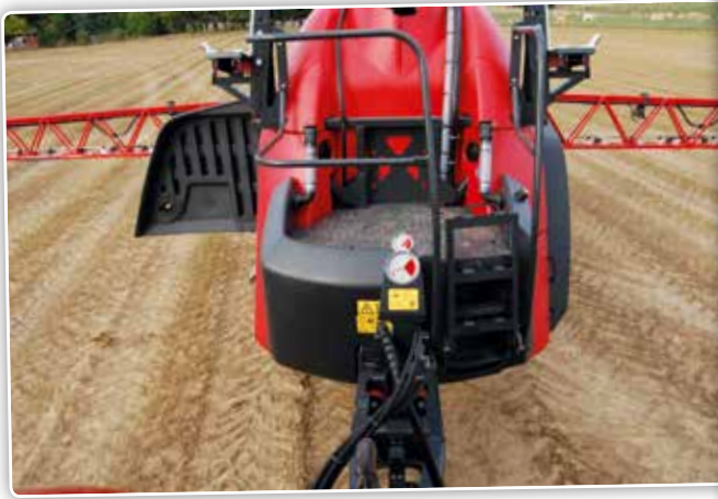
Le manomètre pour la pression de pulvérisation se trouve à présent au-dessus du timon, dans le champ de vision de l'opérateur.
