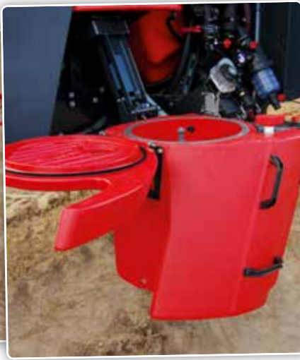
Au remplissage, le couvercle de l'incorporeur fait office de table de travail.
