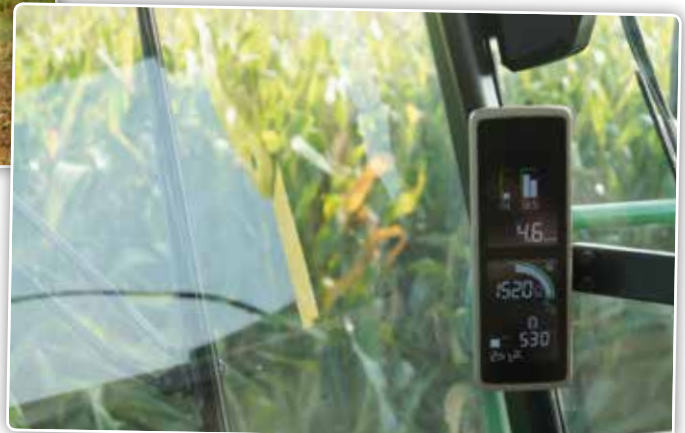
Un écran sur le montant de la cabine indique le régime moteur et la vitesse.
