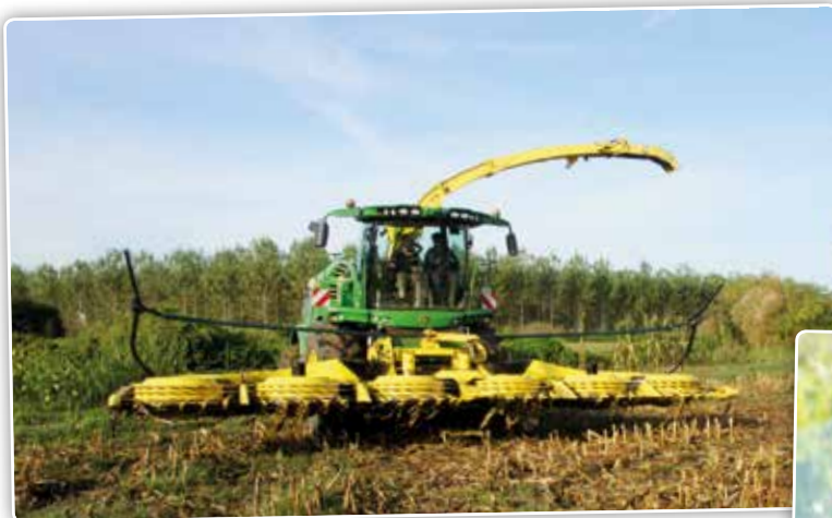
Le bec Kemper a été spécialement développé afin d'utiliser au mieux la capacité supérieure de ces nouvelles ensileuses.
