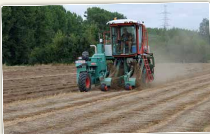
Les retourneuses doubles automotrices sont dotées d'un système breveté de transfert en continu de la récolte
