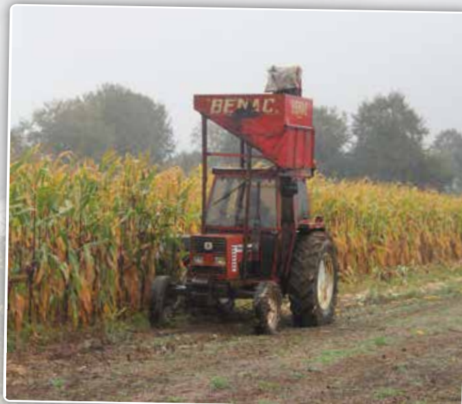
Une machine différente des autres: une cueilleuse d'épis de maïs monorang de marque Benac.
