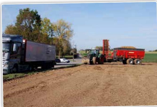
Les temps de mise en oeuvre restent limités vu que l'ensemble est monté sur un train roulant. La combinaison se déplace jusqu'à l'endroit où le produit sera nettoyé et transbordé.
